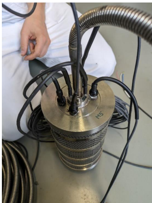
Obr. 6 Korozní modul s instalovanými čidly a topidlem
