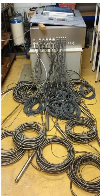
Obr. 20 Testování topných patron a systému regulace v laboratoři ÚJV
