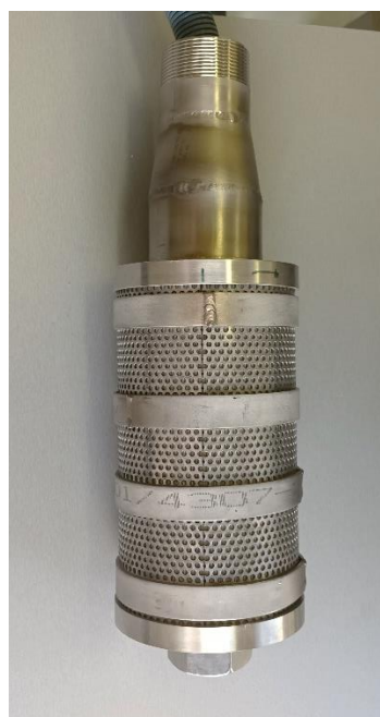
Obr. 7 Svařování korozního modulu, (vpravo) zavařený modul
