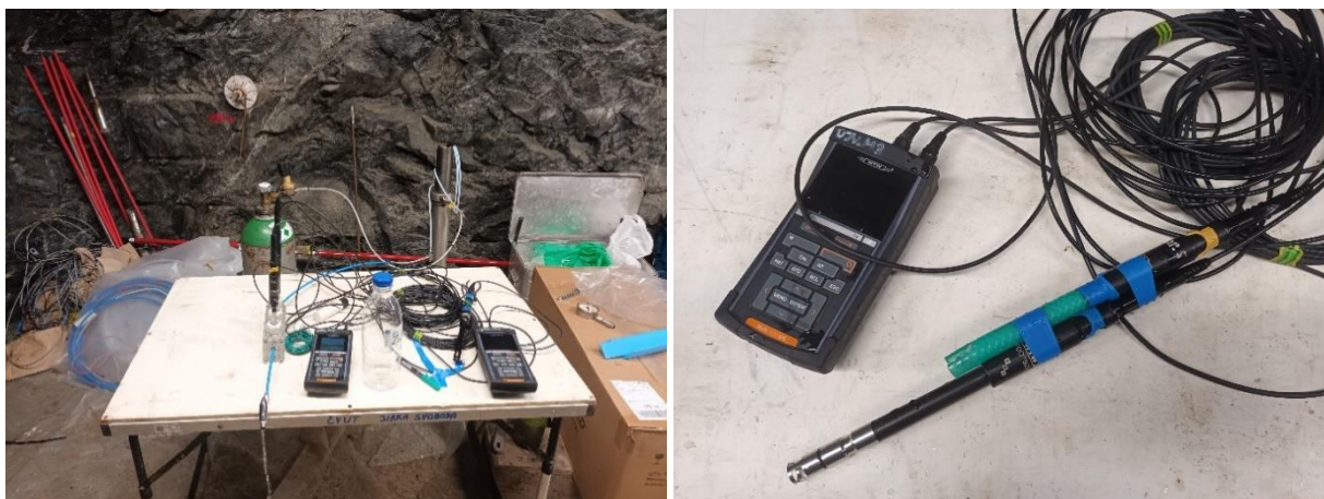
Obr. 10 WTW měřicí systém pro monitoring hydrochemických parametrů v průtočné cele anebo přímo ve vrtu (možné zapuštění středem pakru)
