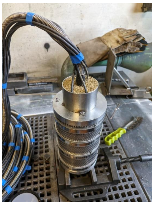
Obr. 7 Svařování korozního modulu, (vpravo) zavařený modul
