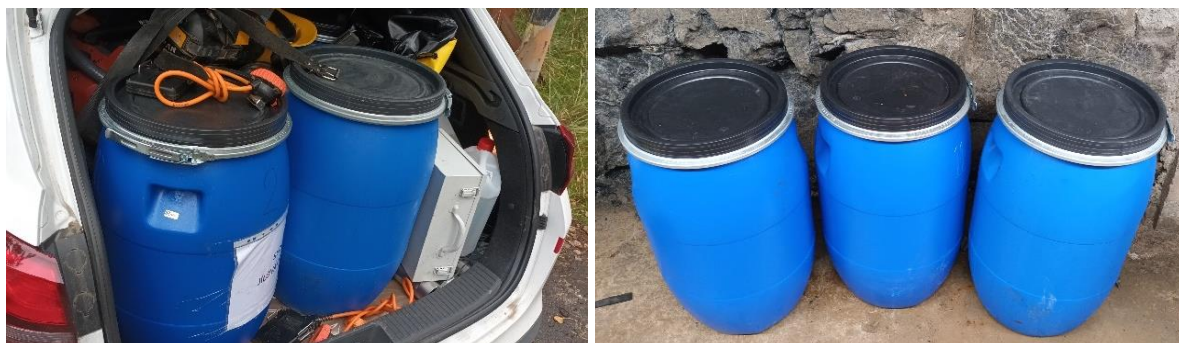
Obr. 13 Transport modulů do podzemní laboratoře PVP Bukov za přetlaku argonu
