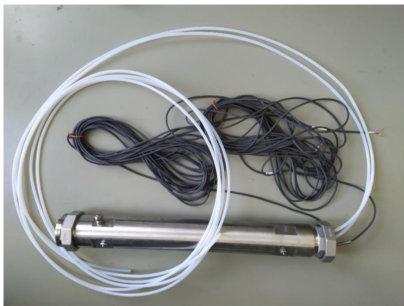
Obr. 9 Vzorkovač vody s nainstalovanými teplotními čidly a vzorkovacími hadicemi
