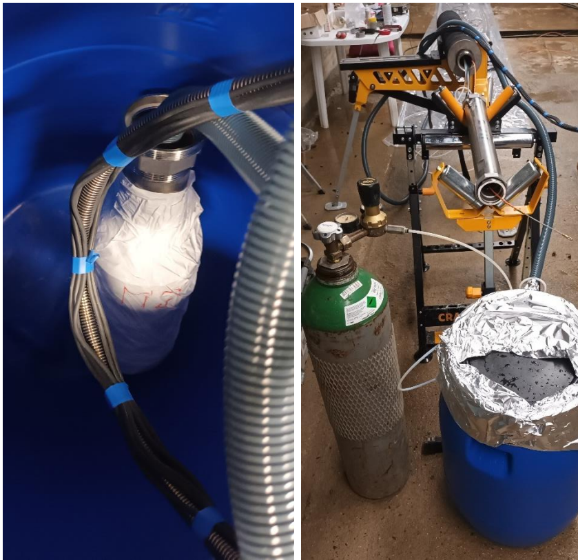
Obr. 15 Korozní modul při instalaci na vzorkovač podzemní vody (umístění modulu v transportním sudu)
