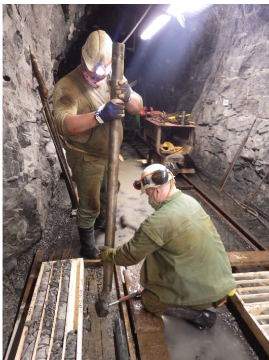
Obr. 6 Vrtné práce – rovnání jádra do jádrovnic
