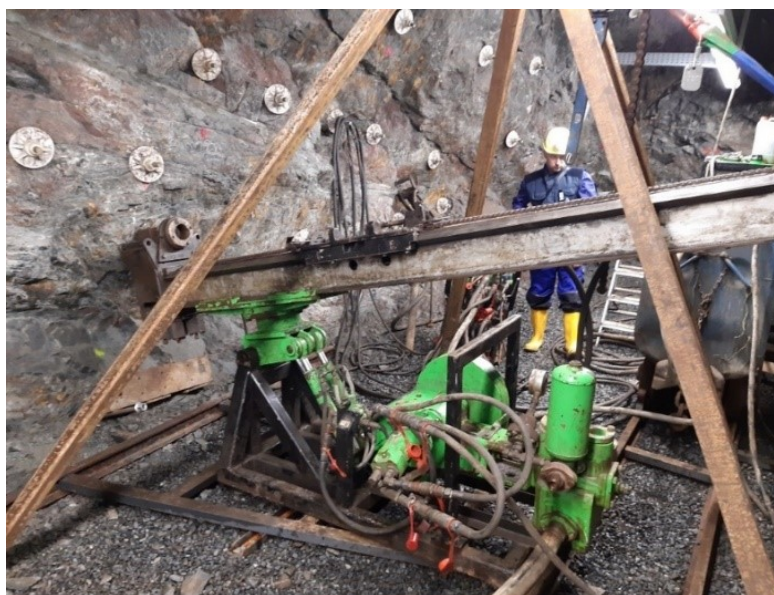
Obr. 4 Příprava chodby ZK-2, instalace kolejí Obr. 5 Instalace vrtné soupravy v komoře ZK-2
