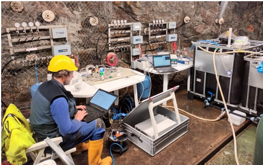
Obr. 51 Stanoviště v ZK-2 při stopovací zkoušce
