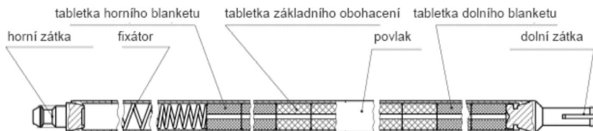
Obr. 43: Schéma palivového proutku
