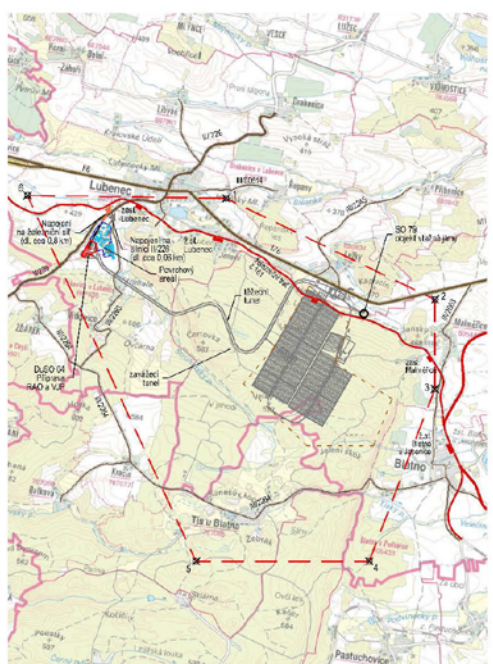
Dispoziční řešení D3 - horizontální ukládání, ražba TBM
