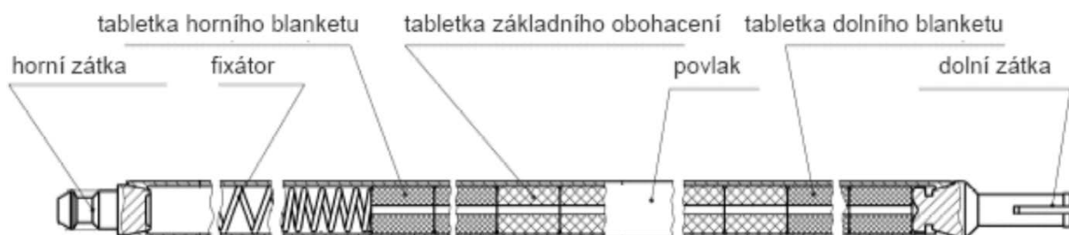
Obr. 42: Schéma palivového proutku
