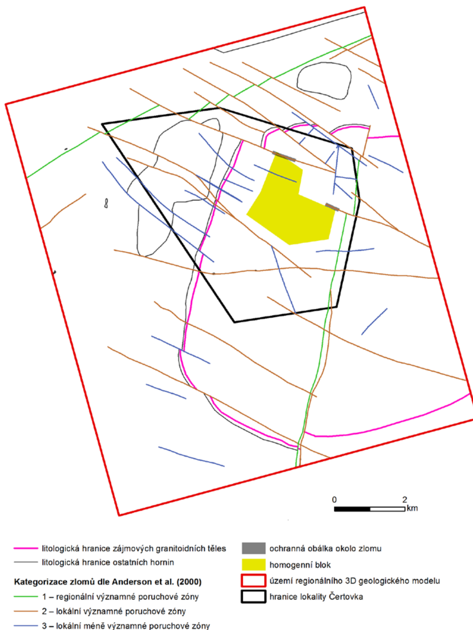
Obr. 2: Horizontální řez detailním 3D strukturně geologickým modelem lokality Čertovka na úrovni cca 500 m hloubky a lokalizace předpokládaných homogenních bloků
