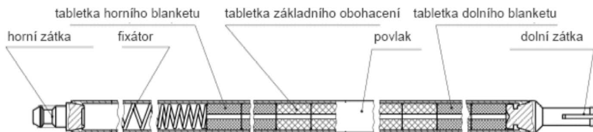
Obr. 35: Schéma palivového proutku
