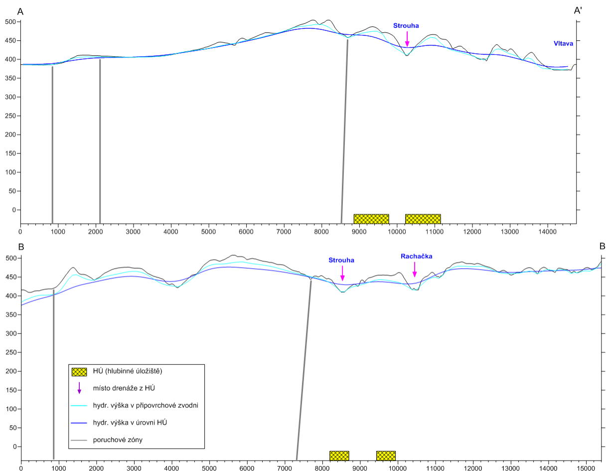
Obr. 12: Schématické řezy se znázorněním horizontální a vertikální vzdálenosti drenáže podzemní vody z prostoru projektovaného HÚ (fialové šipky) a homogenních bloků (modré šipky)
