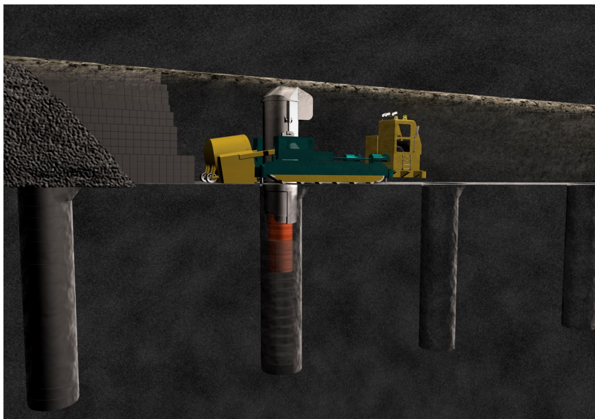
Obr. 61: Manipulace s UOS, spuštění UOS do svislého vrtu, Finsko
