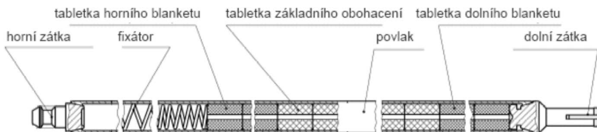
Obr. 43: Schéma palivového proutku
