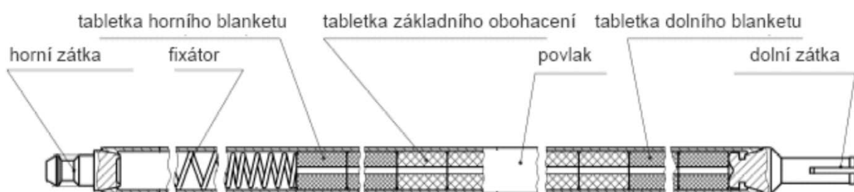
Obr. 44: Schéma palivového proutku
