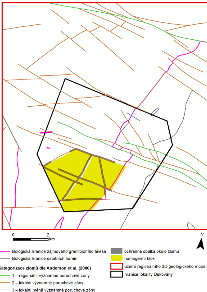
Obr. 2: Horizontální řez detailním 3D strukturně geologickým modelem lokality Na Skalním na úrovni cca 500 m hloubky (tj. cca 0 m n. m.) a lokalizace předpokládaných homogenních bloků.
