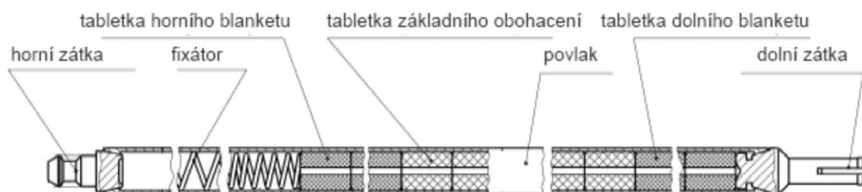
Obr. 36: Schéma palivového proutku
