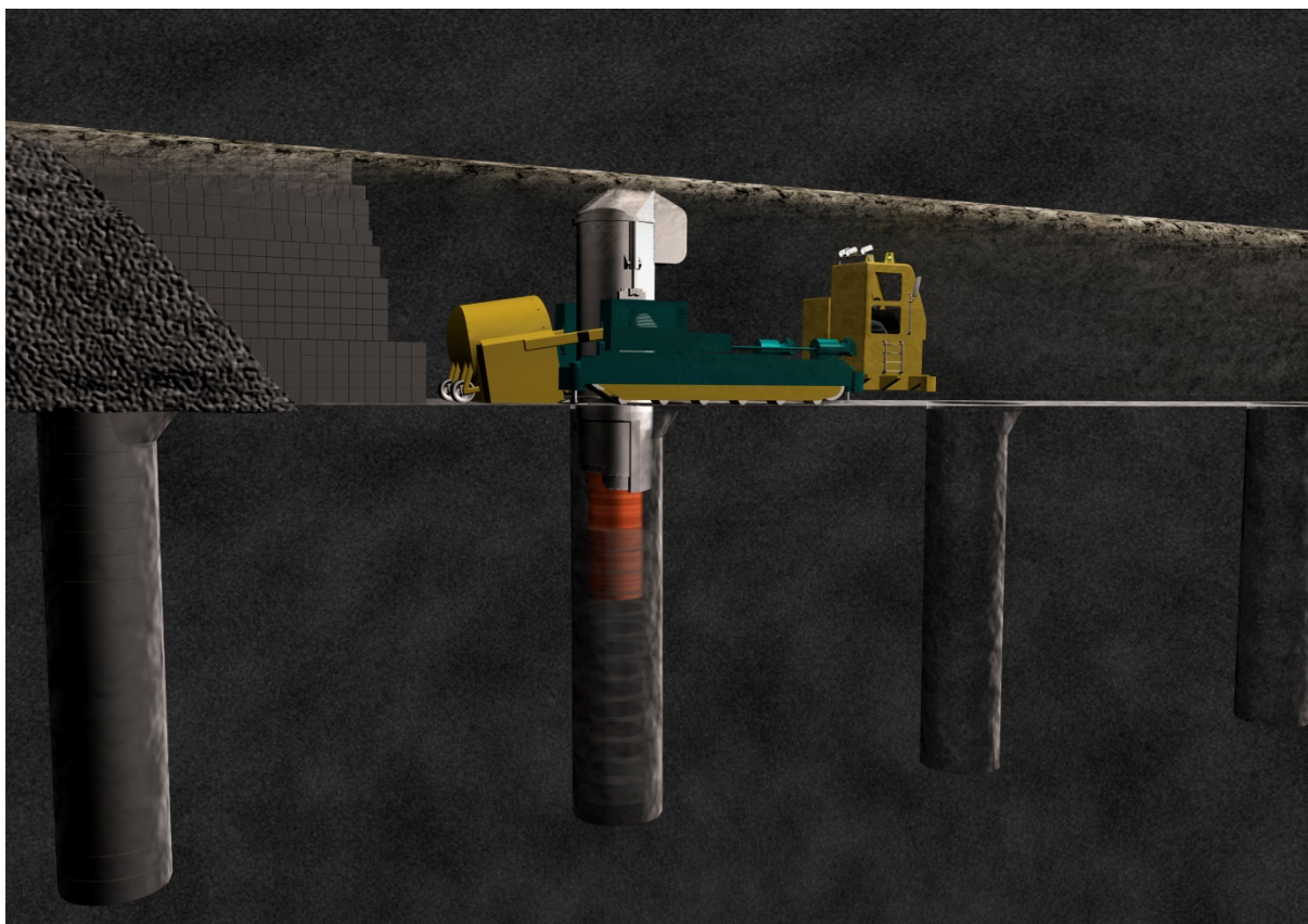
Obr. 54: Manipulace s UOS, spouštění UOS do svislého vrtu, Finsko
