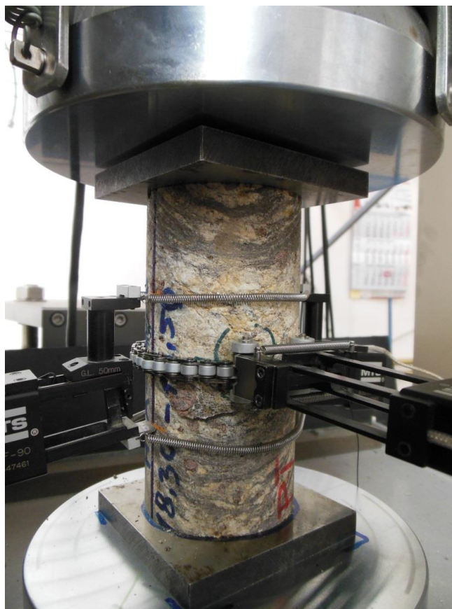
Obr. 2 Horninový vzorek při jednoosé zkoušce osazený dvěma extenzometry relativní podélné deformace a extenzometrem měřícím relativní příčnou deformaci.
