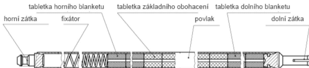
Obr. 44: Schéma palivového proutku
