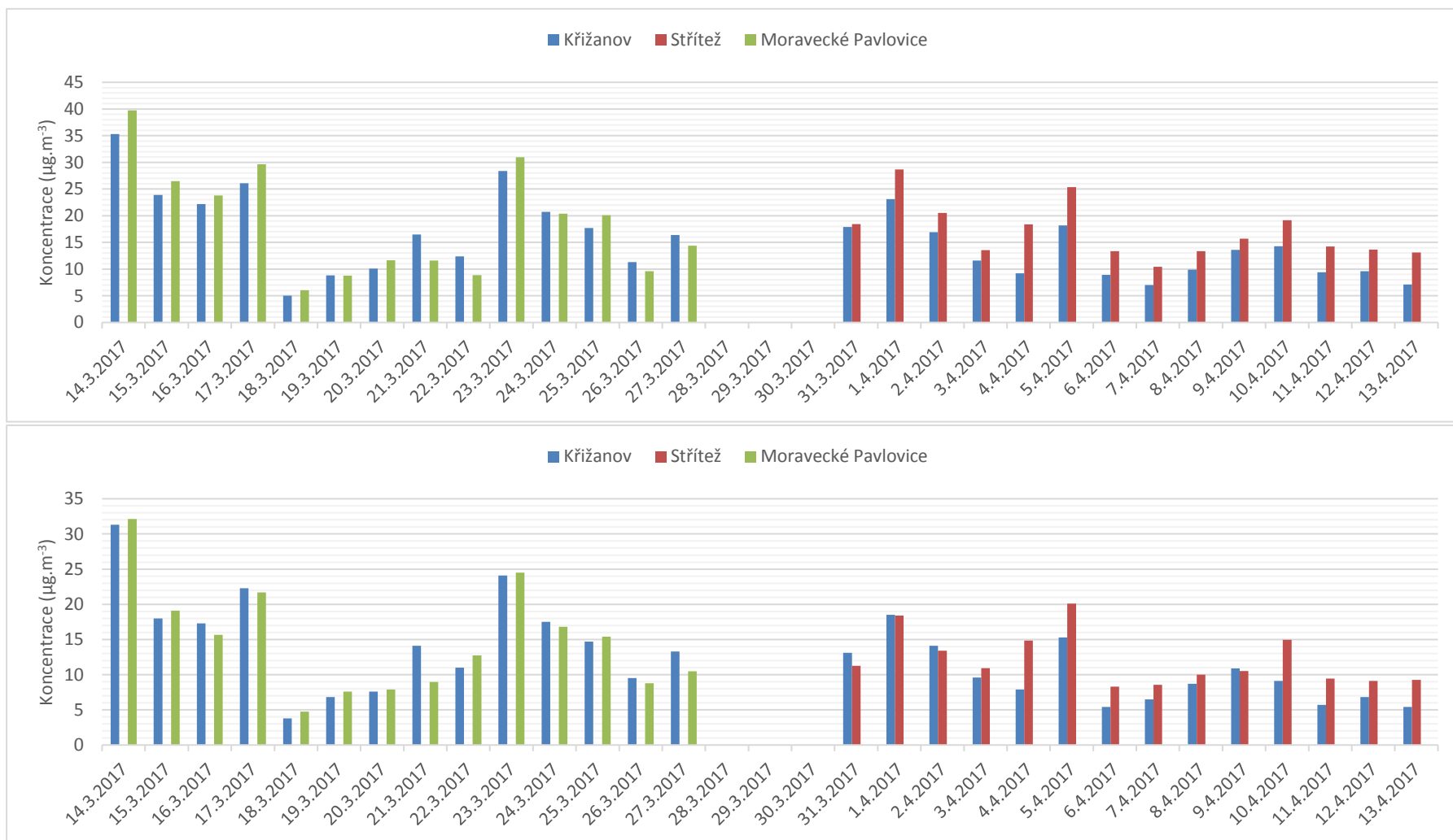
Obr. 22 - Průměrné denní koncentrace suspendovaných částic PM_{10} (nahore) a PM_{2.5} (dole) v lokalitách Křižanov, Střítež a Moravecké Pavlovice
