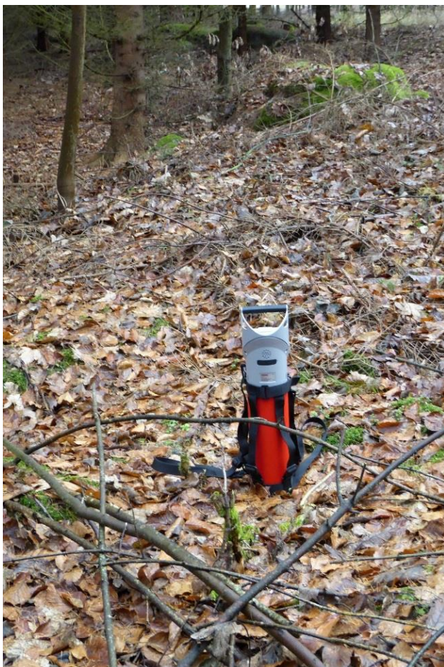
Obr. 20 In-situ spektrometrie záření gama v místě radiometrických anomálií ( 2\pi geometrie měření)
