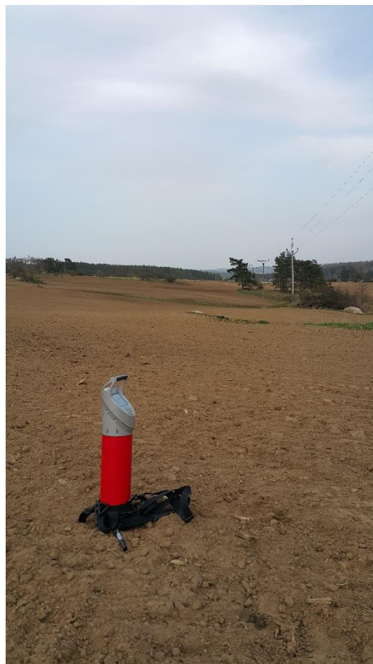
Obr. 20 In-situ spektrometrie záření gama v místě radiometrických anomálií ( 2\pi geometrie měření)
