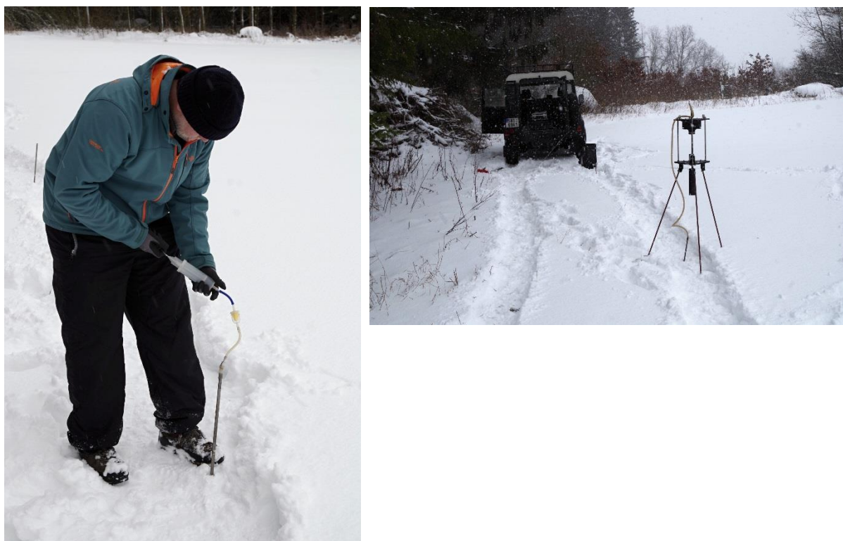
Obr. 21 Odběry vzorků půdního vzduchu a přímé měření plynopropustnosti zemin
