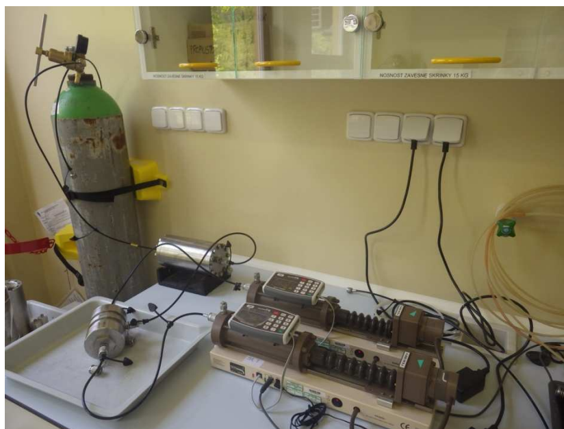
Obr. 165 Aparatura pro měření součinitele filtrace (ÚJV Rež, a. s.)
