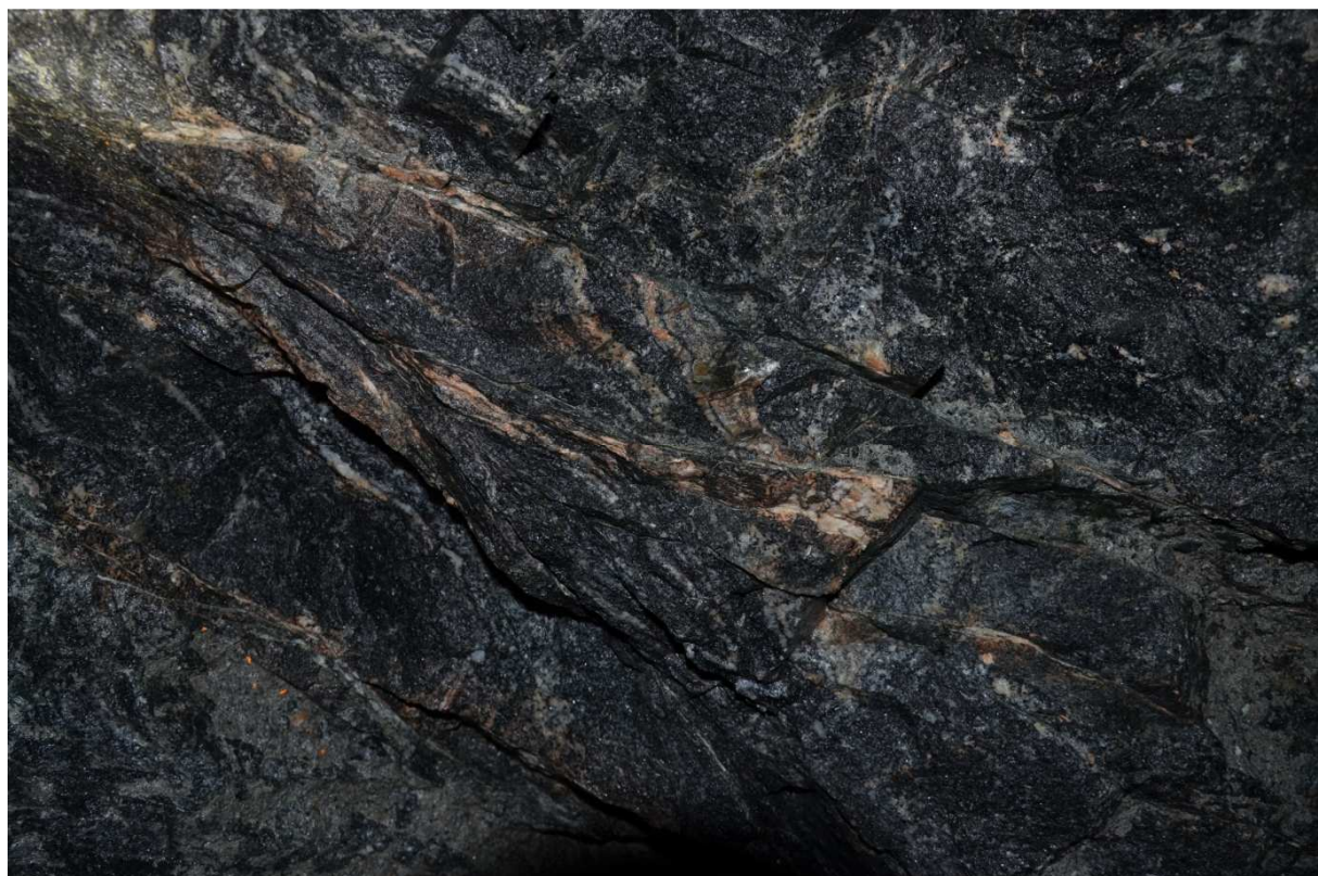
Obr. 55 Střížné zóny v poruše na metrži 69-70 m (BZ 1 -XII, jižní stěna, spodní hrana fotky 40 cm)
