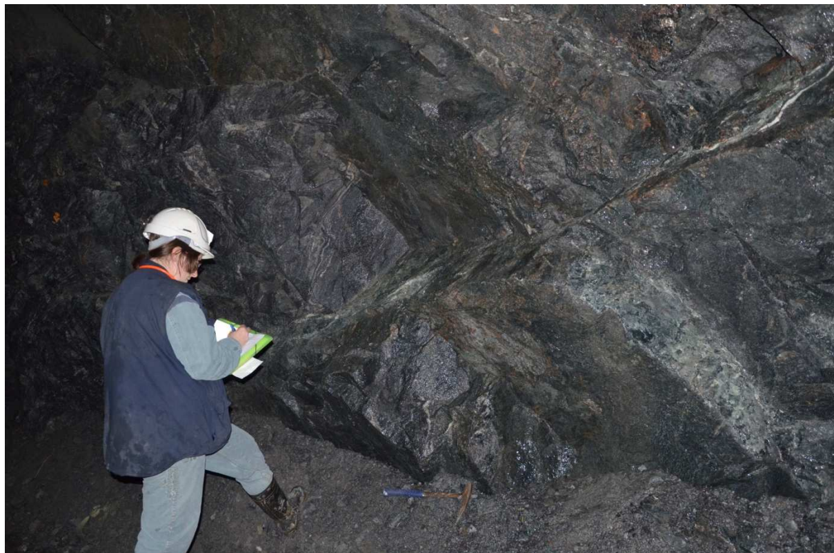
Obr. 48 Zlomová struktura ~SV–JZ průběhu s minerální výplní (překop BZ1-XII, metráž 74 m, severní stěna)
