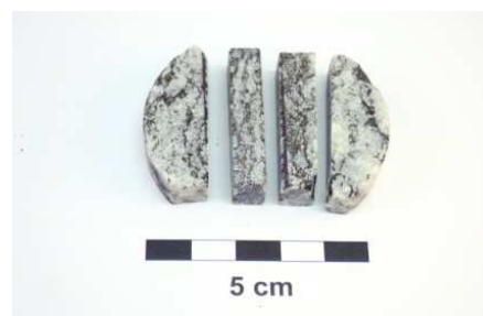
Obr. 170 Příprava vzorků na rtuťovou porozimetrii
