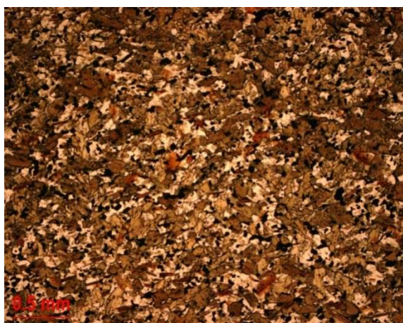
Obr. 12 Biotitický amfibolit světlá zrna plagioklasu jsou obklopena biotitem a amfibolem, PPL
