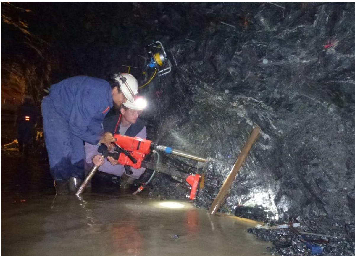
Obr. 57 Odběr jádra na analýzu AMS pomocí elektrické vrtačky v rozrážce ZK-1 (jižní stěna)
