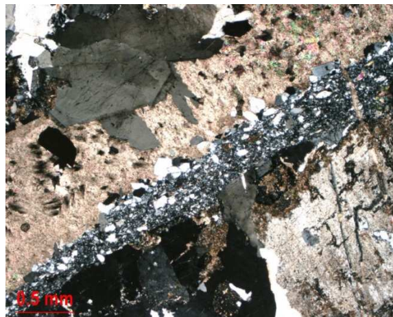
Obr. 18 Hydrotermální žíla v migmatitu. Střední část žíly tvoří kalcit a okraj jsou pak budovány křemenem a albitem, XPL
