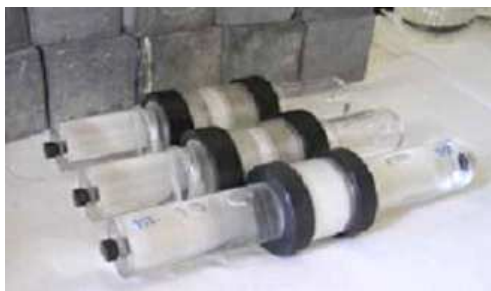
Obr. 158: Difúzní cely pro průnikové difúzní experimenty: vlevo původní design (2006), vpravo upravený design (ÚJV Řež, a. s. 2009)
