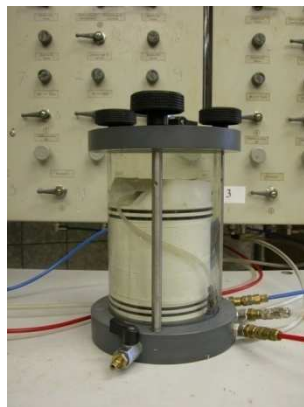
Obr. 168 Měřící komora s udržováním plášťového tlaku (0-0,6 MPa)
