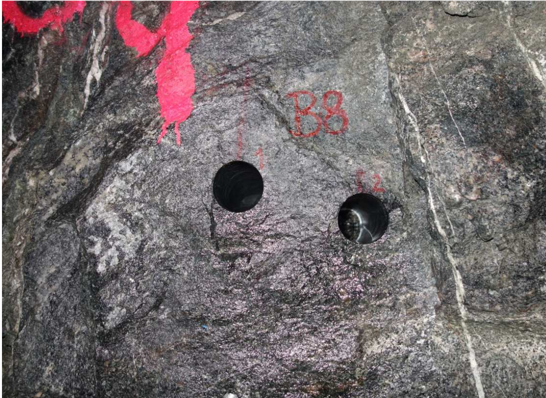
Obr. 58 Horninový masiv po odběru jádra B8 (B8_1 a B8_2) v rozrážce BZ1-XII
