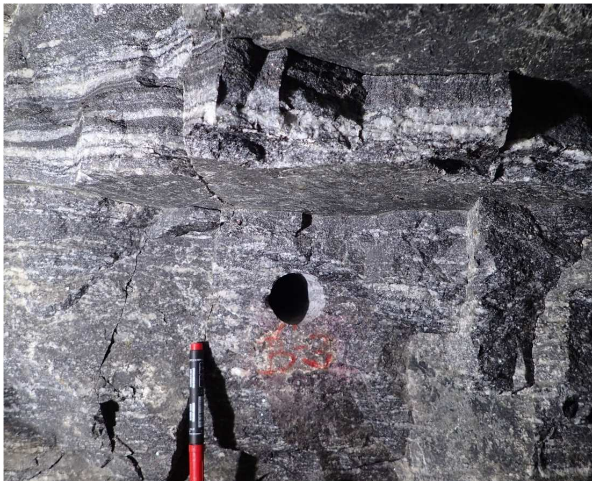
Obr. 61 Příklad místa odběru orientovaného vzorku EB3 pro analýzu EBSD u původního odběru jádra B3
