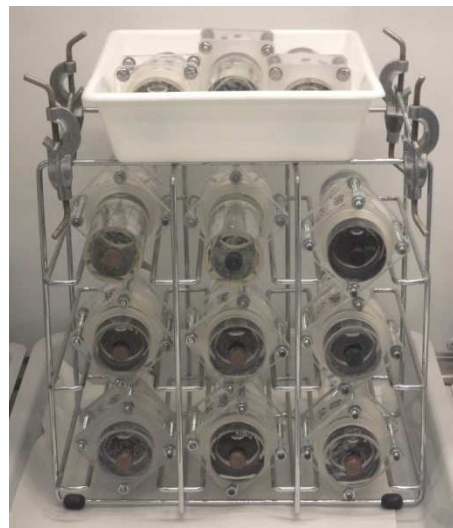
Obr. 159 Difúzní cela pro průnikové difúzní experimenty s malým cílovým rezervoárem; uložení části difúzních cel během experimentu (ÚJV 2016)
