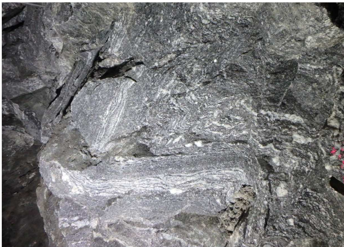
Obr. 45 Vrásová struktura (ZK-1, severní stěna, spodní hrana fotky cca 20 cm)
