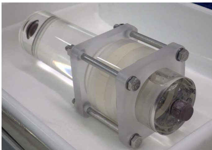
Obr. 159 Difúzní cela pro průnikové difúzní experimenty s malým cílovým rezervoárem; uložení části difúzních cel během experimentu (ÚJV 2016)
