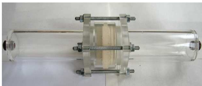
Obr. 158: Difúzní cely pro průnikové difúzní experimenty: vlevo původní design (2006), vpravo upravený design (ÚJV Řež, a. s. 2009)
