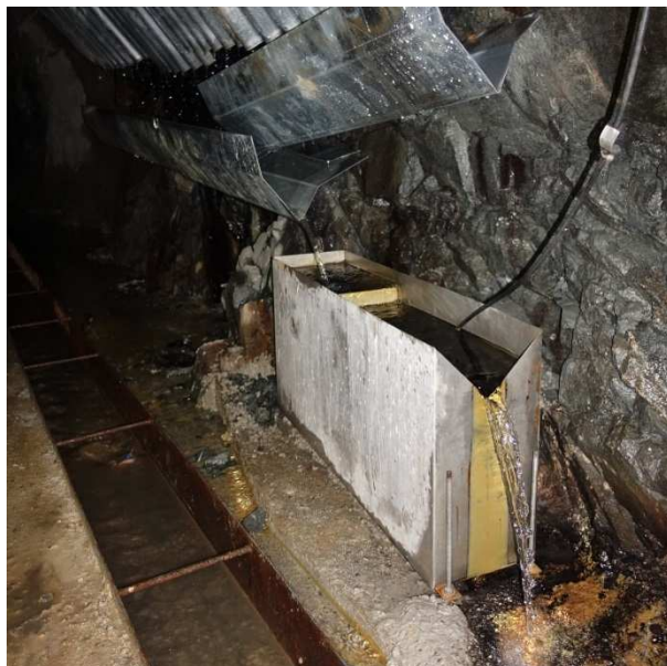
Obr. 130 Osazení monitorovaného přítoku BK06
