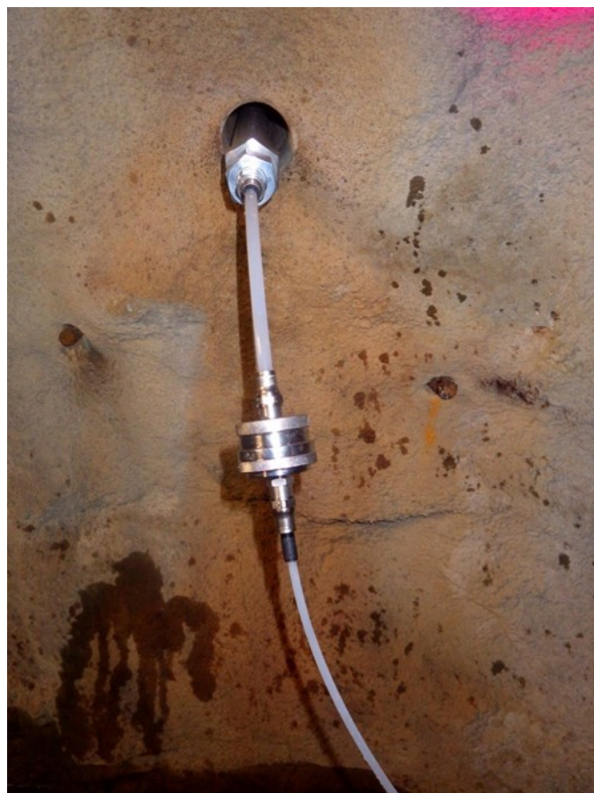
Obr. 7 Připojení vzorkovače PTFE hadičkami
