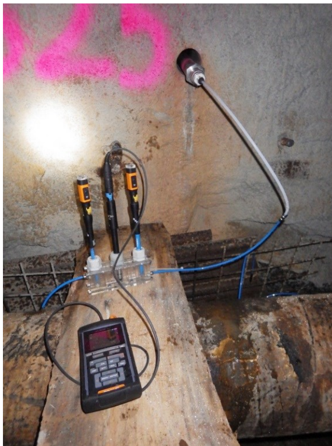
Obr. 10 Měření základních hydrochemických parametrů (teplota, pH, ORP, O 2 ) v průtočné cele
