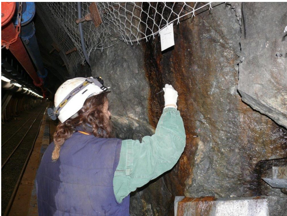
Obr. 4 Odběr mikrobiálních nárůstů pomocí jednorázových sterilních stěrek
