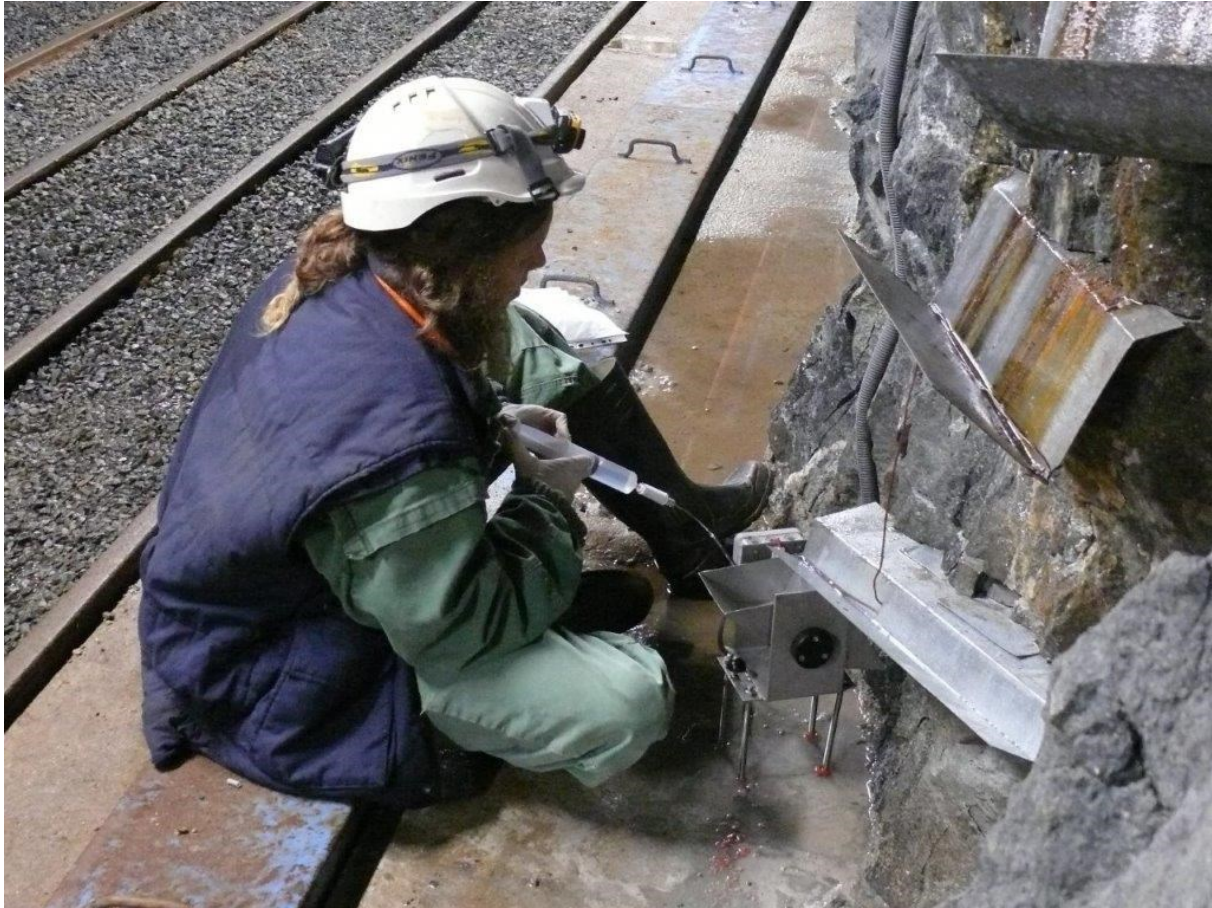
Obr. 2 Filtrování vody filtrem Sterivex
