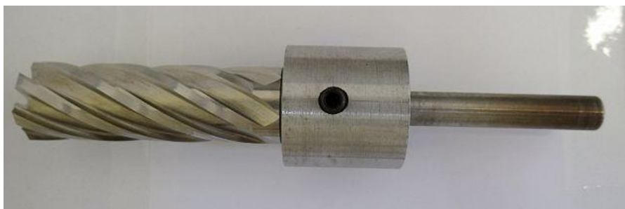
Obr. 2 Malá vrtná korunka (materiál: nástrojová korozivzdorná ocel) / Small core drill bit (material: tool stainless steel).
