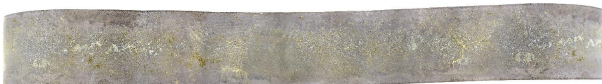
Obr. 11-132 Povrch vzorku uhlíkové oceli po dvouleté korozní zkoušce (složený obrázek z několika částí)
