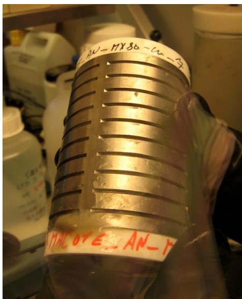
Obr. 3-20 Bentonit MX-80 mezi perforovaným vnějším košem a plastovým čelem
