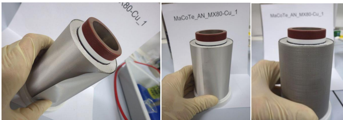
Obr. 3-11 Umístění filtračních tkanin okolo bentonitu
