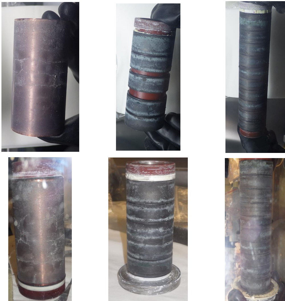
Obr. 11-5 Srovnání kovových vzorků po experimentu. Zleva měděný nástřik, uhlíková ocel v bentonitu MX-80 a uhlíková ocel v bentonitu BaM. Shora dolů roční zkouška, dvouletá zkouška, tříletá zkouška, čtyřletá zkouška
