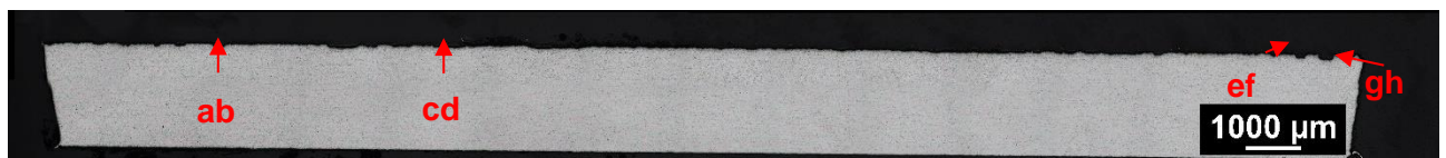
Obr. 11-160 Přehledový snímek řezu vzorku uhlíkové oceli. Písmena značí pozice následujících obrázků
