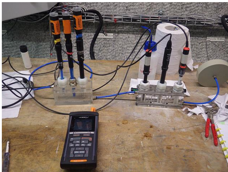
Obr. 6-11 Zapojení dvou cel pro měření pH, oxidačně redukčního potenciálu a kyslíku za „anaerobních“ podmínek po třech letech experimentu.
