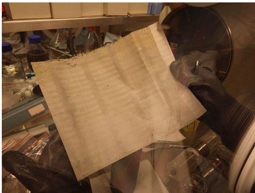
Obr. 7-7 Ilustrační obrázek šedočerného zabarvení na filtrační tkanině z modulu s bentonitem BaM
