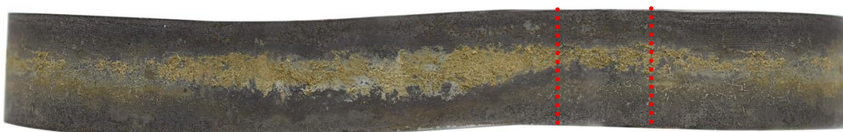
Obr. 11-150 Povrchu vzorku uhlíkové oceli (obrázek složen z několika částí). Červené čáry značí místo řezu vzorku
