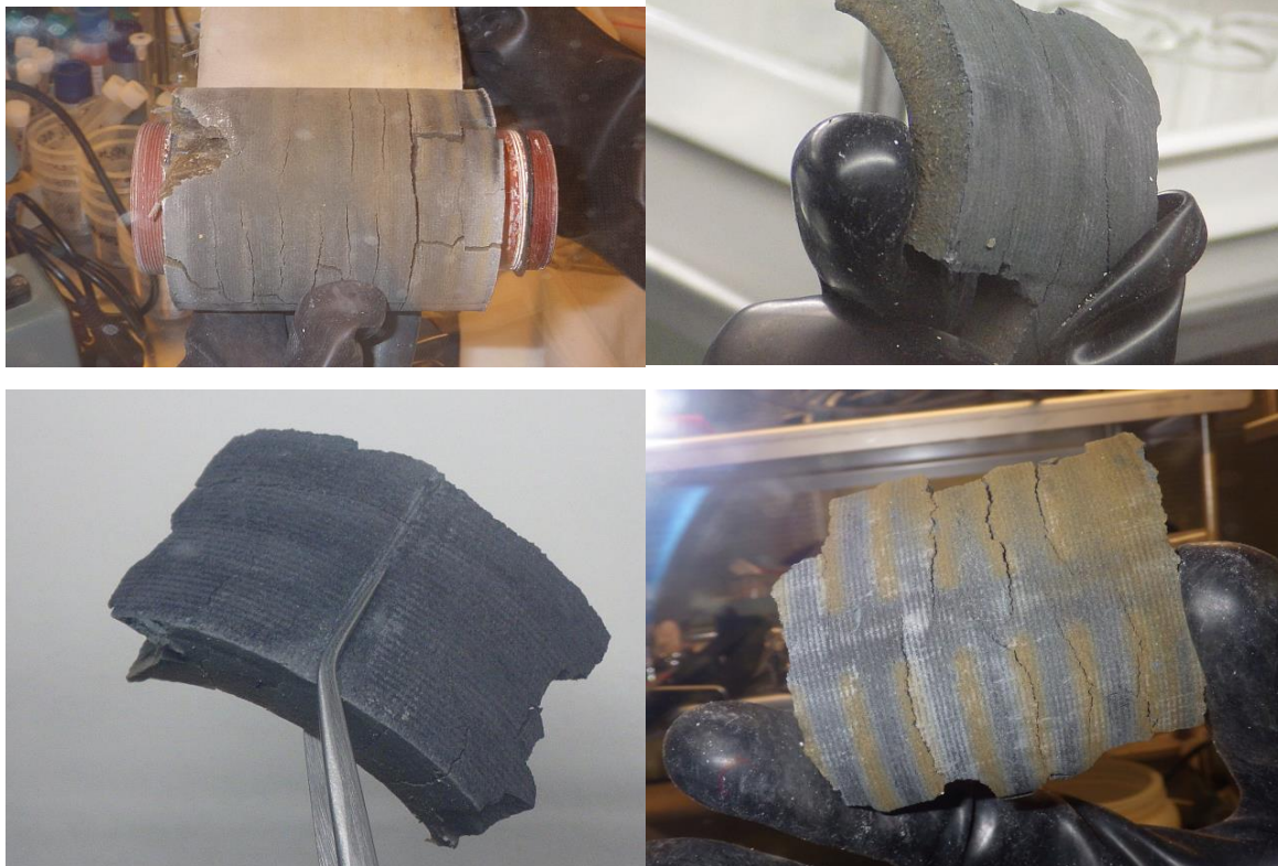
Obr. 11-2 Srovnání vnějšího povrchu bentonitu MX-80 po ročním (nahore vlevo), dvouletém (nahore vpravo), tříletém (dole vlevo) a čtyřletém (dole vpravo) experimentu s uhlíkovou ocelí
