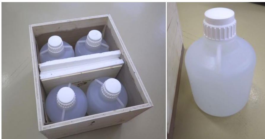
Obr. 3-14 Převážné plastové nádoby s podzemní vodou z GTS
