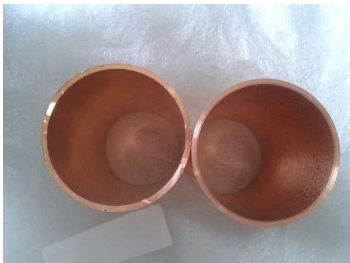
Obr. 3-7 Mechanicky poškozená strana měděných vzorků (nalevo) a nepoškozená strana (napravo)
