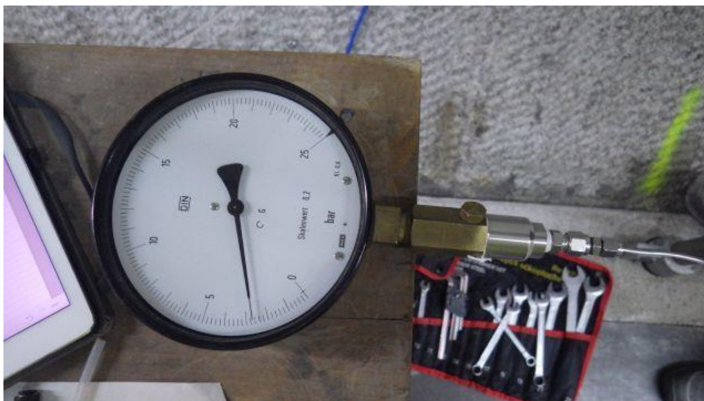
Obr. 6-1 Manometr použitý pro měření tlaku podzemní vody pod mechanickým obturátorem ve vrtu 15.001
