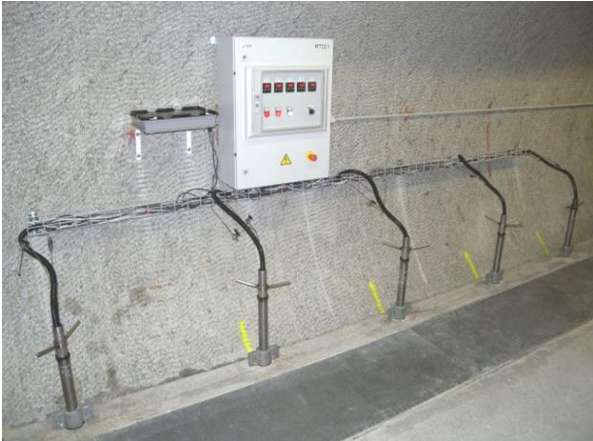
Obr. 4-3 Aparatura pro korozní zkoušky v přírodním granitoidním prostředí za zvýšené teploty (foto Nagra)
