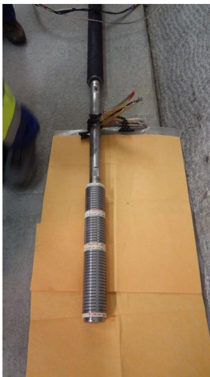
Obr. 6-6 Moduly se vzorkovačem a těsnícím elementem mechanického obturátoru
