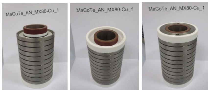
Obr. 3-12 Dokončení montáže modulu
