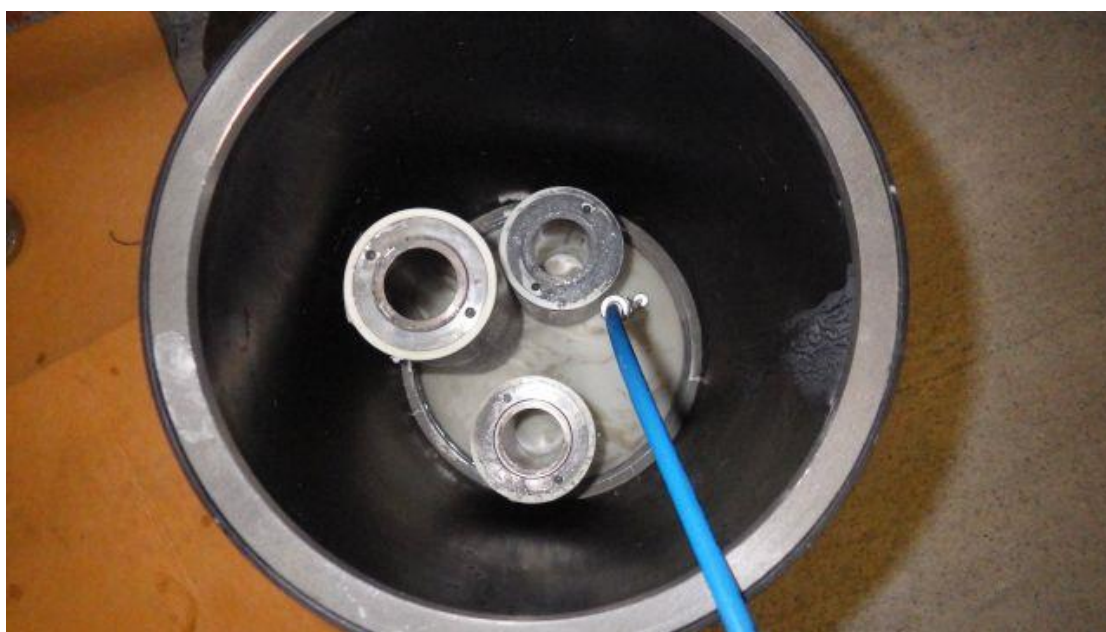
Obr. 6-7 Transportní pouzdro s moduly při proplachování argonem
