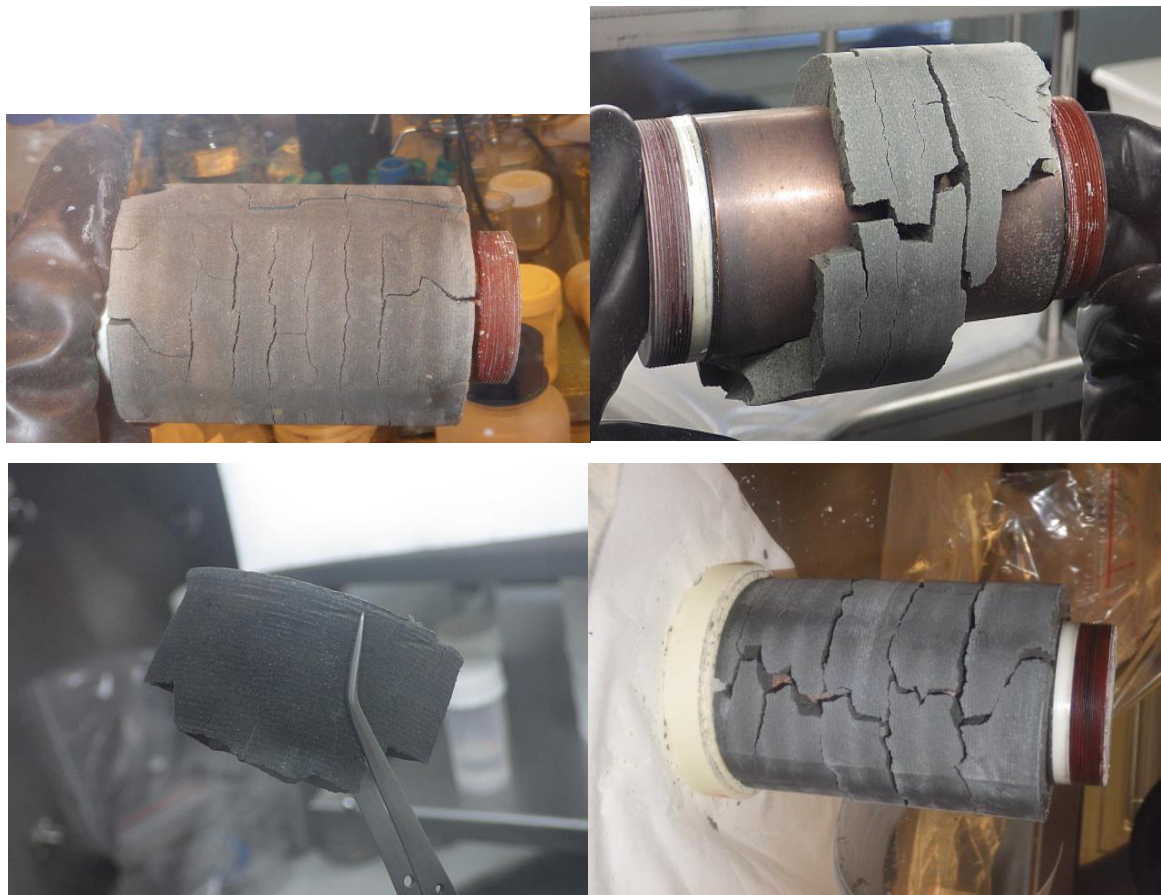
Obr. 11-1 Srovnání vnějšího povrchu bentonitu MX-80 po ročním (nahore vlevo), dvouletém (nahore vpravo), tříletém (dole vlevo) a čtyřletém (dole vpravo) experimentu s měděným nástřikem
