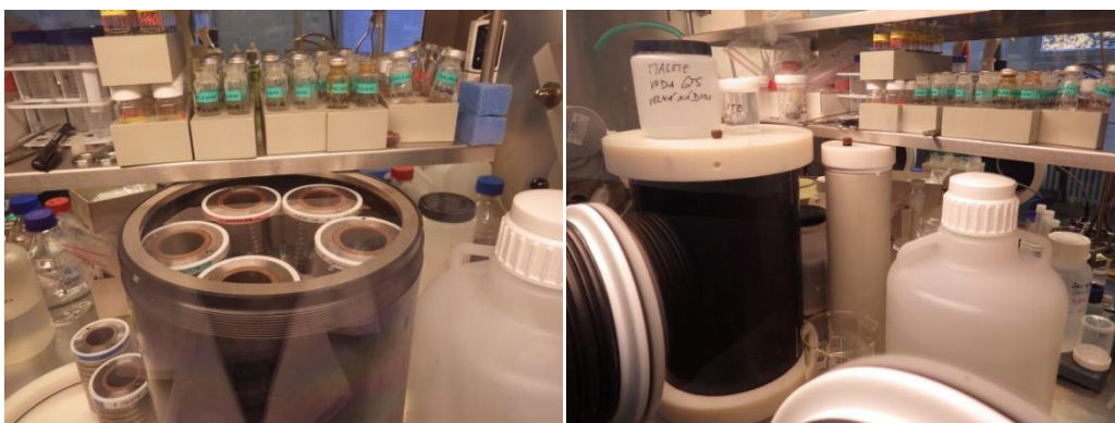
Obr. 3-15 Sycení modulů v rukavicovém boxu
