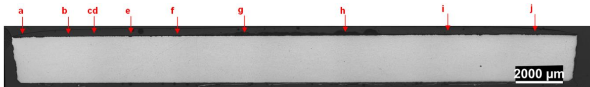
Obr. 11-124 Přehledový snímek řezu vzorku uhlíkové oceli. Písmena značí pozice následujících obrázků
