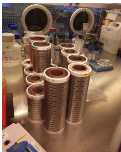
Obr. 3-13 Moduly v rukavicovém boxu s argonovou atmosférou
