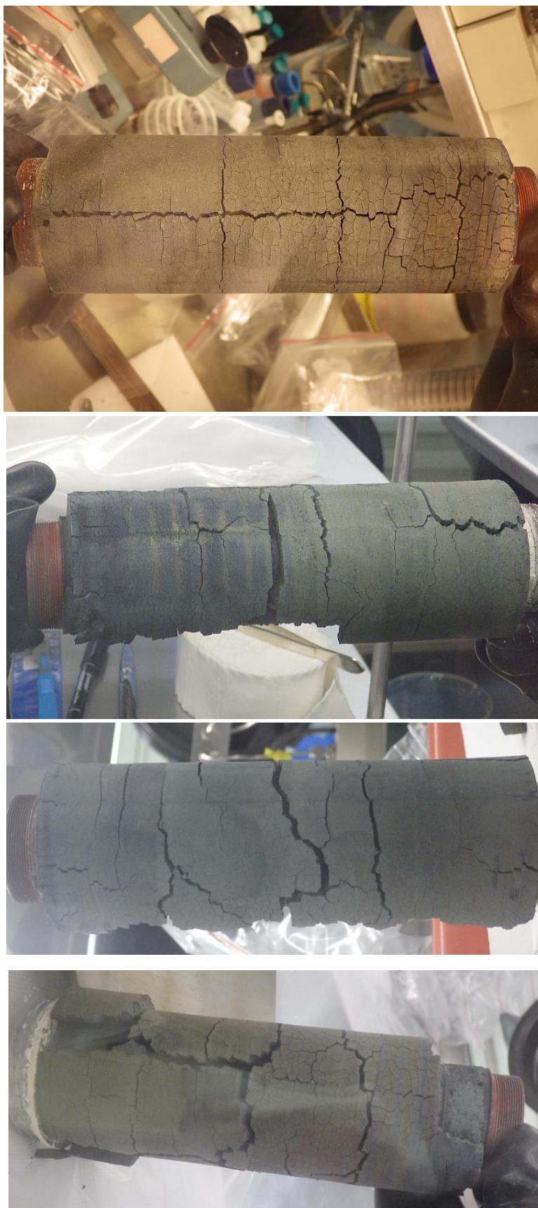
Obr. 11-3 Srovnání vnějšího povrchu bentonitu BaM po ročním, dvouletém, tříletém a čtyřletém (od shora dolů) experimentu s uhlíkovou ocelí
