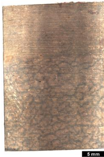
Obr. 11-224 Část měděného nástřiku použitá pro obrazovou dokumentaci
