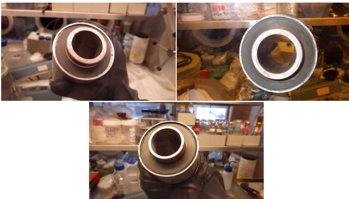
Obr. 7-3 Moduly MaCoTe_AN_MX80_Cu_7 (vlevo), MaCoTe_AN_MX80_Fe_1 (vpravo) a MaCoTe_AN_BaM_Fe_1 (dole) v rukavicovém boxu po odstranění vík
