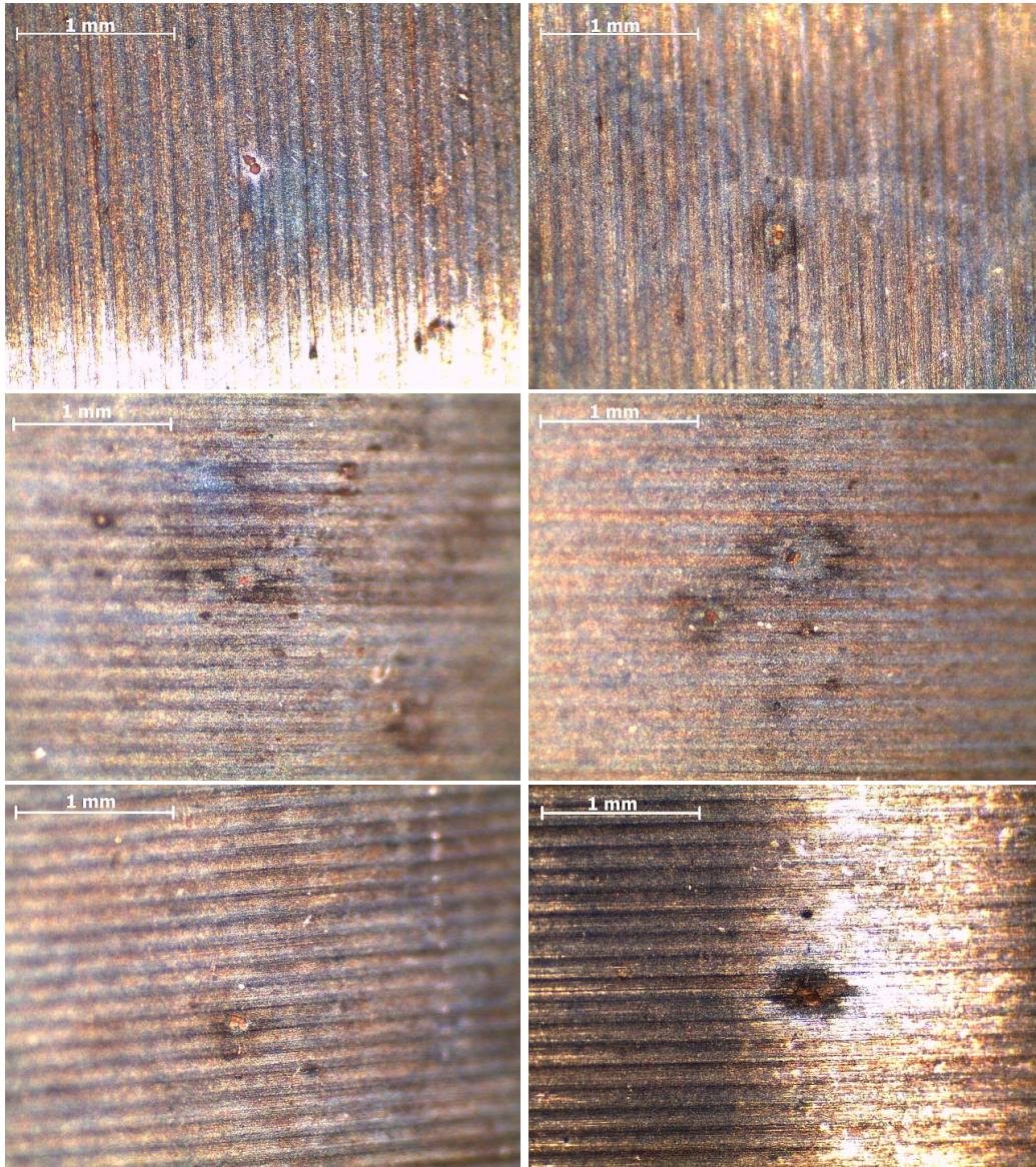
Obr. 11-271 Povrch vzorku měděného nástřiku MaCoTe_AN_MX80_Cu_2_01
