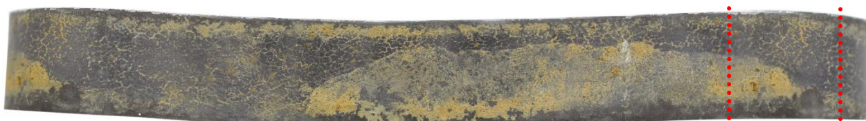
Obr. 11-198 Povrch vzorku uhlíkové oceli (složený obrázek z několika částí). Červené čáry značí místo řezu vzorku
