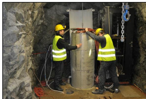
Obr. 11 – VLEVO: Výstavba superkontejneru s nosnými závitovými tyčemi a vystavěnou první vrstvou prefabrikátů, VPRAVO: Spouštění fyzikálního modelu do úložné studny v podzemní laboratoři Josef
