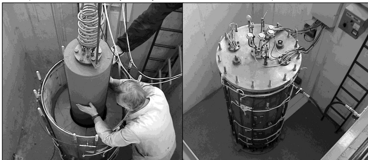
Obr. 7 - VLEVO: instalace topidla do modelu, VPRAVO: sestavený Model Mock-Up-CZ (Čechová, 2005)
