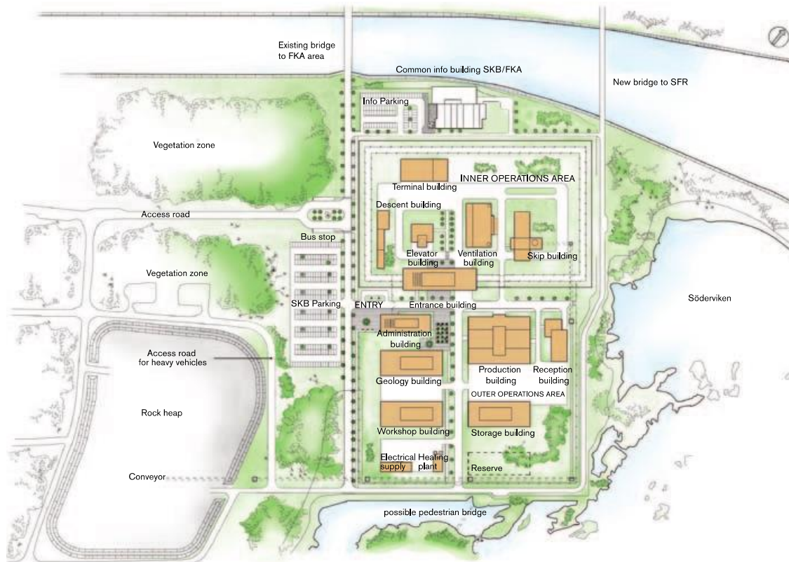
Obr. 28 Provozní (nadzemní) oblast úložiště.
