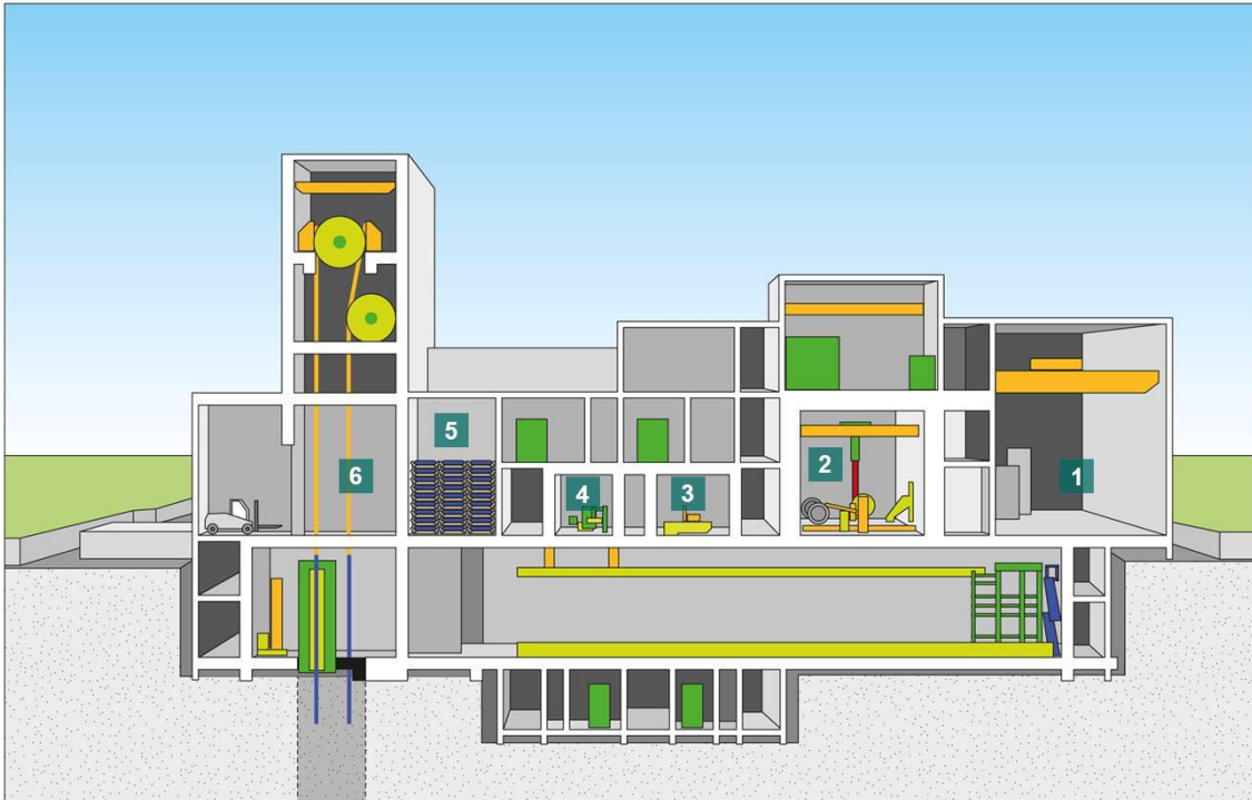
Obr. 11 Podélný řez zařízením pro umístění a uzavření paliva do ukládacích kontejnerů: 1. Příjem a úložný prostor pro nové obalové soubory; 2. Horká komora; 3. Svařovací komora; 4. Kontrola svarů; 5. Čištění povrchu ukládacích obalových souborů; 6. Výtah pro přesun souborů do úložiště.
