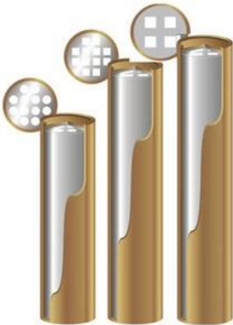
Obr. 3 Ukládací obalové soubory pro vyhořelé jaderné palivo: JE Loviisa 1 & 2 (vlevo), JE Olkiluoto 1 & 2 (uprostřed) a JE Olkiluoto 3 (vpravo).
