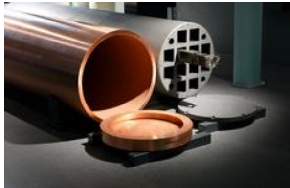
Obr. 4 Měděný plášť a vnitřní litinová vložka ukládacího obalového souboru
