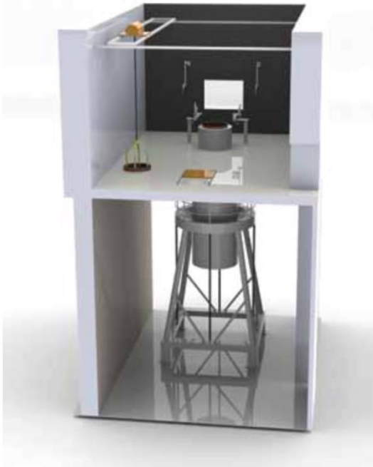
Obr. 62 Stanice sloužící k uzavírání kontejnerů, jejich plnění inertním plynem, svařování, obrábění a nedestruktivnímu testování.
