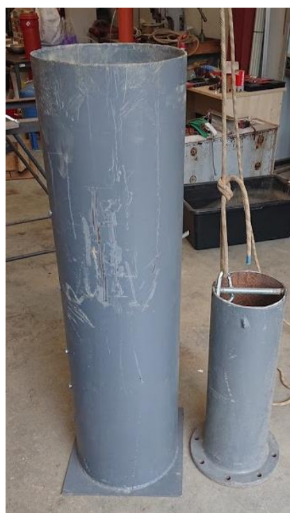
Obr. 23 Vlevo je odměrný válec (5 dm 3 ), který byl používán na menší hutní zkoušky a vpravo je válec o objemu 120 dm 3 s hutním pěchem.
