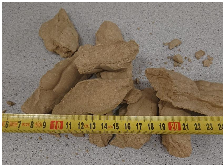
Obr. 3 Foto materiálu vylišaného kompaktořem, tzv. čočka označená M181; vlevo při odběru vzorku v úpravně a vpravo v laboratoři CEG.
