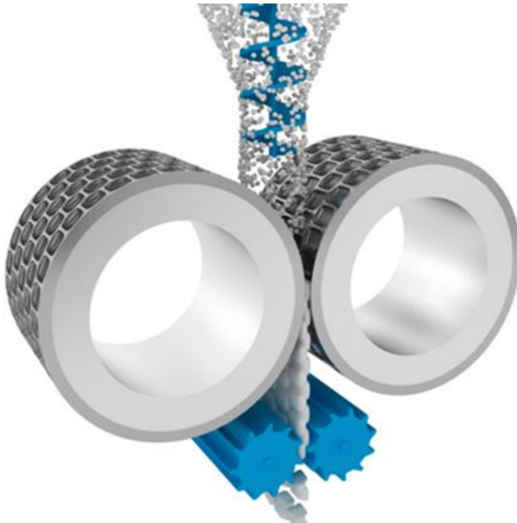
Obr. 1 Schéma lisovacích válců s perforací umístěnou v kompaktoru (zdroj Keramost – Köppern).
