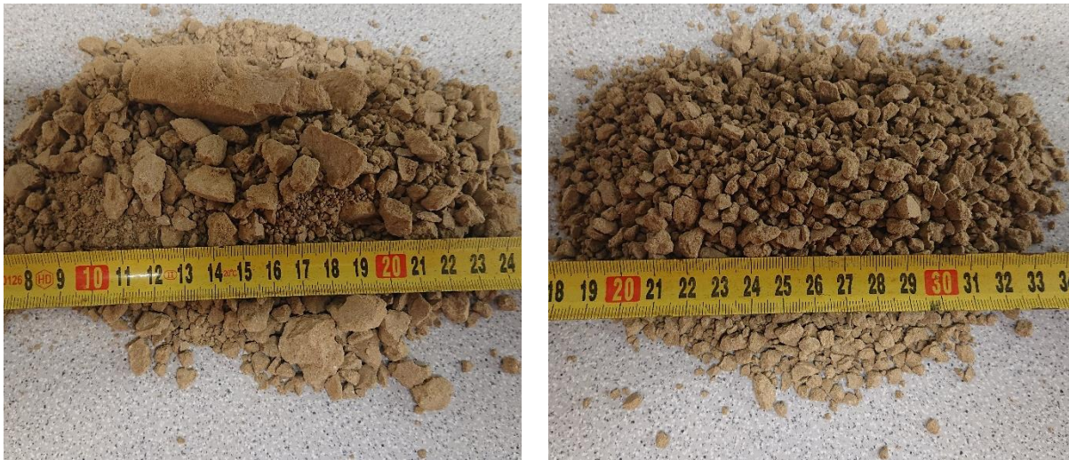
Obr. 4 Vlevo je zobrazen peletizovaný materiál označený M182 0-50 (drť odebraná pod kladivovým drtičem) a vpravo materiál M 182 1,6-8 (materiál po drcení zrnitostně vytříděný spodním sítím 1,6 mm a vrchním sítím 9 mm).
