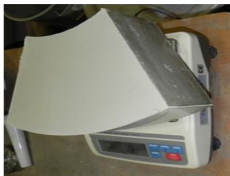
Obr. 7 - Rozebrání formy s prefabrikátem (vlevo) a vylisovaný prefabrikát při vážení (vpravo) [12].
