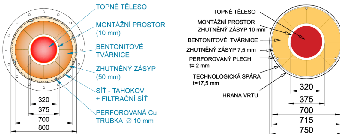
Obr. 97 - Půdorysné řezy experimenty v místě topného tělesa vlevo Mock-up-Cz a vpravo MCJ.
