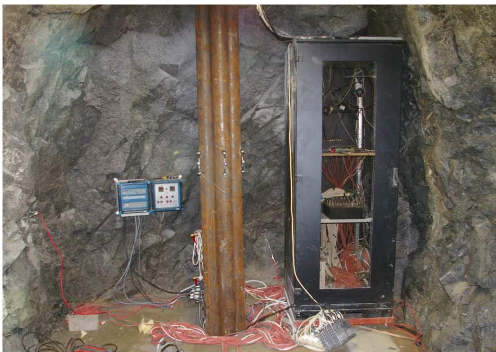
Obr. 34 - Obrázek po uzavření modelu rozpěrnými trubkami.
