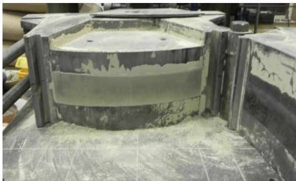
Obr. 7 - Rozebrání formy s prefabrikátem (vlevo) a vylisovaný prefabrikát při vážení (vpravo) [12].
