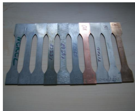
Obr. 15 - Vlevo umístění korozních vzorků ve 22. vrstvě bentonitových prefabrikátů, vprostřed umístění korozních vzorků ve vrstvě 23. a vpravo sada korozních vzorků před umístěním do modelu.
