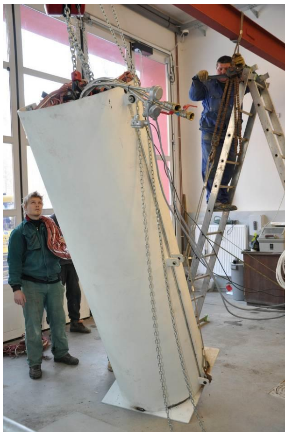
Obr. 19 - Model MCJ uložený v ocelovém přebalu při přípravě pro uložení na transportní vozík.
