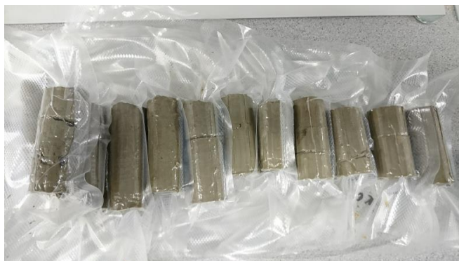
Obr. 69 - Vlevo vodorovný řez bentonitovou vrstvou a označení odběrných míst v bentonitu – odběry v bentonitu jsou zhruba stejně vzdálené od topného tělesa (10 cm); odběry byl realizovány do hloubky skrz víko modelu a vpravo je ukázka odebraných bentonitových jader, která byla po odběru vakuována.
