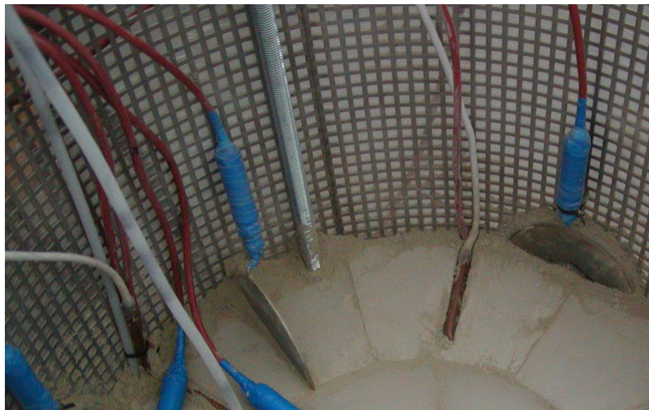
Obr. 37 - vlevo je analogový teploměr s čidlem LM35DZ v ochranné měděné trubičce a vpravo je instalovaný analogový teploměr na povrchu bentonitového prefabrikátu.
