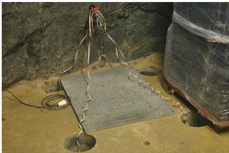
Obr. 41 - Měřící svorníky (vlevo) a osazené čtyři svorníky v blízkosti ukládacího vrtu.
