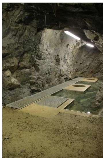
Obr. 66 - Na obrázku vlevo je schéma monitoringu okolí vrtu (půdorys) včetně orientačního umístění a označení čidel – vpravo je obrázek z rozrážky, na počtvě (dno) jsou vidět odvrtné velkoprofilové vrty. V nejvzdálenějším velkoprofilovém vrtu (u čelby) je instalovaný MCJ.
