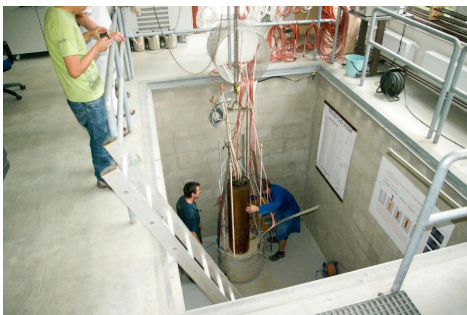
Obr. 17 - Spouštění topného tělesa a jeho umístění do modelu.
