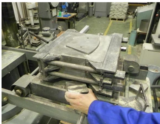
Obr. 6 - Složená forma před začátkem lisování (vlevo) a lisování (vpravo).
