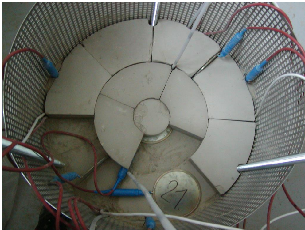
Obr. 18 - Umístění některých hydraulických tlakových buněk (foto II. měřícího profilu).
