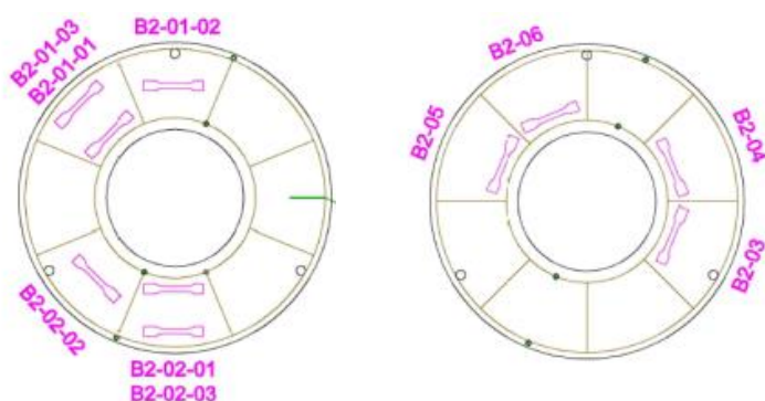
Obr. 15 - Vlevo umístění korozních vzorků ve 22. vrstvě bentonitových prefabrikátů, vprostřed umístění korozních vzorků ve vrstvě 23. a vpravo sada korozních vzorků před umístěním do modelu.
