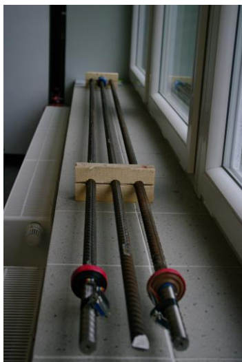
Obr. 41 - Měřící svorníky (vlevo) a osazené čtyři svorníky v blízkosti ukládacího vrtu.
