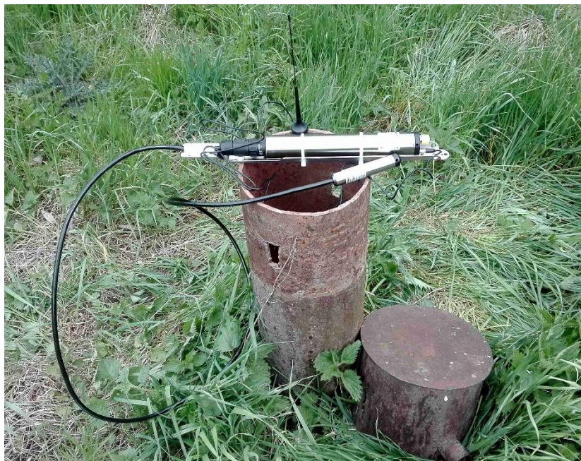
Obrázek 3 Sestava na automatické měření hladin s dálkovým přenosem dat
