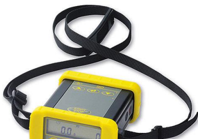
Obrázek 1 a) Digitální záznamník OTT Z400, b) hydrometrická vrtule OTT C2 (OTT Hydromet 2017, upraveno)
