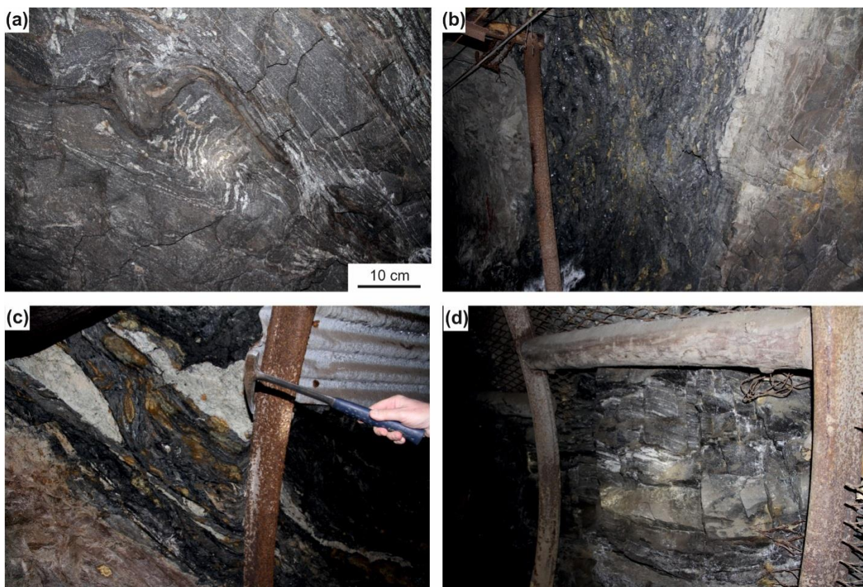
Obr. 382 (a) Zvrásněná metamorfní foliace v migmatitizované amfibolické rule (22. patro, R-3); (b) okraj první poruchové zóny (18. patro, R-3); (c) grafitická a karbonátová výplň v první zóně (18. patro, R-7S); (d) set subvertikálních poruch (21. patro, R-7S)
