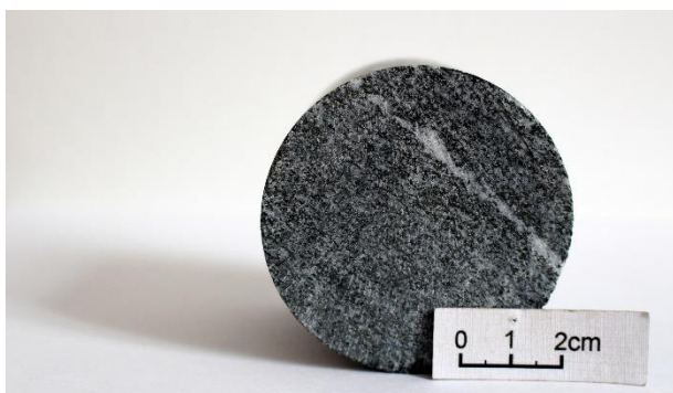
Obr. 284 Částečně alterovaný biotitický amfibolit (BGS24-I)
