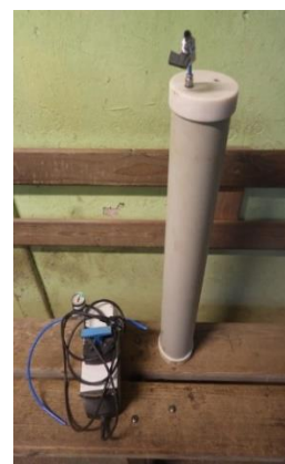
Obr. 304 Transportní přebal na odebrané vzorky hornin (in-situ)
