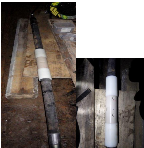
Obr. 313 Pakr s odběrovým intervalem pro odběr pórové vody
