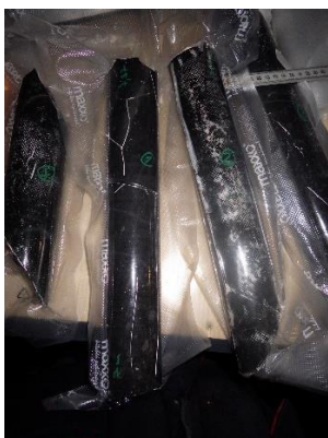
Obr. 302 Vakuace odvrtných vzorků horninového jádra
