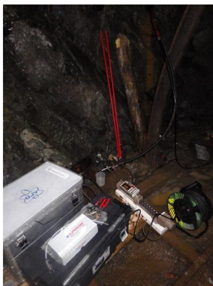
Obr. 324 Modifikované zařízení na vodní tlakové zkoušky
