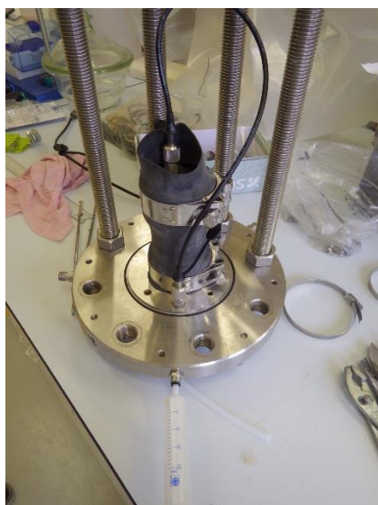
Obr. 309 Instalace horninového vzorku do propustoměru pro testování vysokotlaké extrakce
