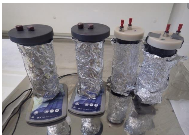
Obr. 306 Difuzní cely 1-4, míchání roztoku před odběrem vzorků
