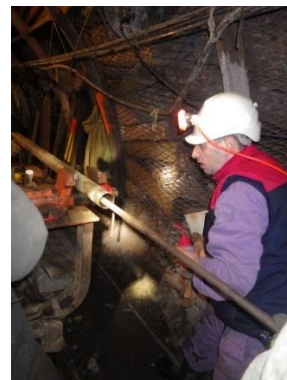
Obr. 301 Pročištění vrtného soutyčí před odběrem vzorků (etanol)
