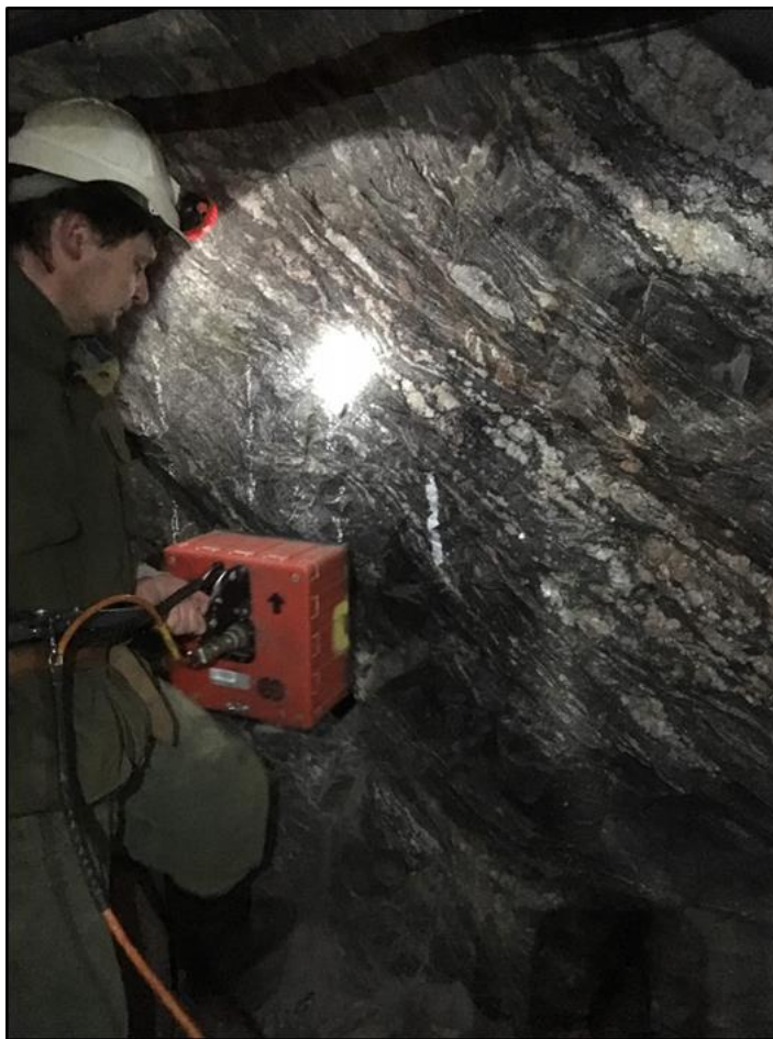
Obr. 473 Provádění georadarového měření na stěně štoly Z3-XX
