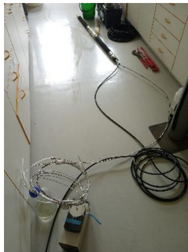
Obr. 312 Testování odběrového systému a těsnosti v laboratorních podmínkách
