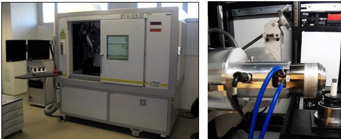
Obr. 506 RTG CT tomograf XT H 225 ST a transmisní mikrofokální zdroj RTG záření 225 kV
