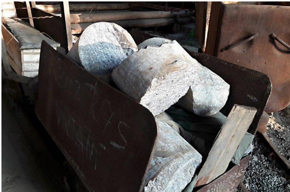
Obr. 20 Velkoobjemové vzorky vrtného jádra o průměru 300 mm. 18. patro jámy R-7S, překop V 3 -XVIII. 5. 6. 2018
