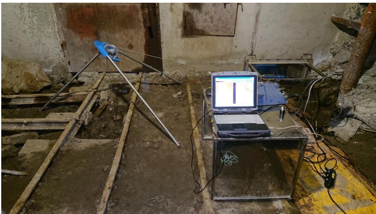
Obr. 331 Karotážní aparatura umístěná u úpadního vrtu BGS18-VD
