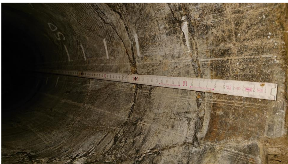
Obr. 570 Příklad extenzních puklin – 18. p. širokopřeměrový vrt V18-2
