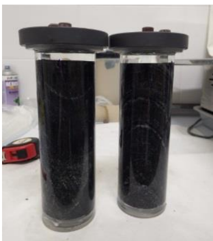
Obr. 305 Vzorky horniny (BGS12-H) nasazené v difuzních celách
