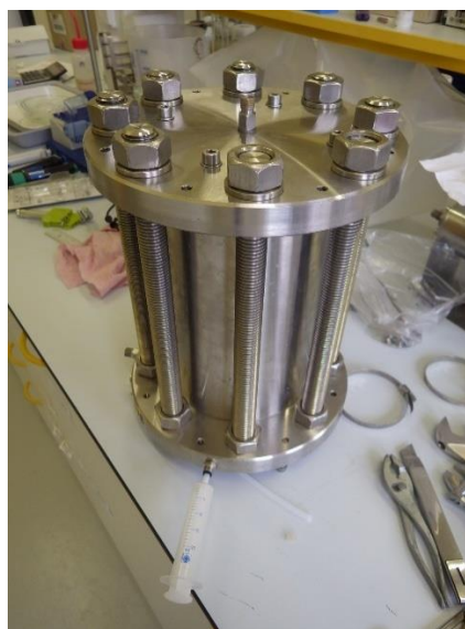
Obr. 310 Vysokotlaký propustoměr s odběrem vody
