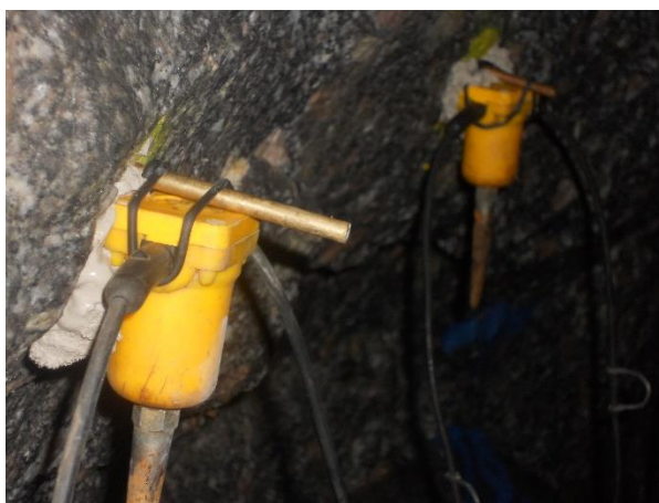
Obr. 85 Seismické geofony - jedna z variant jejich umístění na stěně štoly
