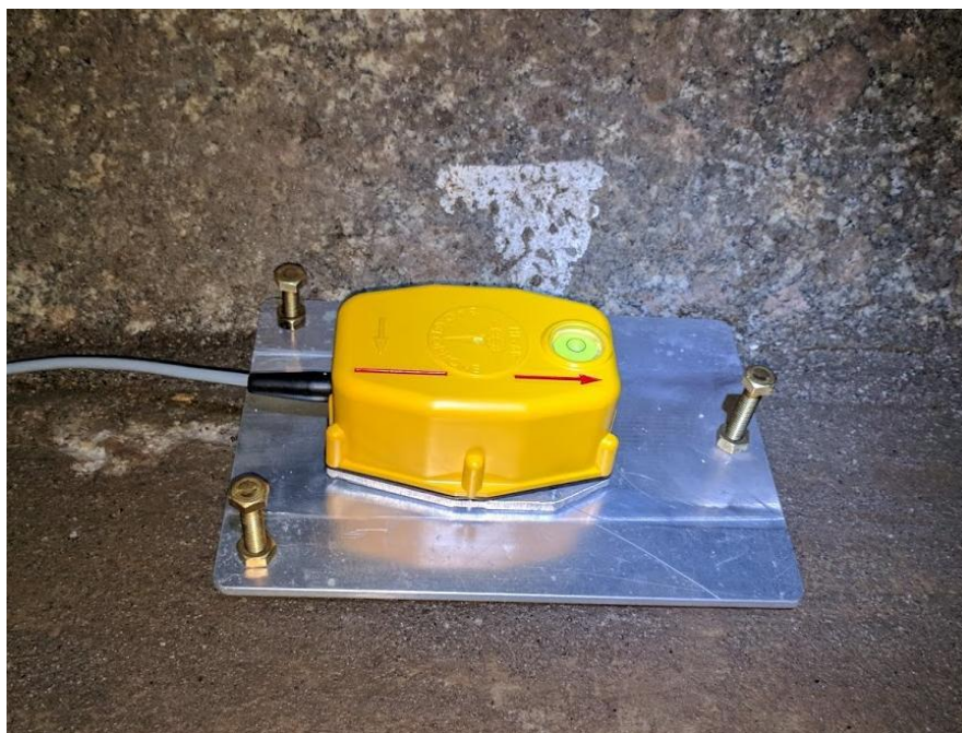
Obr. 58 Seismický snímač s geofony SM6-HB(UB) 3K5 na měřicím stanovišti ve štole.
