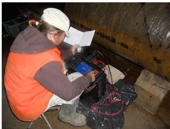
Obr. 84 Seismická aparatura Terraloc Mk-6 při měření ve štoli Bedřichov
