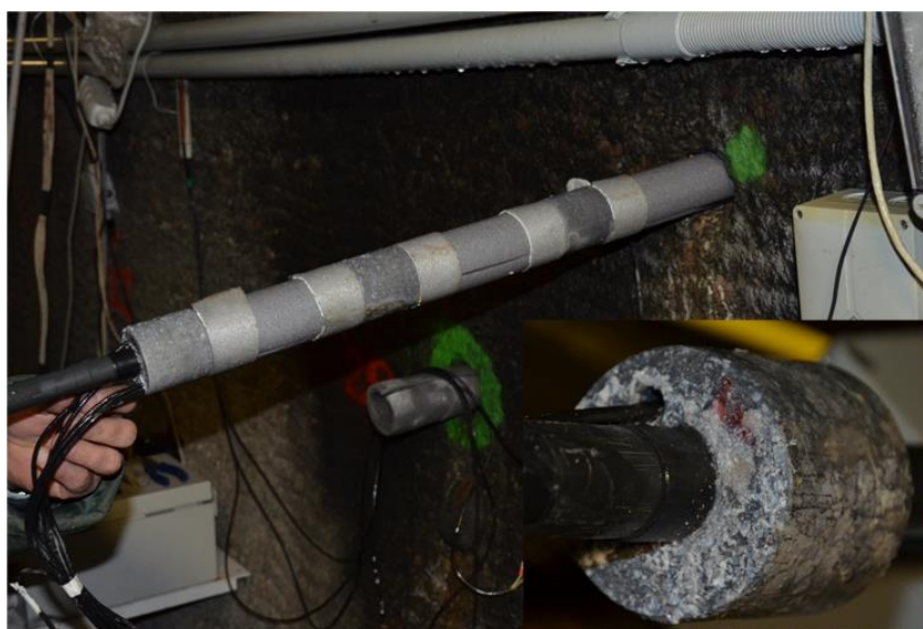
Obr. 70 Vyjímání teplotního řetězce z vrtu, ve výřezu pohled na zoxidovaný kovový prsteneček
