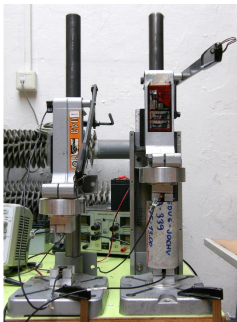
Obr. 107 Ultrazvukové prozařování horninových vzorků, vlevo: pulzní zdroj, osciloskop a zesilovač; vpravo: testovaný vzorek osazený mezi ultrazvukovými snímači
