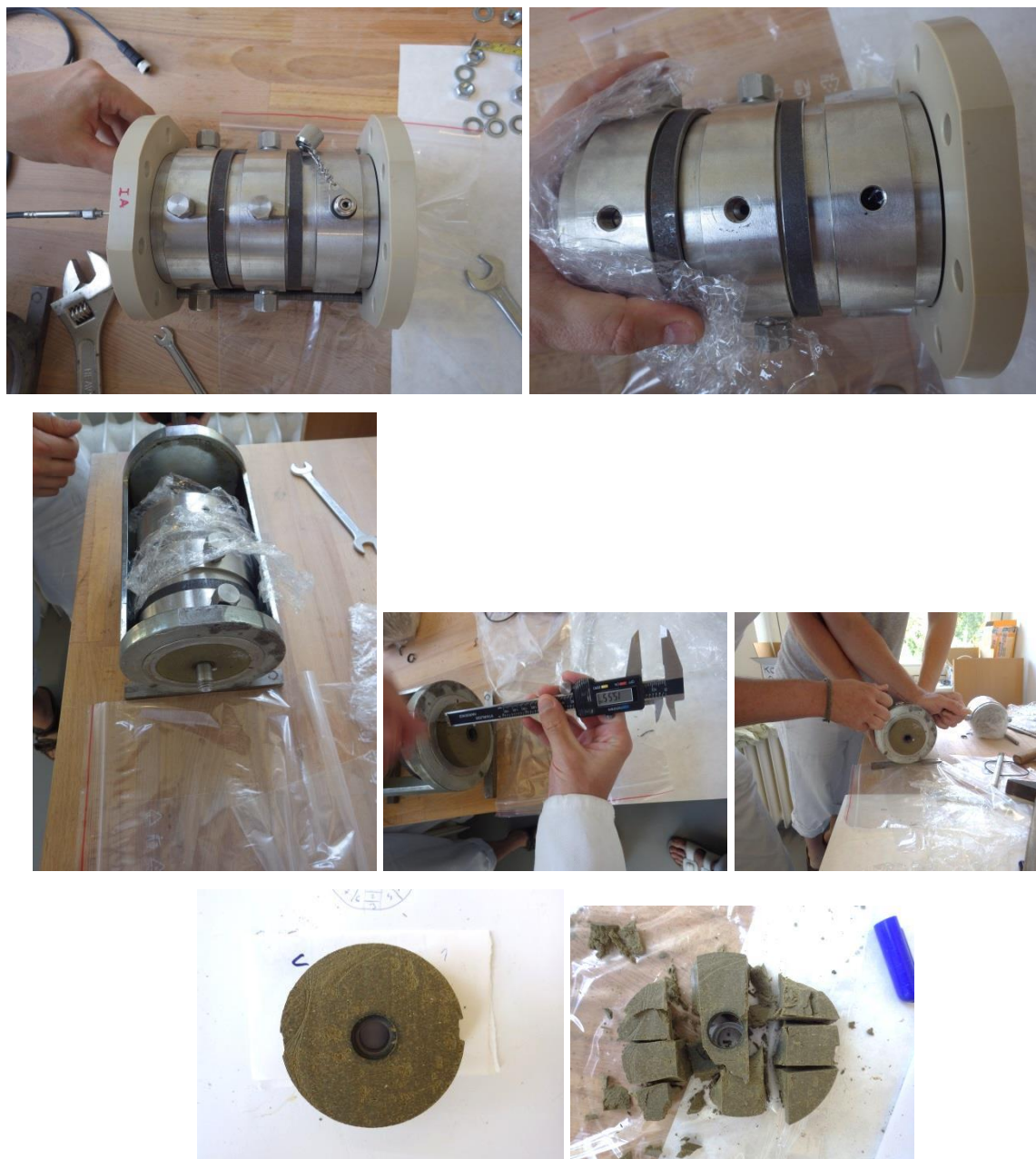
Obr. 51 Postup odběru a dělení bentonitových vzorků
