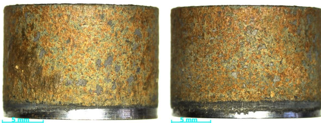
Obr. 64 Vzorek č. 36 (cela IIA) před a po čišťení ultrazvukem
