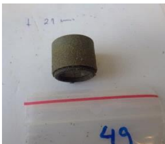
Obr. 53 Vzorek z uhlíkové oceli vyjmutý z bentonitového mezikruží
