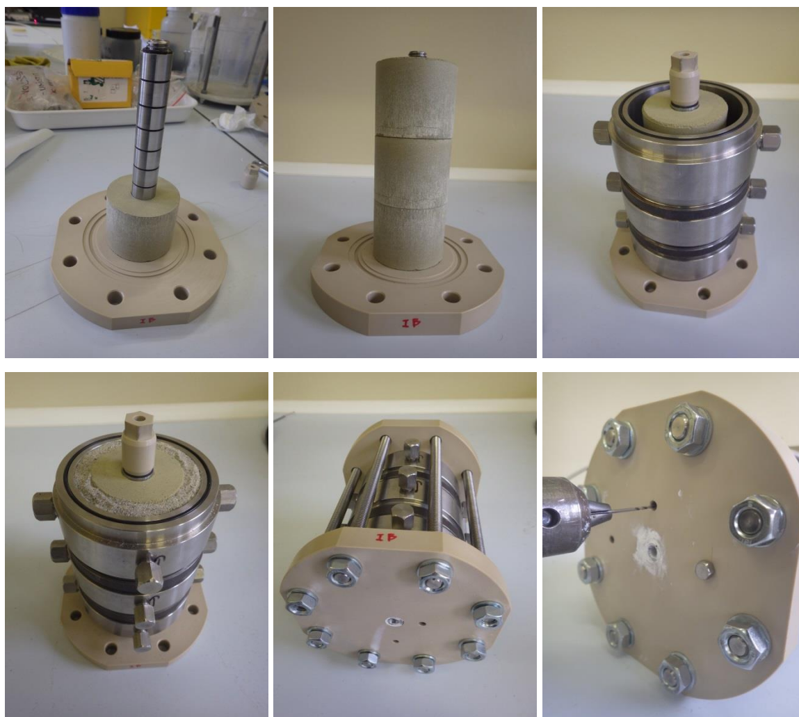
Obr. 39 Jednotlivé kroky při sestavování experimentální aparatury s drenáží
