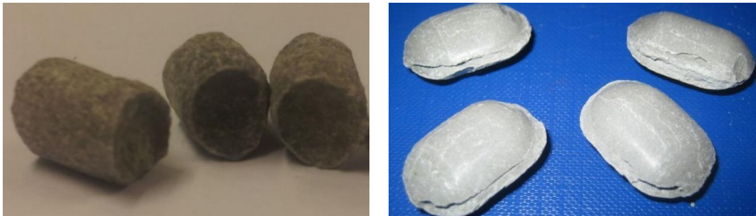
Obr. 20 – Bentonitové pelety ve finském výzkumu pro zaplnění technologické spáry; vlevo bentonitové pelety z technologie protlačování skrz matici; vpravo bentonitové pelety zhotovené lisováním mezi válci s otvory, do kterých je bentonit zatlačován [6].
