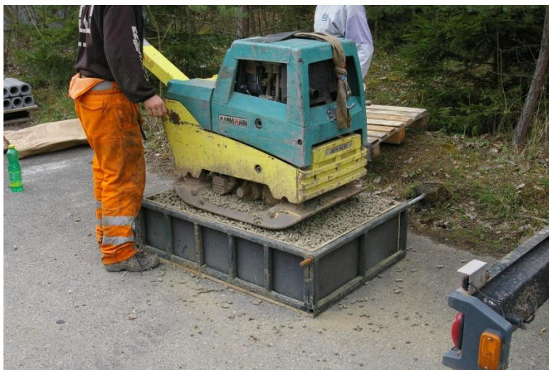
Obr. 16 – Experimentální drcení B75 PEL 12 s cílem úpravy zrnitosti mj. byla zjištěna také možnost zhutnění v určitém objemu, ale tento výsledek není důležitý pro tuto práci (interní materiály poskytovatele).
