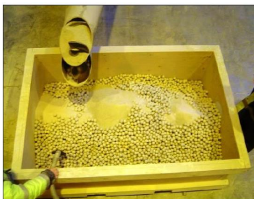
Obr. 25 – Obrázek z testování aplikace bentonitových pelet dvěma šnekovými dopravníky; vlevo zkoušky v boxu a vpravo obrázek ze zkoušky ve větším měřítku [12].
