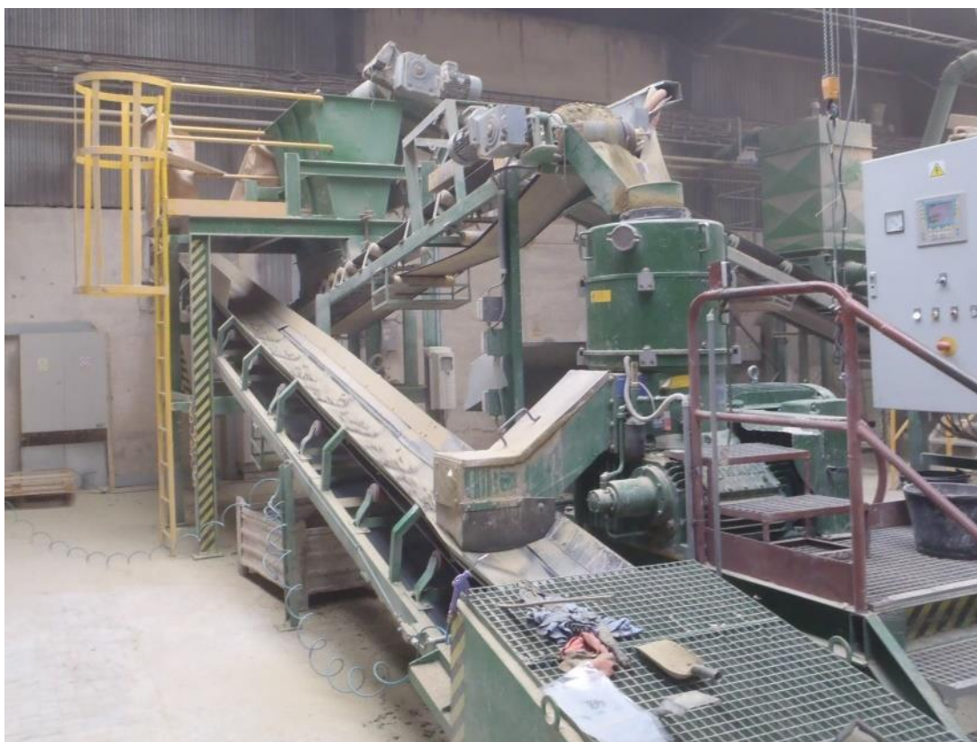
Obr. 8 – Výrobní linka pro lisování pelet. Na obrázku jsou zřejmé dva pásové dopravníky. Horní pásový dopravník sype zvlhčený materiál do stroje, ve kterém se zhušťují pelety protlačováním skrz matrici. Bentonitové pelety ze stroje samovolně vypadávají na spodní pásový dopravník, který dopravuje pelety k expedičnímu místu. (interní materiály poskytovatele).
