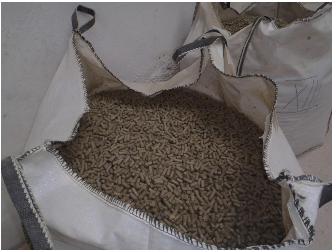
Obr. 13 – Bentonitové pelety o průměru 12 mm (B75 PEL 12) z plno provozní zkoušky lisování, rychlost lisování 1 tuna za 1 hodinu (interní materiály poskytovatele).
