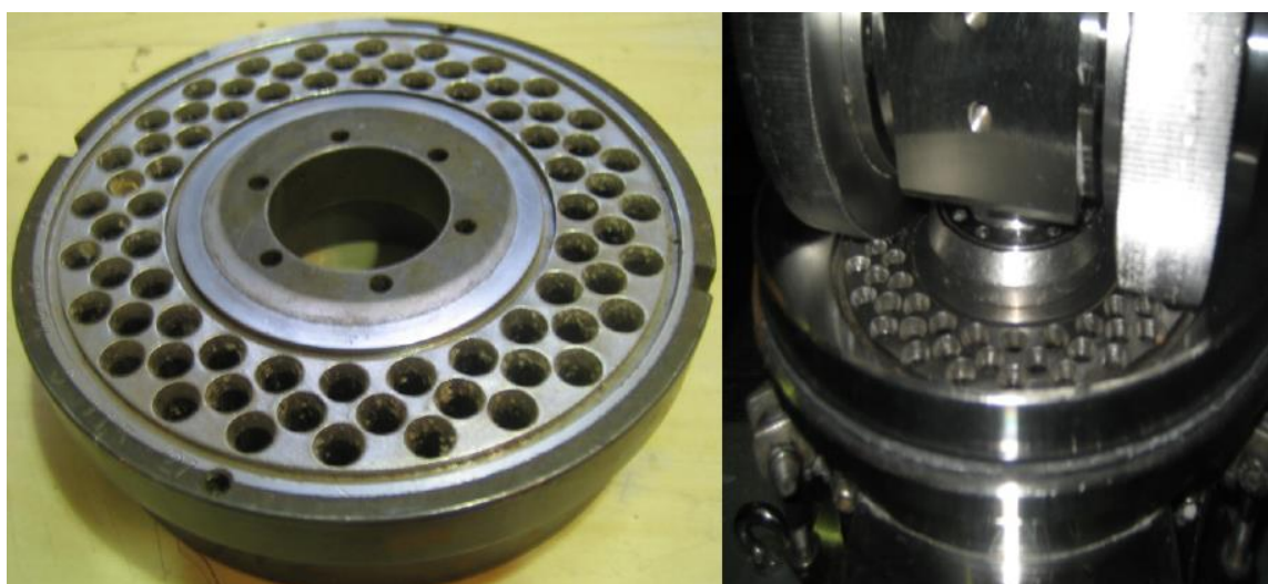
Obr. 9 – Obrázek matrice pro zhušťování pelet vlevo a vpravo detail umístění matrice ve stroji. Na obrázku vpravo jsou zřejmé dva válce (ocelová kola s vroubky), které se horizontálně otáčejí po matrici (vertikální osa otáčení je ve středu matrice) a zároveň se otáčejí vertikálně (horizontální osa je ve středu válců zhruba 30 cm nad matricí). Válce (kola) svými otáčivými pohyby zatlačují bentonit do kruhových otvorů v matrici [6].
