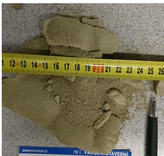
Obr. 2 – Obrázky slisovaných materiálů – vlevo materiál vylisovaný kompaktorem (tzv. čochka, označení zkratkou M181) a vpravo materiál vylisovaný kompaktorem a podrcený kladivovým drtičem (tzv. drť, označení M182).
