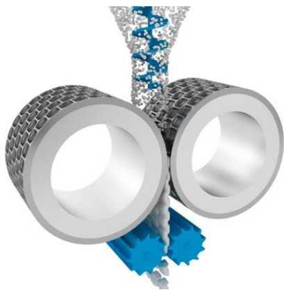
Obr. 1 – Vlevo je 3D schéma lisovacích válců s perforací, které jsou umístěny v kompaktoru, viz obrázek vpravo.
