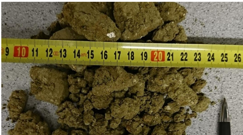
Obr. 13 – Aktivovaný bentonit po úpravě v kolovém mlýnu (materiál označený zkratkou M 180 – kolový mlýn).
