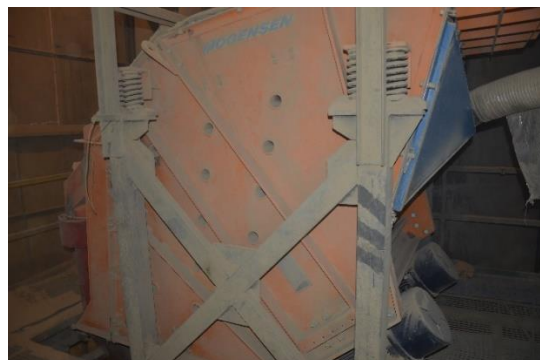
Obr. 3 – Vlevo na obrázku je kladivový drtič (KDV 630) a vpravo je stroj (SH 1036 -D6809) pro zrnitostní třídění vylisovaného a drceného peletizovaného bentonitu.
