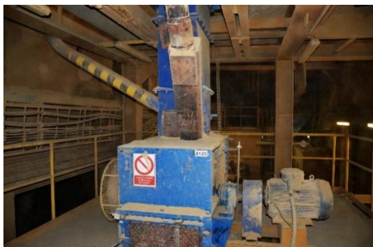
Obr. 3 – Vlevo na obrázku je kladivový drtič (KDV 630) a vpravo je stroj (SH 1036 -D6809) pro zrnitostní třídění vylisovaného a drceného peletizovaného bentonitu.
