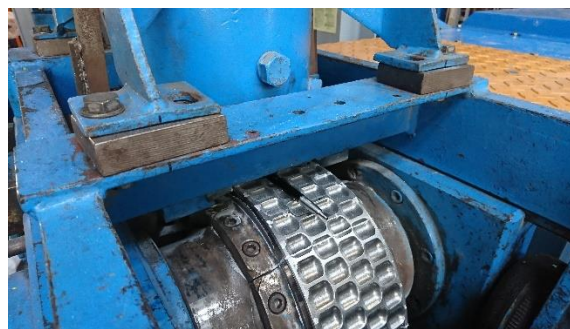
Obr. 15 – Fotky z návštěvy technologické zkušebny – vlevo obrázek ze zkušebny a vpravo je ukázka matrice pro lisování pelet ve zkušebním „kompaktoru“.
