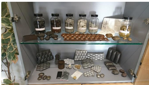
Obr. 16 – Vlevo na obrázku jsou různé peletizované materiály, které byly zkušeny ve zkušebně firmy Köppern GmbH & Co v minulosti (mýdla, kovy, síra, atd.); vpravo je ilustrační obrázek vylisované pelety.
