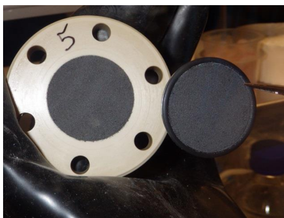
Obr. 9 Střední díl korozní cely č. 5 (40 °C) po oddělení ocelového podkladového disku, na bentonitu přítomna část zachyceného práškového železa (vlevo) a ocelový podkladový disk se zachyceným práškovým železem (vpravo)
