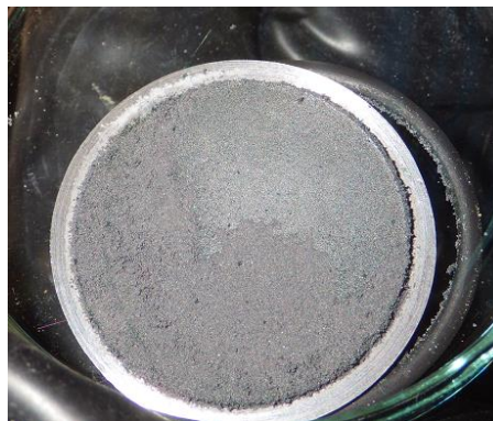
Obr. 48 Detail ocelového podkladového disku z cely č. 13 (laboratorní teplota) se zachyceným práškovým železem
