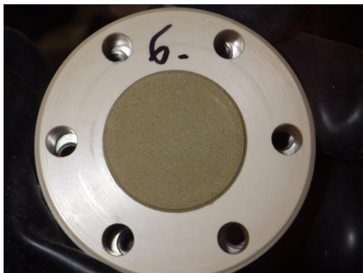
Obr. 17 Střední díl korozní cely č. 6 (40 °C) s kompaktným bentonitem, strana směrem k fritě
