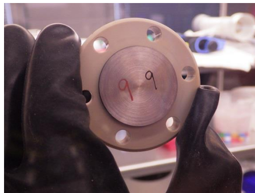
Obr. 11 Střední díl (vpravo) korozní cely č. 9 (laboratorní teplota) v okamžiku oddělení spodní části korozní cely (vlevo)
