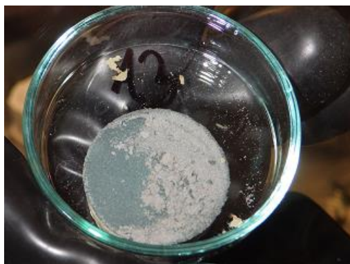
Obr. 61 Kompaktovaný bentonit z cely č. 13 (laboratorní teplota) se zbytky vrstvy práškového železa s korozními produkty
