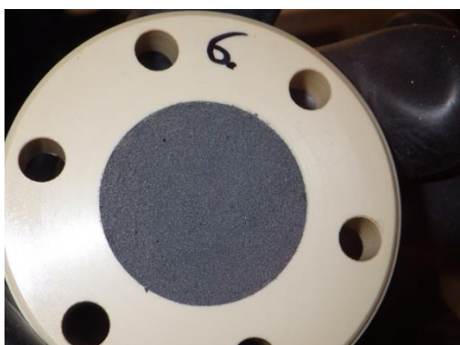
Obr. 19 Střední díl korozní cely č. 6 (40 °C) po oddělení ocelového podkladového disku, na bentonitu přítomna souvislá vrstva zachyceného práškového železa
