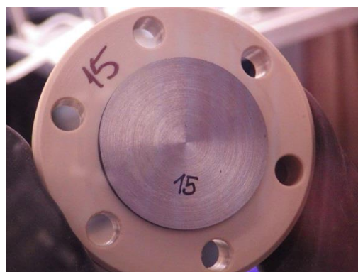
Obr. 42 Střední díl korozní cely č. 15 (40 °C) se zachyceným podkladovým ocelovým diskem
