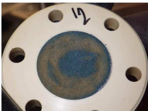
Obr. 15 Střední díl korozní cely č. 12 (70 °C) po oddělení ocelového podkladového disku
