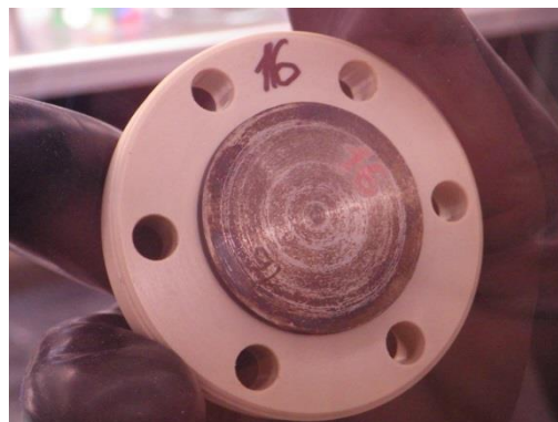
Obr. 26 Střední díl korozní cely č. 16 (70 °C) s pevně zachyceným podkladovým ocelovým diskem
