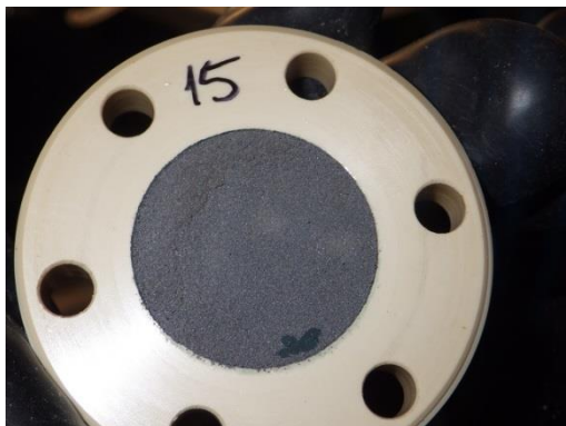
Obr. 43 Střední díl korozní cely č. 15 (40 °C) po oddělení ocelového podkladového disku, na bentonitu přítomna souvislá vrstva zachyceného práškového železa
