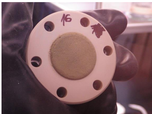
Obr. 25 Střední díl korozní cely č. 16 (70 °C) s kompaktovaným bentonitem, strana směrem k fritě
