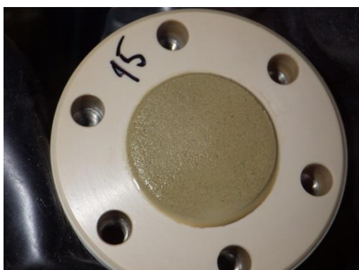
Obr. 41 Střední díl korozní cely č. 15 (40 °C) s kompaktním bentonitem, strana směrem k fritě
