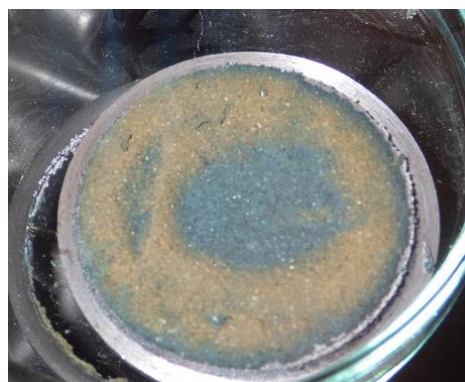
Obr. 16 Detail ocelového podkladového disku z cely č. 12 (70 °C) se zachyceným práškovým železem a korozními produkty a vrstvou bentonitu
