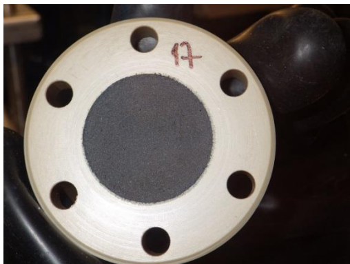
Obr. 31 Střední díl korozní cely č. 17 (40 °C) po oddělení ocelového podkladového disku, na bentonitu přítomna souvislá vrstva zachyceného práškového železa
