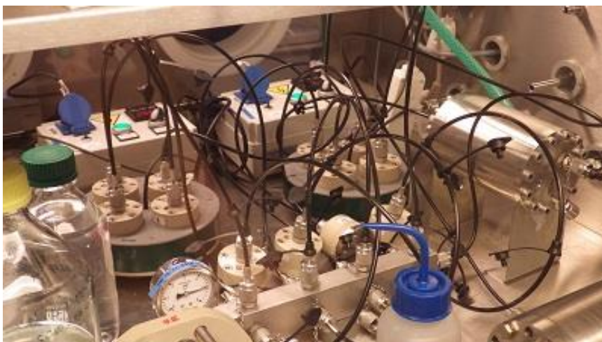
Obr. 1 Experimentální aparatura v rukavicovém boxu v průběhu experimentu za plného tlaku syčící kapaliny (5 MPa) a s vytápěním hnízd. Vpravo tlakový výměník se syntetickou podzemní vodou, vpředu rozvodný systém s kontrolou tlaku a za ním dvojice topných hnízd s korozními celami.
