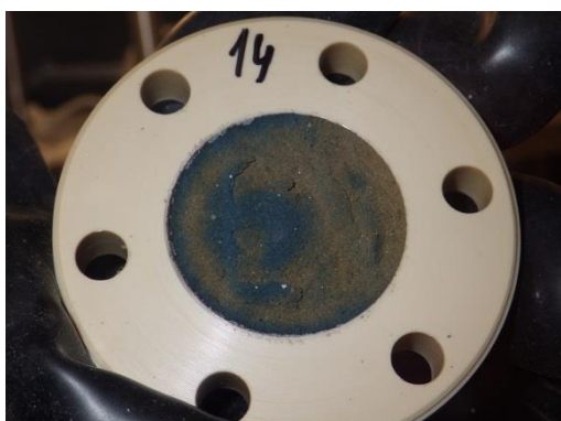
Obr. 39 Střední díl korozní cely č. 14 (70 °C) po oddělení ocelového podkladového disku
