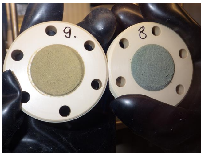
Obr. 6 Porovnání barev kompakovaného bentonitu na straně sycení v cele č. 9 (laboratorní teplota, vlevo) a v cele č. 8 (70 °C, vpravo)
