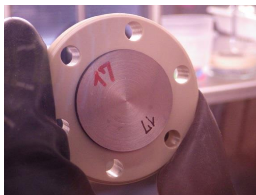
Obr. 30 Střední díl korozní cely č. 17 (40 °C) se zachyceným podkladovým ocelovým diskem
