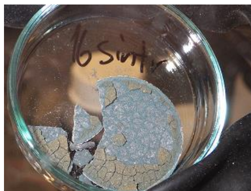
Obr. 60 „Sintr“ se zbytky bentonitu bentonit z cely č. 16 (70 °C)
