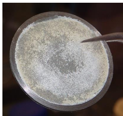
Obr. 58 Ocelový disk z cely č. 17 (40 °C) pokrytý šedobílou vrstvou spolu se zbytky práškového železa
