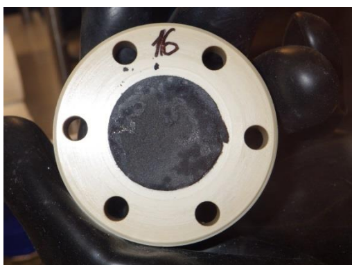
Obr. 27 Střední díl korozní cely č. 16 (70 °C) po oddělení ocelového podkladového disku
