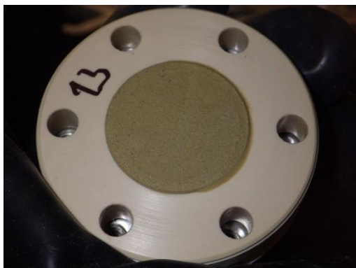
Obr. 45 Střední díl korozní cely č. 13 (laboratorní teplota) s kompaktním bentonitem, strana směrem k fritě
