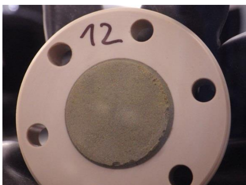
Obr. 13 Střední díl korozní cely č. 12 (70 °C) s kompaktovaným bentonitem, strana směrem k fritě
