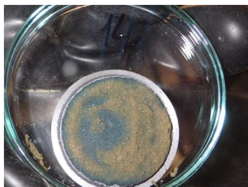
Obr. 40 Detail ocelového podkladového disku z cely č. 14 (70 °C) se zachyceným práškovým železem a korozními produkty a vrstvou bentonitu
