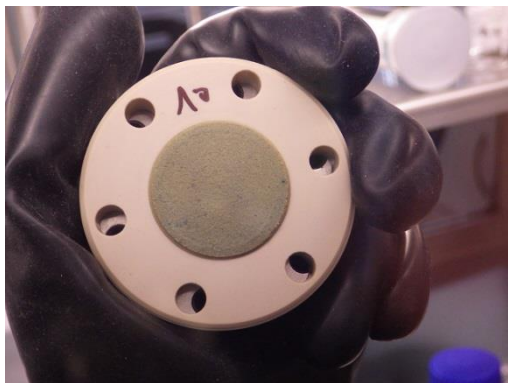
Obr. 21 Střední díl korozní cely č. 10 (laboratorní teplota) s kompaktovaným bentonitem, strana směrem k fritě
