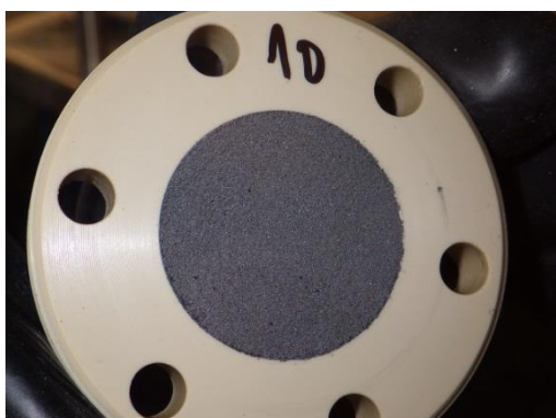
Obr. 23 Střední díl korozní cely č. 10 (laboratorní teplota) po oddělení ocelového podkladového disku, na bentonitu přítomna souvislá vrstva zachyceného práškového železa
