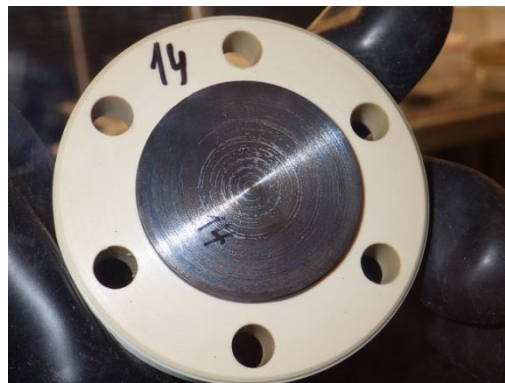
Obr. 38 Střední díl korozní cely č. 14 (70 °C) s pevně zachyceným podkladovým ocelovým diskem
