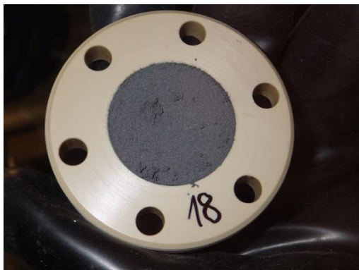
Obr. 35 Střední díl korozní cely č. 18 (laboratorní teplota) po oddělení ocelového podkladového disku, na bentonitu přítomna souvislá vrstva zachyceného práškového železa
