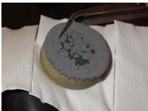
Obr. 57 Kompaktovaný bentonit se zbytky práškového železa na povrchu z cely č. 18 (laboratorní teplota)
