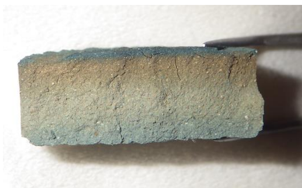
Obr. 52 Kompaktovaný bentonit z cely č. 8 (70 °C) – po rozlomení kompakovaného tělesa podél trhliny
