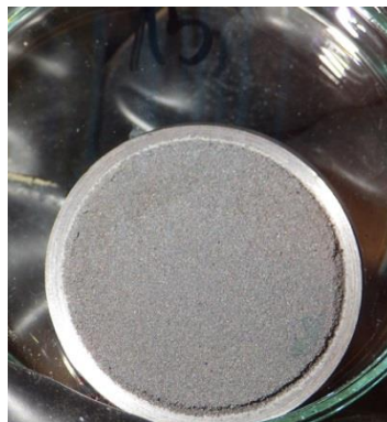
Obr. 44 Detail ocelového podkladového disku z cely č. 15 (40 °C) se zachyceným práškovým železem
