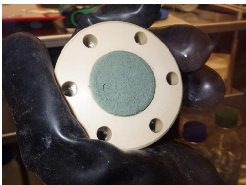
Obr. 2 Střední díl korozní cely č. 8 (70 °C) s kompaktovaným bentonitem, strana směrem k fritě
