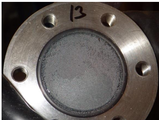
Obr. 47 Spodní díl korozní cely č. 13 (laboratorní teplota) s odděleným ocelovým podkladovým diskem
