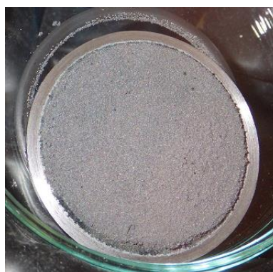
Obr. 24 Detail ocelového podkladového disku z cely č. 10 (laboratorní teplota) se zachyceným práškovým železem
