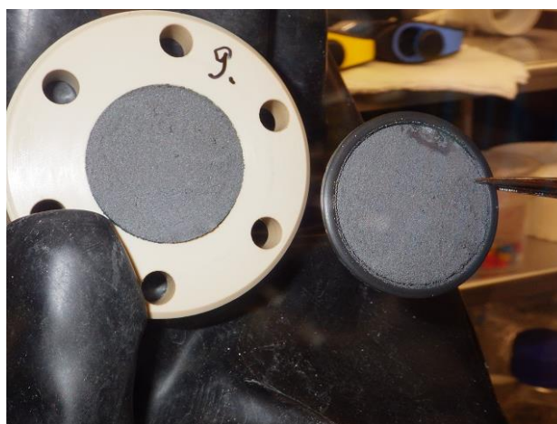
Obr. 12 Střední díl korozní cely č. 9 (laboratorní teplota) po oddělení ocelového podkladového disku, na bentonitu přítomna část zachyceného práškového železa (vlevo) a ocelový podkladový disk se zachyceným práškovým železem (vpravo)
