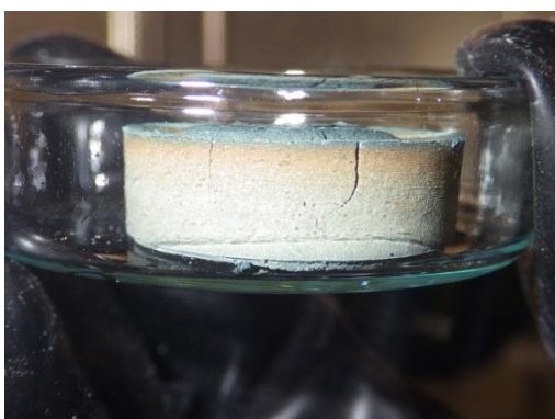
Obr. 51 Kompaktovaný bentonit z cely č. 8 (70 °C) – detail trhliny (boční pohled)
