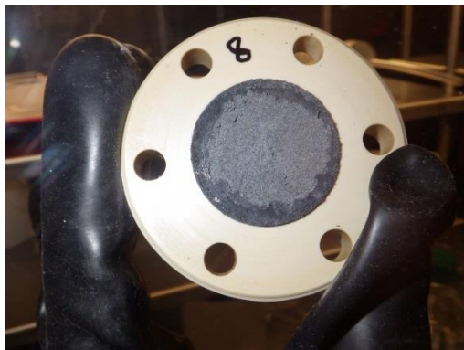
Obr. 4 Střední díl korozní cely č. 8 (70 °C) po oddělení ocelového podkladového disku, na bentonitu přítomno pevně zachycené „sintrované“ práškové železo
