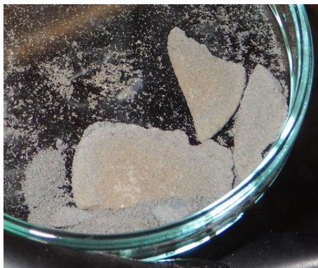
Obr. 63 Práškové železo s korozními produkty z cely č. 13 (laboratorní teplota), směrem k objektivu je strana v kontaktu s ocelovým diskem
