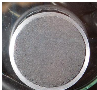
Obr. 20 Detail ocelového podkladového disku z cely č. 6 (40 °C) se zachyceným práškovým železem
