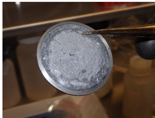
Obr. 5 Detail ocelového podkladového disku z cely č. 8 (70 °C) se zachyceným práškovým železem a korozními produkty
