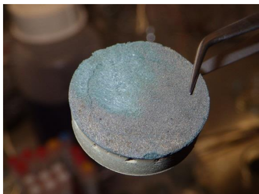
Obr. 53 Kompaktovaný bentonit z cely č. 6 (40 °C) po částečném odstranění vrstvy zbytků práškového železa s korozními produkty
