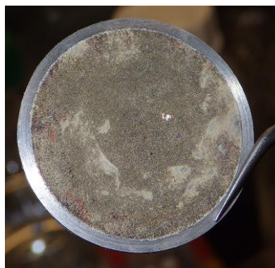
Obr. 54 Ocelový disk z cely č. 6 (40 °C) se zbytky práškového železa s korozními produkty a s dobře patrnými rezavě hnědými skvrnami
