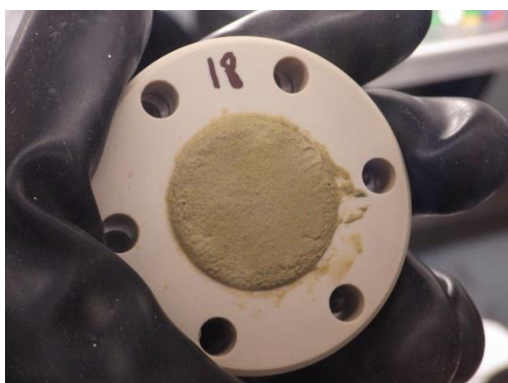
Obr. 33 Střední díl korozní cely č. 18 (laboratorní teplota) s kompaktním bentonitem, strana směrem k fritě
