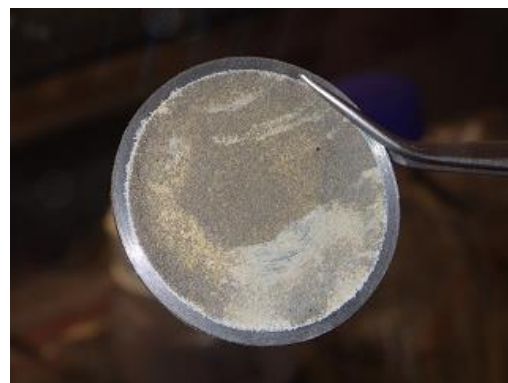
Obr. 62 Povrch ocelové disku z cely č. 15 (40 °C) po odstranění vrstvy práškového železa s korozními produkty
