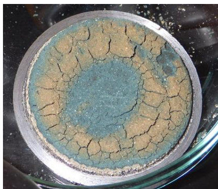
Obr. 55 Alterovaný bentonit zachycený na „sintru“ – vzorek z cely č. 12 (70 °C)
