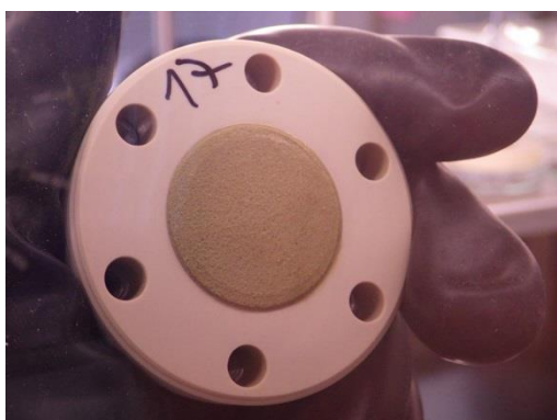
Obr. 29 Střední díl korozní cely č. 17 (40 °C) s kompaktovaným bentonitem, strana směrem k fritě
