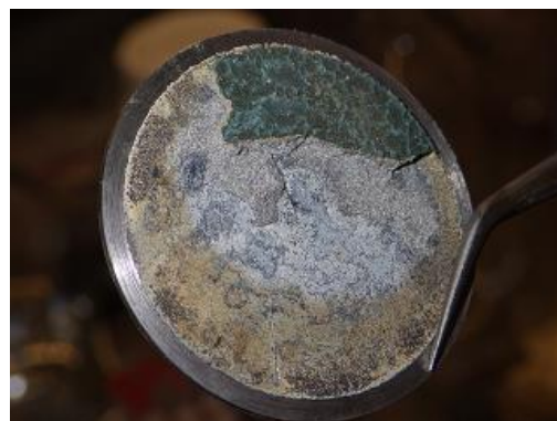
Obr. 56 Ocelový disk z cely č. 12 (70 °C) se zbytky vrstvy „sintru“ pokryté tmavě zelenými korozními/alteračními produkty
