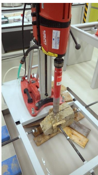
Obr. 1 a) Příklad odvrtání vzorků GRB (granulit) z bloku horniny, b) Odebrané vzorky vrtného jádra po naformátování pro laboratorní analýzy
