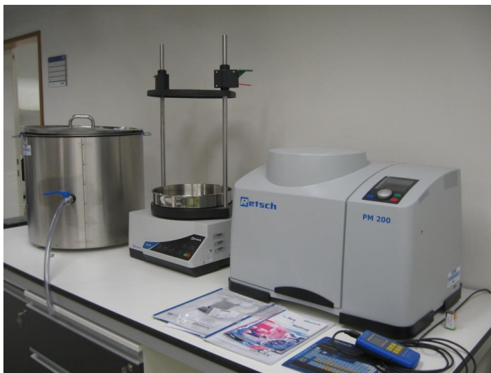
Obr. 3 Planetární kulový mlýn PM 200 (Retsch), síťovací stroj AS 300 (Retsch) a UV lázeň pro čištění sít (popis obrázku zprava doleva)
