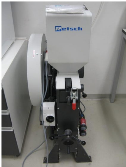
Obr. 2 vlevo: Čelistový drtič BB 200 (Retsch), vpravo: Nadrcený vzorek horniny
