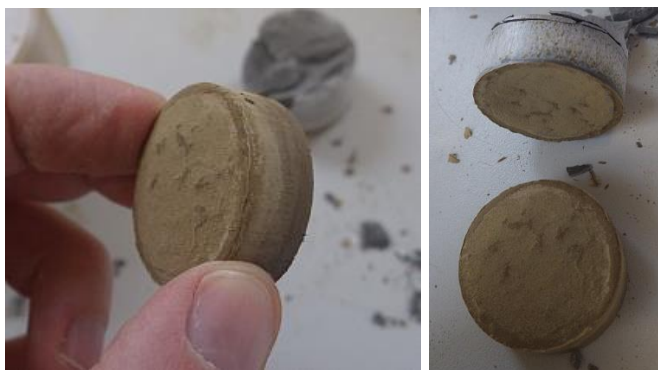
Obr. 3.1 Vzorek bentonitu, který byl v kontaktu s čistým cementem
