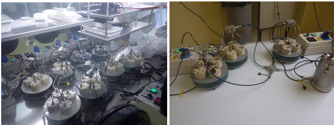
Obr. 2.3 Ilustrační obrázek propojených korozních cel v topných hnízdech v rukavicovém boxu a mimo rukavicový box
