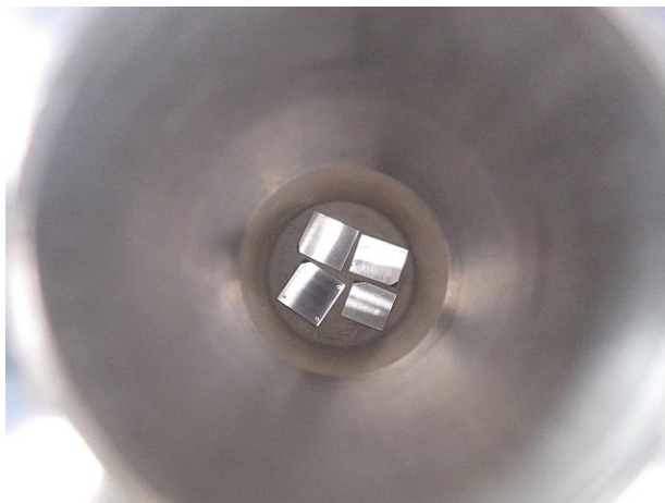
Obr. 2.1 Ilustrační obrázek umístění kovových vzorků v korozní cele
