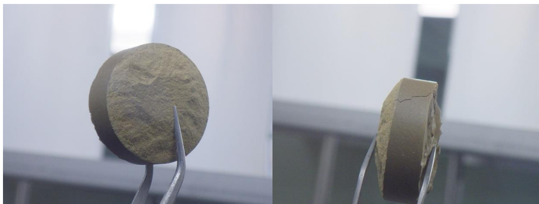
Obr. 3.4 Rozhraní s vyšším obsahem kalcitu u ABM_CVR_10% směsi po 9 měsících expozice
