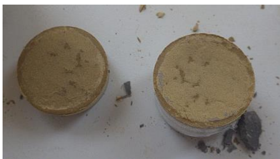
Obr. 3.2 Ilustrační obrázek rozhraní mezi bentonitem BCV a cementem CEM I
