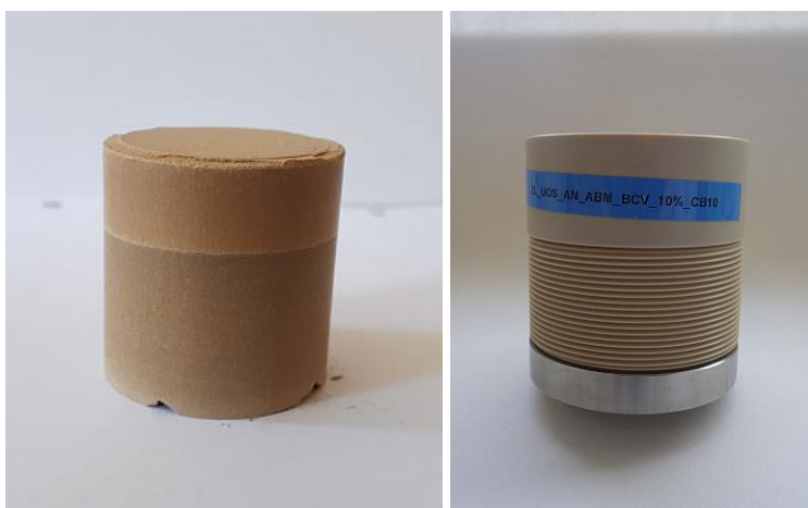
Obr. 2.2 Ilustrační obrázek směsi ABM_CVR+BCV (nalevo) a korozní cely (napravo) obsahující tuto směs
