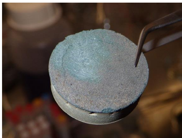
Obr. 13 Kompaktovaný bentonit z cely č. 6 (40 °C) po částečném odstranění vrstvy zbytků práškového železa s korozními produkty
