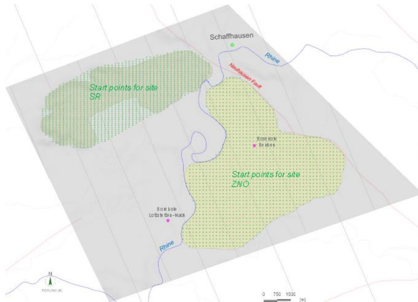
Obr. 40 Rozložení rastru bodů na lokalitě Zürich Nordost, ze kterých byly vypouštěny částice při metodě particle tracking (Luo et al. 2014)
