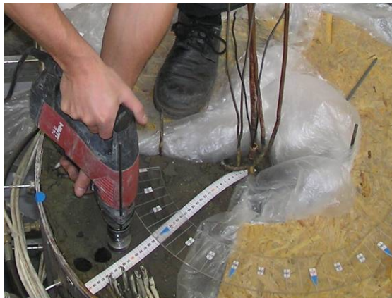
obr. 12 Jádrový odběr – průměr 16 mm
