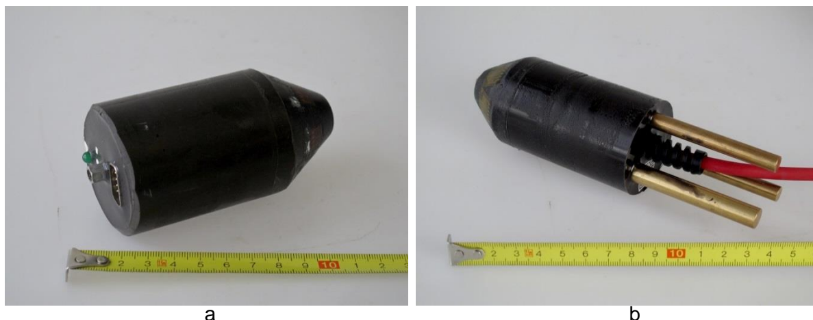
Obr. 6 Fotografie použitých sond CCBO (a) a CCBM (b) do vrtů o průměru 76 mm osazených 6 skupinami tenzometrů na kuželové špičce
