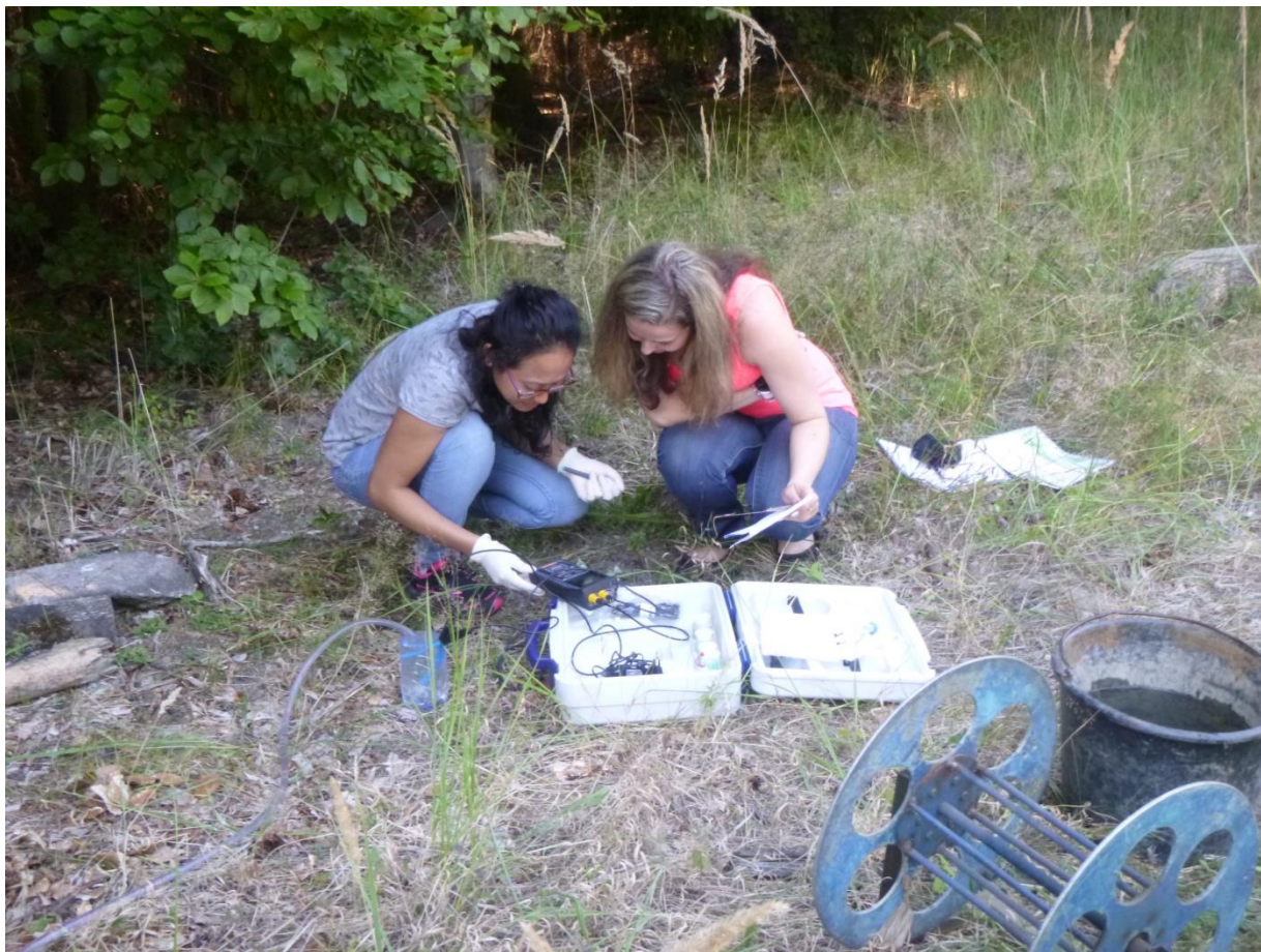
Obr. 1 Měření fyzikálně-chemických parametrů při odběru vzorků vody při odběrech na lokalitě Melechov
