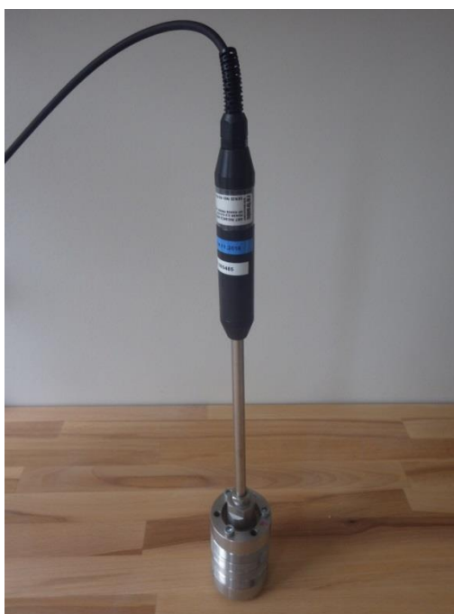
Obr. 19 Aparatura pro stanovení retenční křivky
