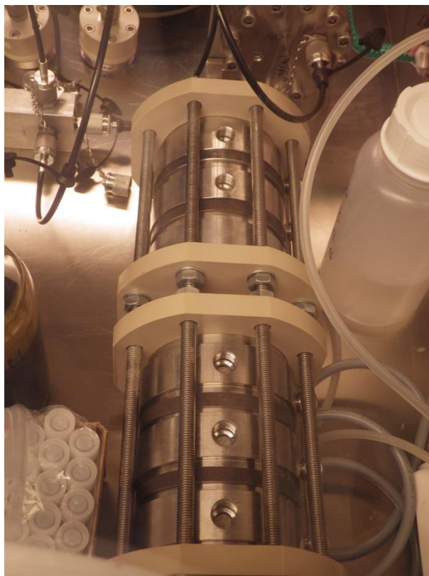
Obr. 38 Odkysličování drenážních cel v rukavicovém boxu
