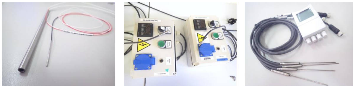
Obr. 28 instrumentace experimentu a) topné těleso, b) regulátor teploty, c) systém měření teploty
