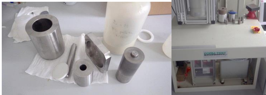
Obr. 1 Lisovací přípravky a použitý lis MEGA
