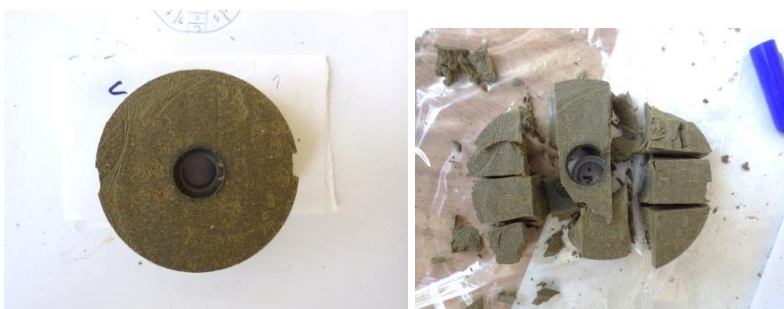
Obr. 50 Postup odběru a dělení bentonitových vzorků
