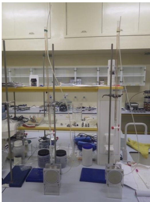
Obr. 5 Bobtnací aparatury připojené k byretám
