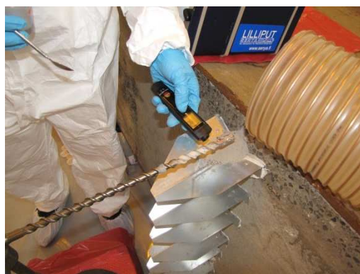
Obr. 9: Fotografie dokumentující způsob a průběh odběru vzorků z betonového segmentu.
