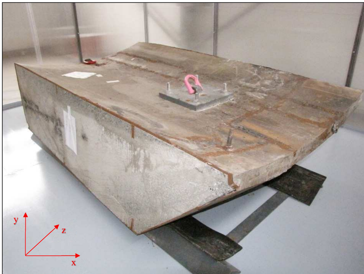
Obr. 3: Betonový segment biologického stínění z šachty reaktoru 5. bloku JE Greifswald
