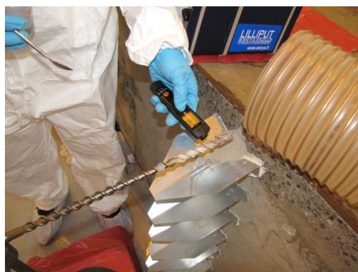
Obr. 9: Fotografie dokumentující způsob a průběh odběru vzorků z betonového segmentu.
