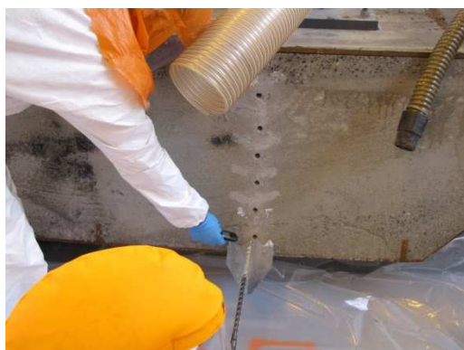
Obr. 9: Fotografie dokumentující způsob a průběh odběru vzorků z betonového segmentu.
