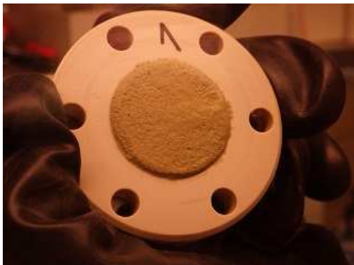
Obr. 11 Střední díl korozní cely č. 1 (40 °C) s kompaktním bentonitem, strana směrem k fritě
