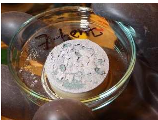
Obr. 35 Kompaktovaný bentonit z cely č. 7 (laboratorní teplota) po vyschnutí
