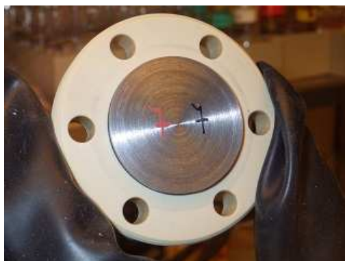
Obr. 28 Střední díl (vpravo) korozní cely č. 7 (laboratorní teplota) v okamžiku oddělení spodní části korozní cely (vlevo)
