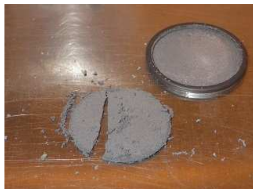
Obr. 30 Detail ocelového podkladového disku z cely č. 7 (laboratorní teplota) s odpadnutým práškovým železem
