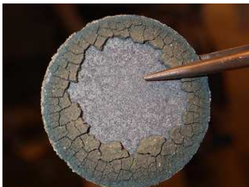
Obr. 33 „Sintrované“ práškové železo z cely č. 2 (70 °C) se zachyceným bentonitem
