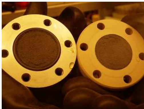
Obr. 16 Střední díl (vpravo) korozní cely č. 4 (laboratorní teplota) v okamžiku oddělení spodní části korozní cely (vlevo)
