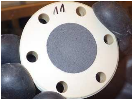
Obr. 25 Střední díl korozní cely č. 11 (40 °C) po oddělení ocelového podkladového disku, na bentonitu přítomna souvislá vrstva zachyceného práškového železa
