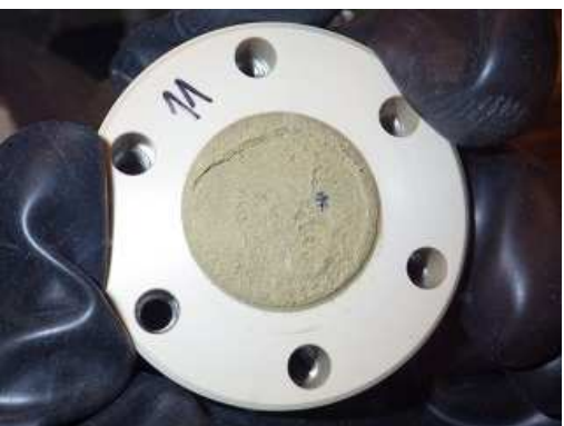
Obr. 23 Střední díl korozní cely č. 11 (40 °C) s kompaktním bentonitem, strana směrem k fritě
