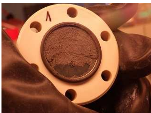
Obr. 13 Střední díl korozní cely č. 1 (40 °C) po oddělení ocelového podkladového disku, na bentonitu přítomna část zachyceného práškového železa
