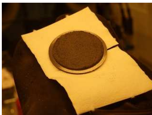
Obr. 18 Detail ocelového podkladového disku z cely č. 4 (laboratorní teplota) se zachyceným práškovým železem
