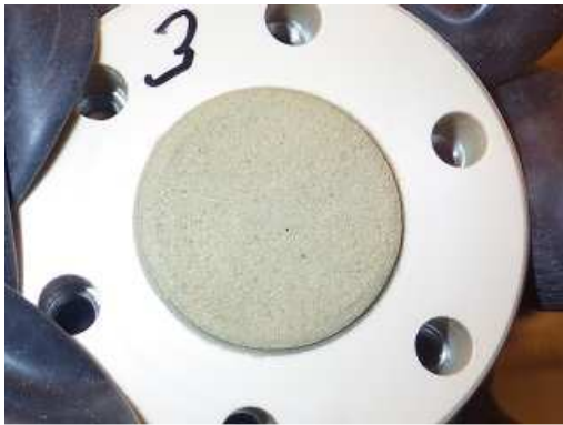
Obr. 19 Střední díl korozní cely č. 3 (70 °C) s kompaktním bentonitem, strana směrem k fritě
