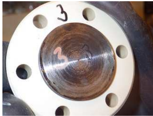
Obr. 20 Střední díl korozní cely č. 3 (70 °C) s pevně zachyceným podkladovým ocelovým diskem
