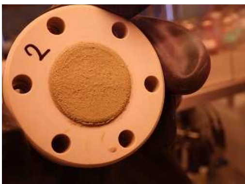
Obr. 7 Střední díl korozní cely č. 2 (70 °C) s kompaktovaným bentonitem, strana směrem k fritě
