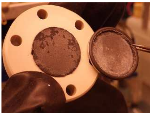
Obr. 9 Střední díl korozní cely č. 2 (70 °C) s po oddělení ocelového podkladového disku, na bentonitu přítomen pevně zachycený „sintrovaný“ práškový železo
