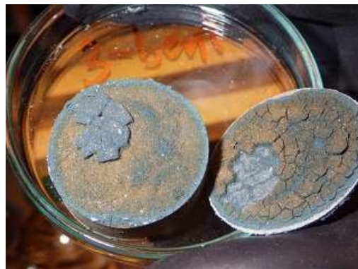
Obr. 38 Kompaktovaný bentonit a „sintrované“ práškové železo z cely č. 3 (70 °C). Na „sintru“ patrné výrazné tmavě zelené korozní/alterační produkty
