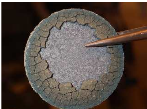
Obr. 33 „Sintované“ práškové železo z cely č. 2 (70 °C) se zachyceným bentonitem
