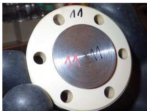
Obr. 24 Střední díl korozní cely č. 11 (40 °C) se zachyceným podkladovým ocelovým diskem
