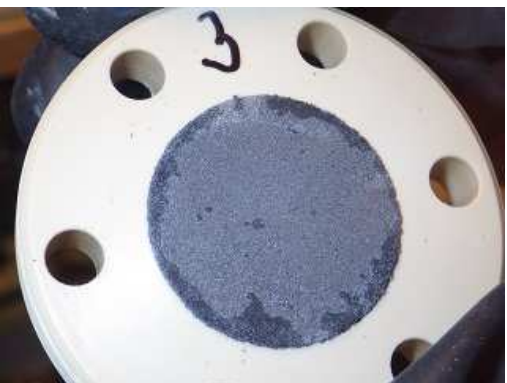
Obr. 21 Střední díl korozní cely č. 3 (70 °C) s po oddělení ocelového podkladového disku, na bentonitu přítomen pevně zachycený „sintrovaný“ práškové železo
