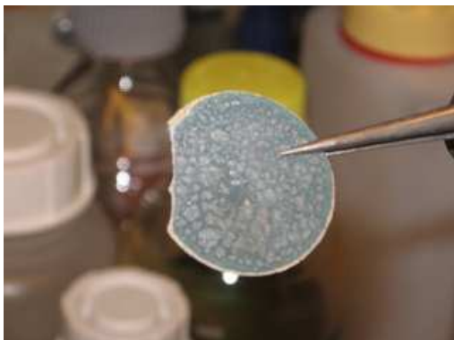
Obr. 39 „Sintrované“ práškové železo z cely č. 3 (70 °C), půlroční série
