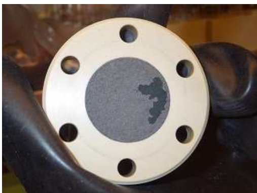
Obr. 29 Střední díl korozní cely č. 7 (laboratorní teplota) po oddělení ocelového podkladového disku, na bentonitu přítomna nesouvislá vrstva zachyceného práškového železa
