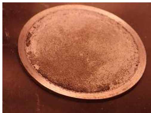
Obr. 10 Detail ocelového podkladového disku z cely č. 2 (70 °C) se zachyceným práškovým železem a korozními produkty
