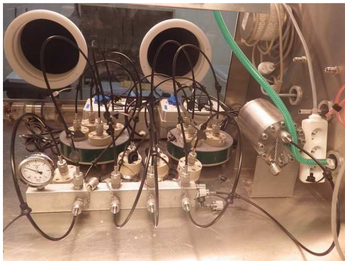
Obr. 5 Sestavná experimentální aparatura v rukavicovém boxu v průběhu sycení korozních cel
