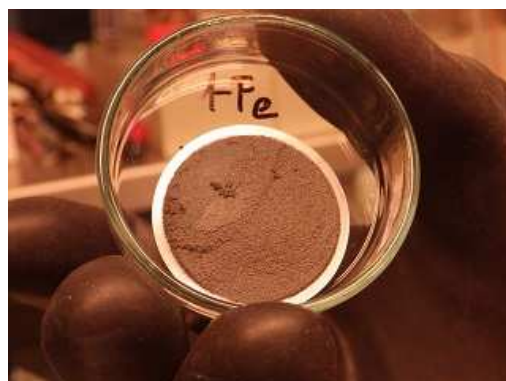
Obr. 14 Detail ocelového podkladového disku z cely č. 1 (40 °C) se zachyceným práškovým železem
