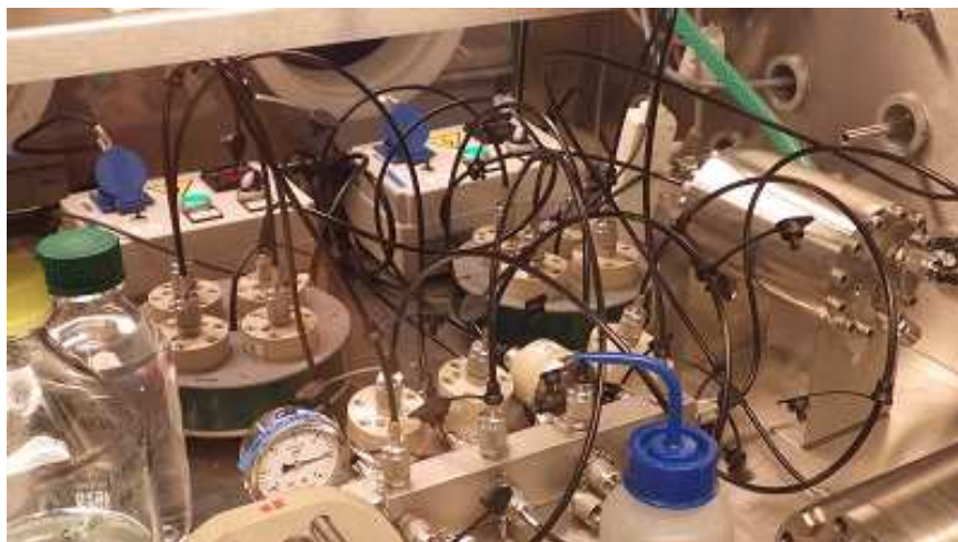
Obr. 6 Experimentální aparatura v rukavicovém boxu v průběhu experimentu za plného tlaku sytící kapaliny (5 MPa) a s vytápěním hnízd
