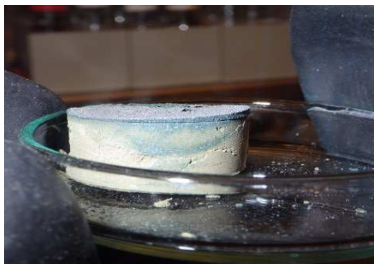
Obr. 34 Kompaktovaný bentonit z cely č. 1 (40 °C)
