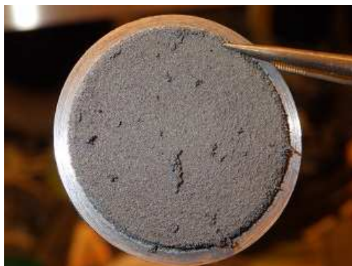
Obr. 26 Detail ocelového podkladového disku z cely č. 11 (40 °C) se zachyceným práškovým železem
