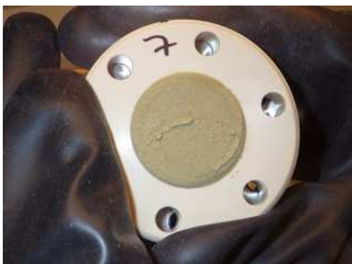
Obr. 27 Střední díl korozní cely č. 7 (laboratorní teplota) s kompaktním bentonitem, strana směrem k fritě
