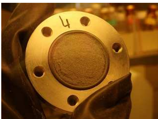
Obr. 17 Spodní díl korozní cely č. 1 (laboratorní teplota) po oddělení od bentonitu, prakticky veškerý objem práškového železa je zachycen na podkladovém ocelovém disku
