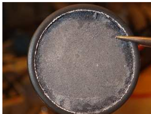
Obr. 22 Detail ocelového podkladového disku z cely č. 3 (70 °C) se zachyceným práškovým železem a korozními produkty
