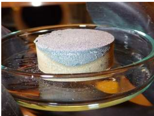
Obr. 37 Kompaktovaný bentonit z cely č. 11 (40 °C) po částečném mechanickém odstranění zachyceného práškového železa. Tmavě šedá vrstva na povrchu bentonitu představuje zbytky železa inkorporované do bentonitu. Na boku patrná reakční fronta (kontakt kompaktovaného bentonitu a stěny korozní cely)
