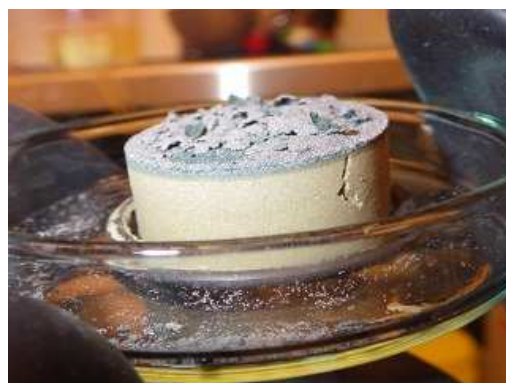
Obr. 36 Kompaktovaný bentonit z cely č. 7 (laboratorní teplota) po vyschnutí (pohled z boku)
