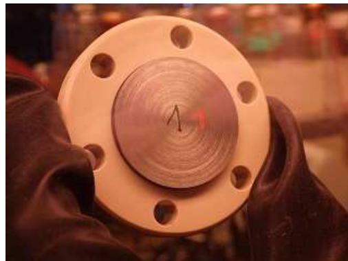
Obr. 12 Střední díl korozní cely č. 1 (40 °C) se zachyceným podkladovým ocelovým diskem
