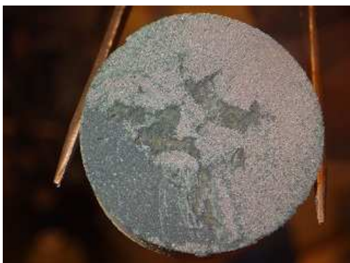
Obr. 31 Kompaktovaný bentonit z cely č. 1 (40 °C) po mechanickém odstranění zachyceného práškového železa. Tmavě šedá vrstva na povrchu bentonitu představuje zbytky železa inkorporované do bentonitu
