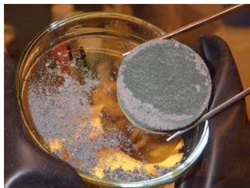
Obr. 32 Kompaktovaný bentonit z cely č. 4 (laboratorní teplota) po mechanickém odstranění zachyceného práškového železa. Tmavě šedé zbytky na okraji povrchu bentonitu představují železo inkorporované do bentonitu
