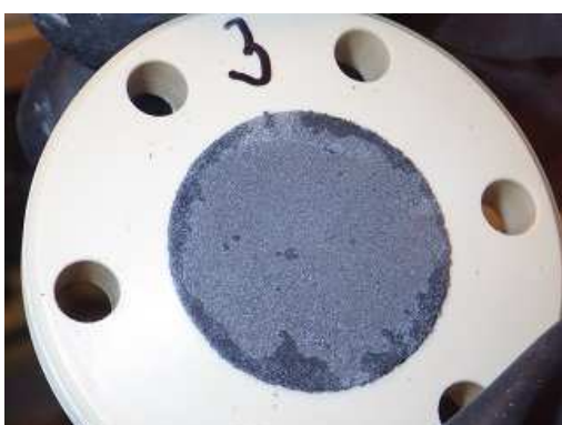
Obr. 21 Střední díl korozní cely č. 3 (70 °C) s po oddělení ocelového podkladového disku, na bentonitu přítomen pevně zachycený „sintrovaný“ práškový železo
