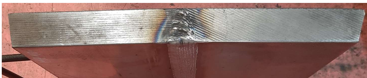
Obr. 60 – Vyhotovený vzorek svaru vnějšího obalu
