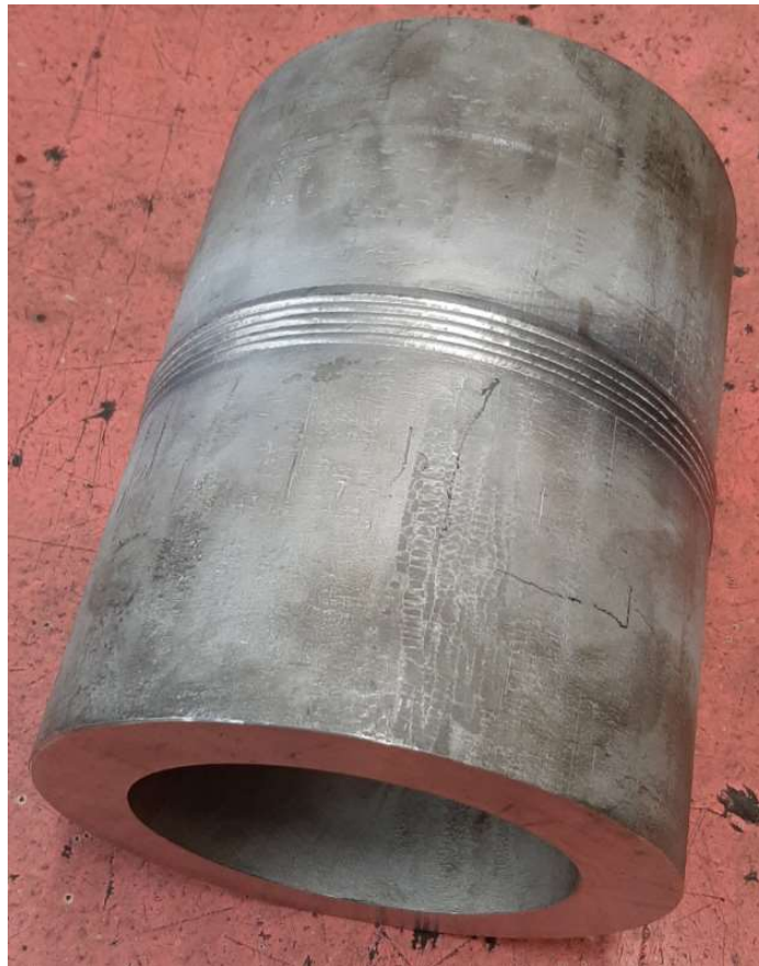
Obr. 63 – Vyhotovený vzorek svaru vnitřního pouzdra
