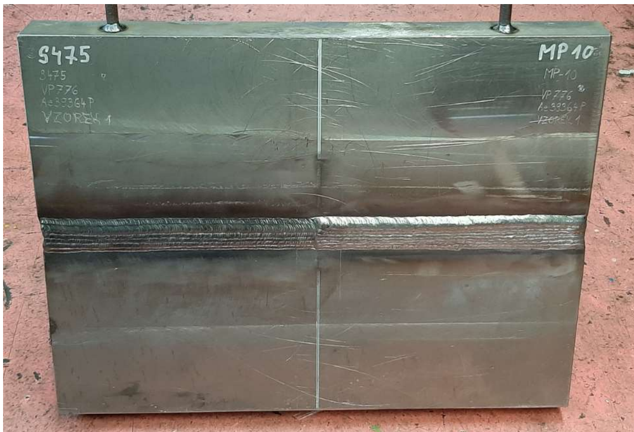
Obr. 60 – Vyhotovený vzorek svaru vnějšího obalu
