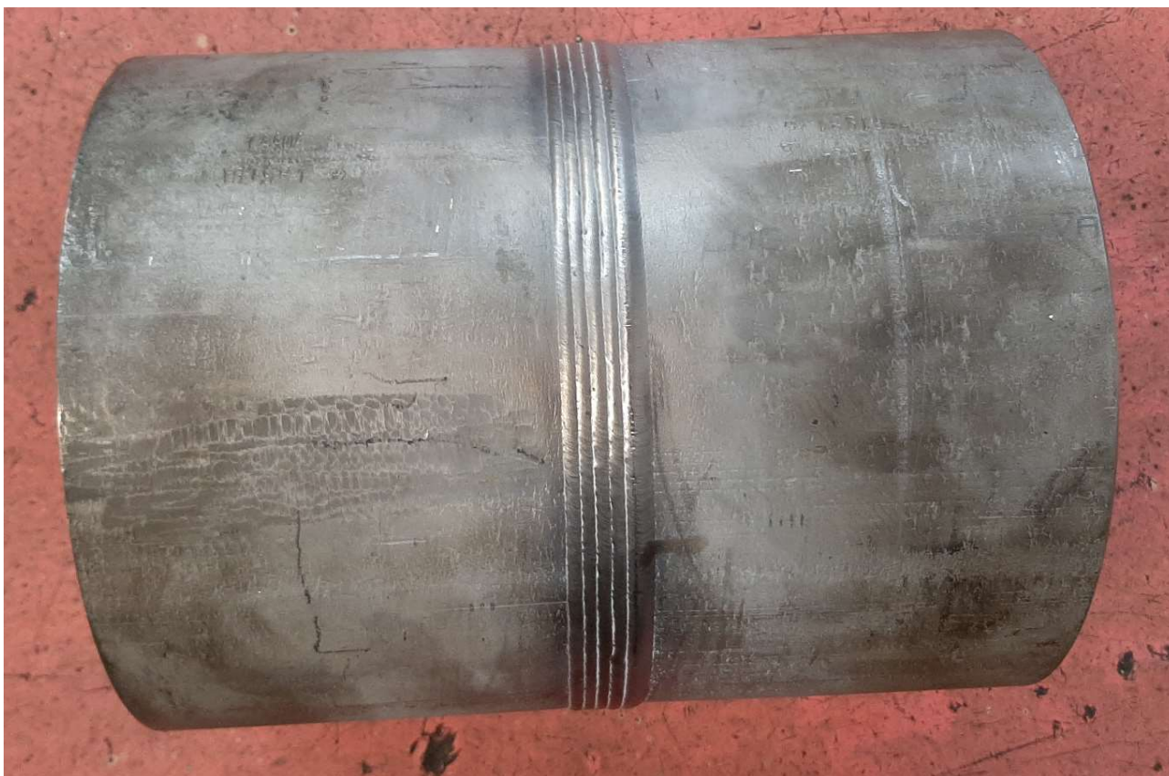
Obr. 62 – Vyhotovený vzorek svaru vnitřního pouzdra
