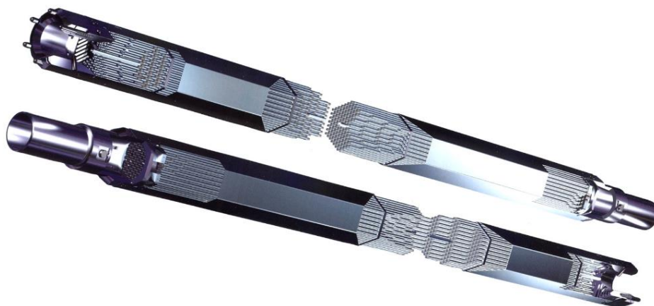
Obr. 1 Řez palivovým souborem používaným v EDU (Burket 2003)
