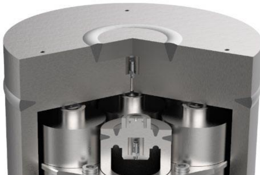
Obr. 4 Předpokládané konstrukční řešení vnějšího víka UOS
