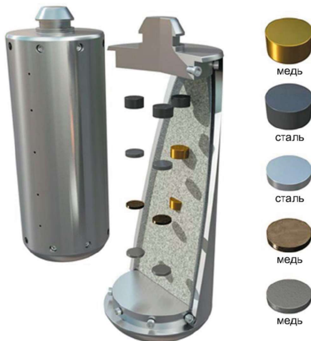
Рис. 8. Схема лабораторных экспериментов по взаимодействию на границе бентонит – материал металлической канистры с ВАО/ОЯТ
