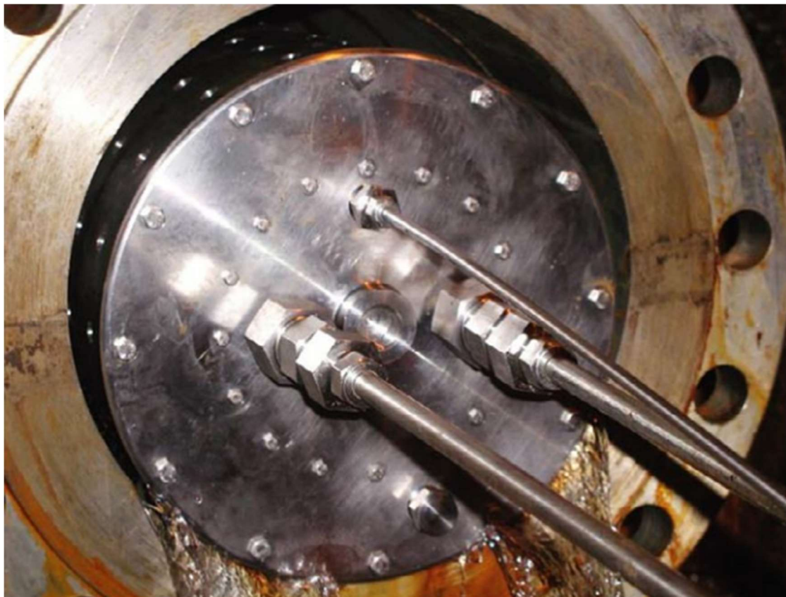
Obr. 20 Instalace experimentální aparatury do vrtů (Smart a Rance, 2009)
