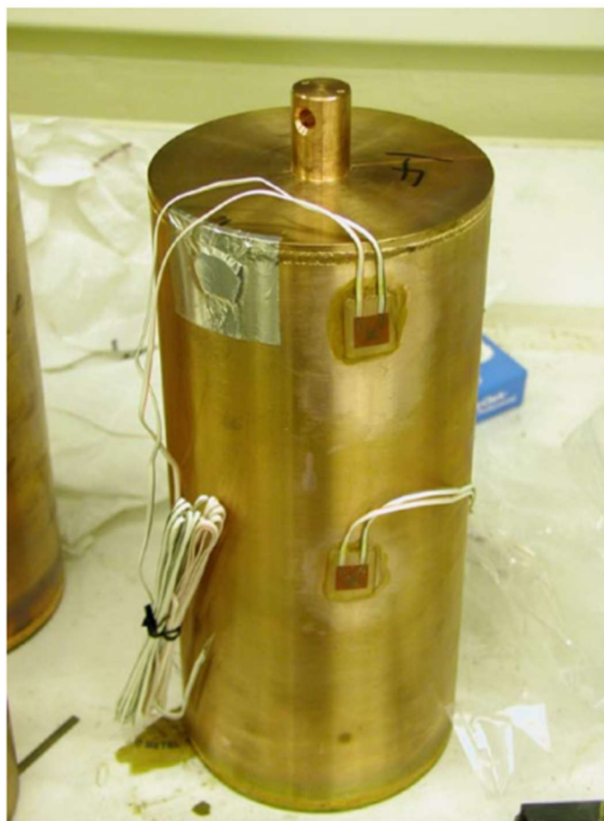
Obr. 23 Tenzometry na povrchu měděné trubky Minicanu (Smart a Rance, 2009)
