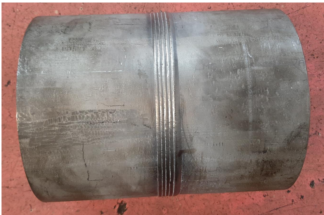
Obr. 62 – Vyhotovený vzorek svaru vnitřního pouzdra
