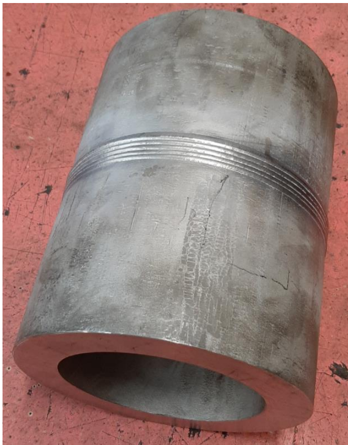
Obr. 63 – Vyhotovený vzorek svaru vnitřního pouzdra
