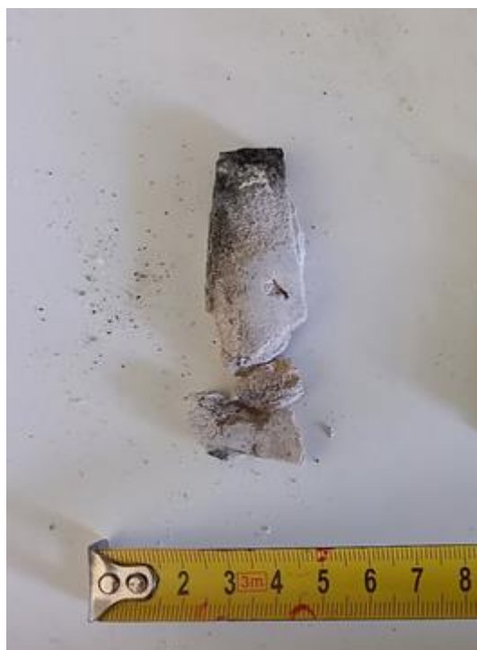
Obr. 4 Vzorek „sedimentu“, který byl podroben kyselému loužení.
