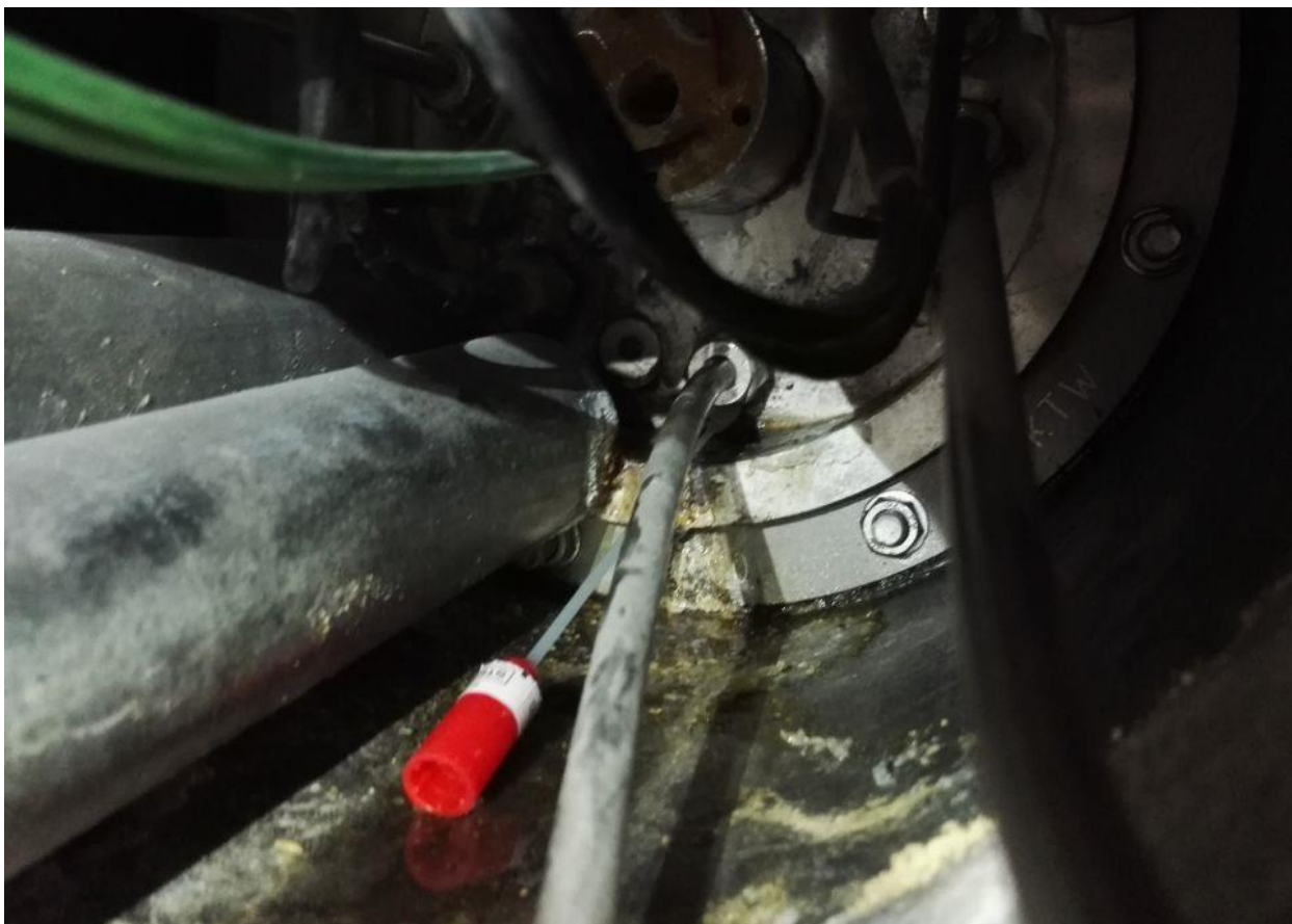
Obr. 24 Odběr stěru z instrumentace FM1 pro mikrobiologickou analýzu
