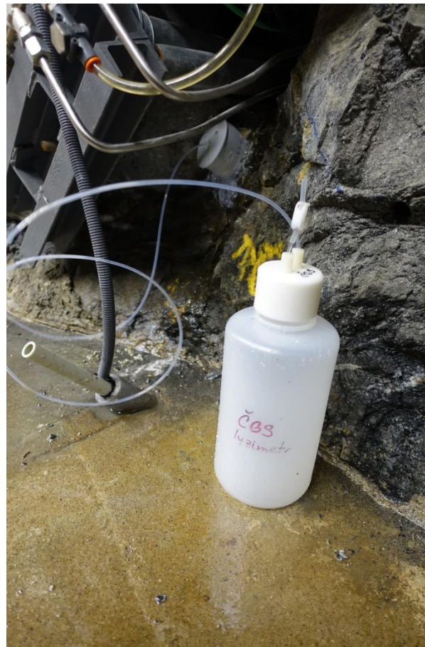
Obr. 13 Vrt FM1, osazení lyzimetru a jímací nádoba
