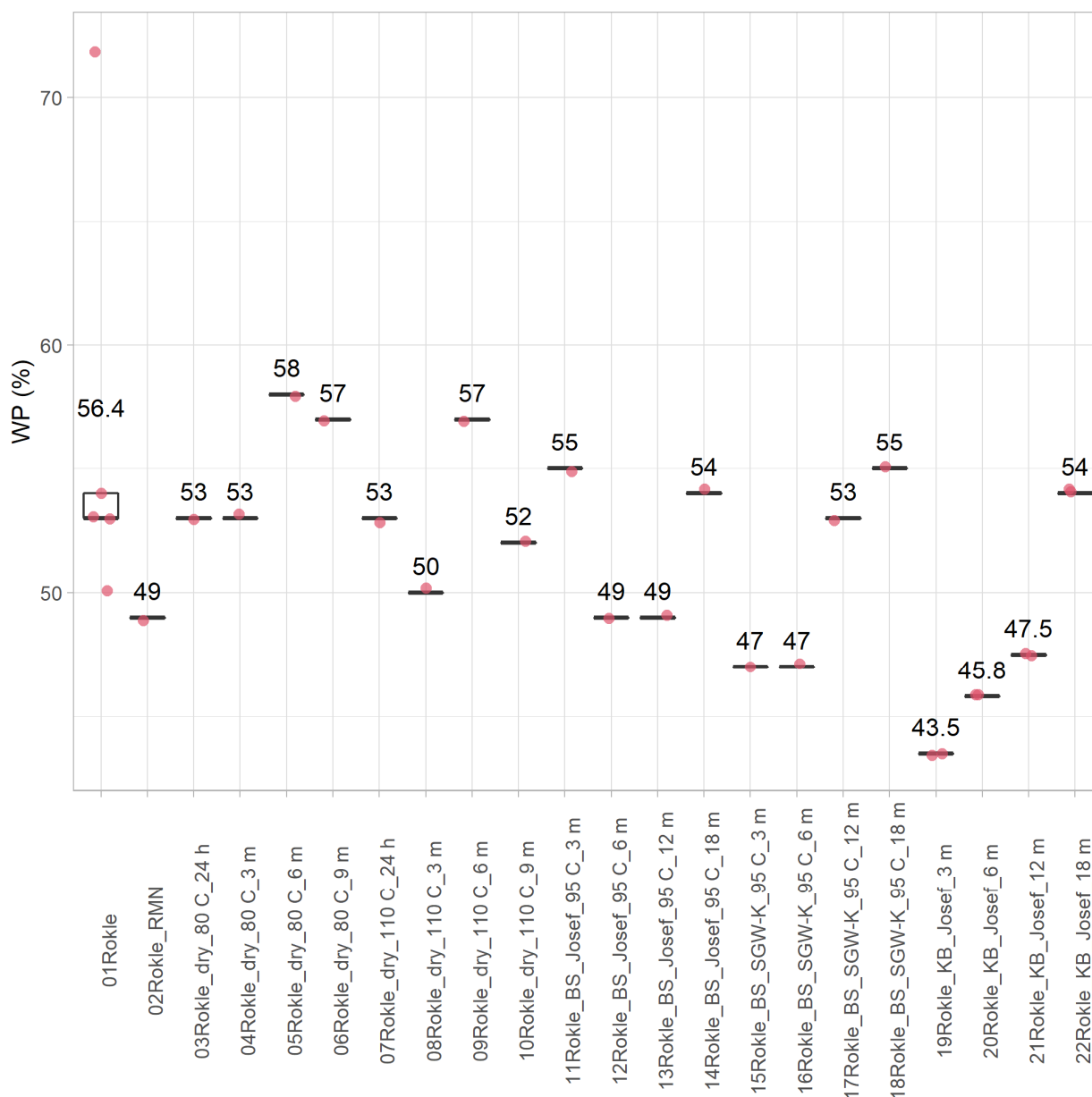
Obr. 65 Mez plasticity bentonitu Rokle_NS a Rokle_OS po krátkodobém (24 h) a dlouhodobém (3, 6, 9 měsíců) vystavení zvýšené teplotě (80 °C a 110 °C) v suchém stavu a mez plasticity bentonitu Rokle po zatížení teplotou 95 °C a současném vystavení vodě „Josef“, respektive „SGW-K“ po dobu 3, 6, 12 a 18 měsíců v nádobách a mez plasticity bentonitu Rokle umístěné v perforovaných patronách v podzemí po zatížení zvýšenou teplotou a vystavení vodě „Josef“.
