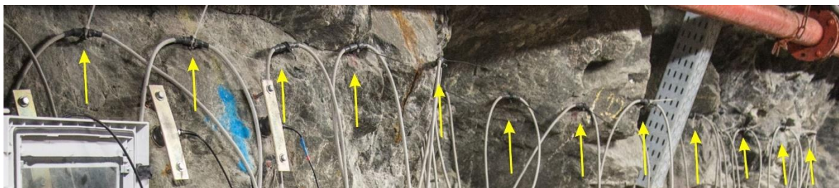
Obr. 5: Rozmístění elektrod pro elektrickou odporovou tomografii
