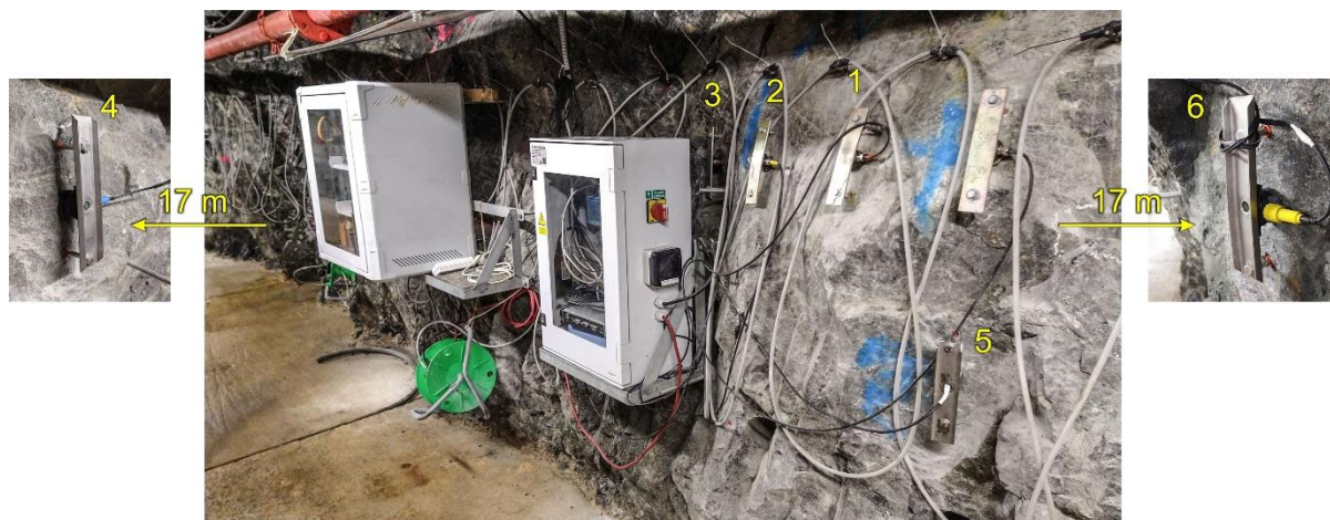
Obr. 10: Umístění čidel pro seismiku
