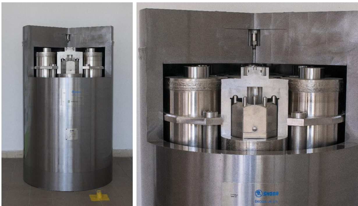
Obr. 3 - Vlevo: Fyzický model UOS pro VVER-440, vpravo: detail vnitřního prostoru UOS s vnitřními pouzdry a palivovým souborem
