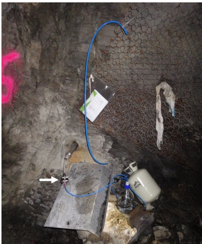
Obr. 5 Odběr vzorků vody pro mikrobiologické analýzy (vzorkovač označen šipkou) – vrt S-26
