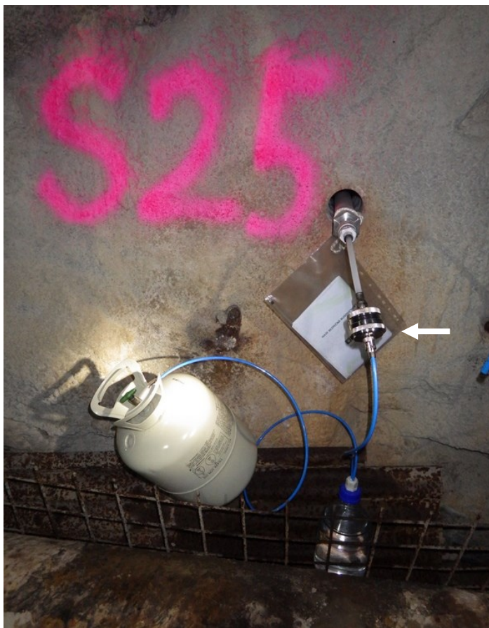
Obr. 4 Odběr vzorků vody pro mikrobiologické analýzy (vzorkovač označen šipkou) – vrt S-25
