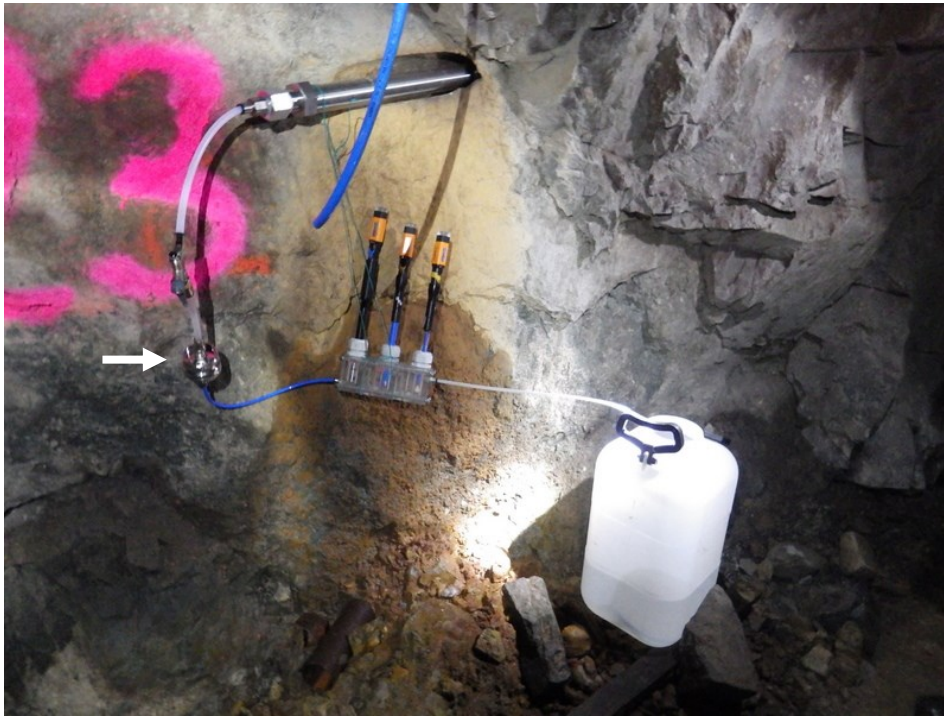
Obr. 3 Odběr vzorků vody pro mikrobiologické analýzy (vzorkovač označen šipkou) a paralelní hydrochemický monitoring – vrt S-23
