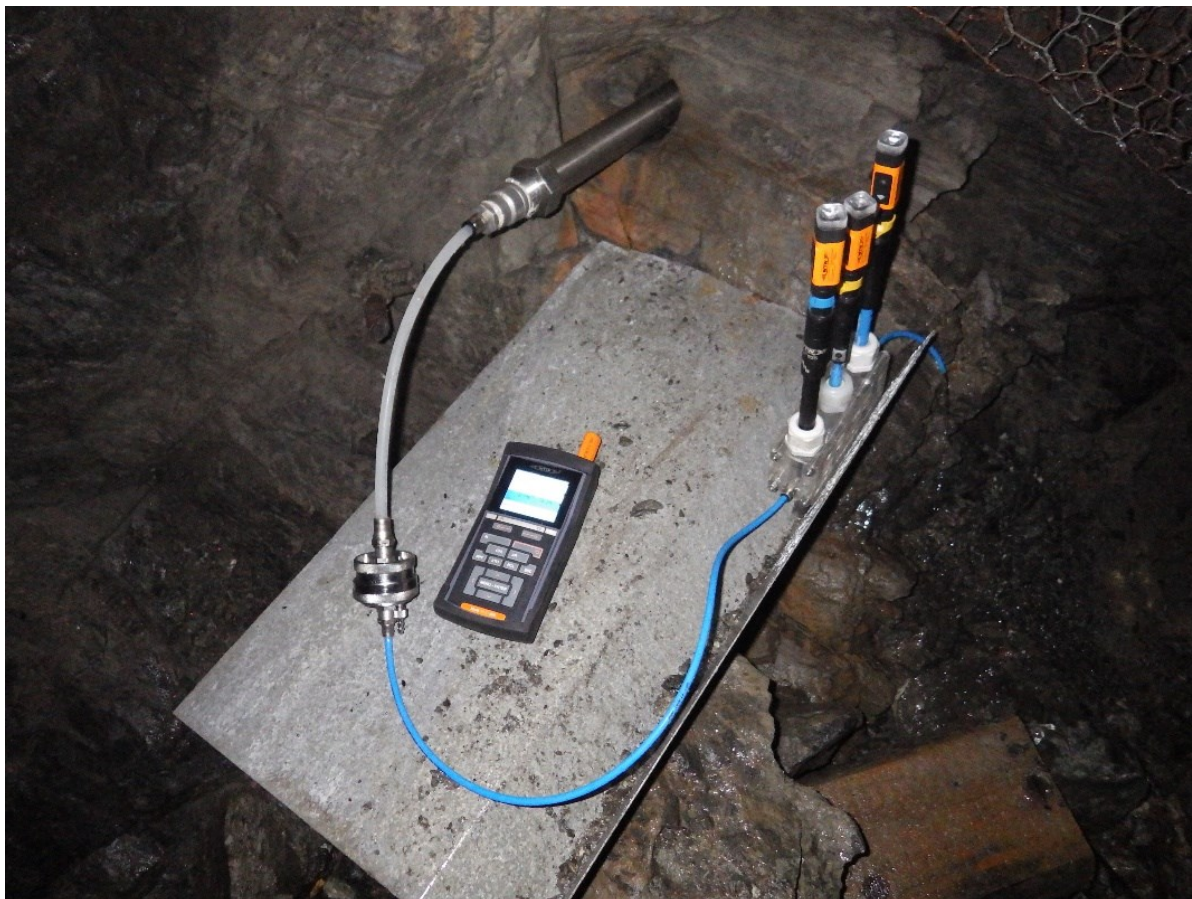
Obr. 7 Měření základních hydrochemických parametrů (teplota, pH, ORP, O 2 ) v průtočné cele
