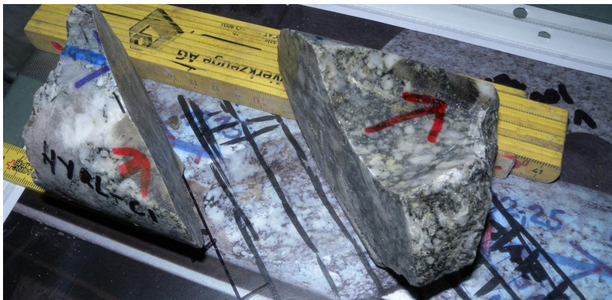
Obr. 31 Příklady odběru vzorků z vrtného jádra 17.004 pro HYRL
