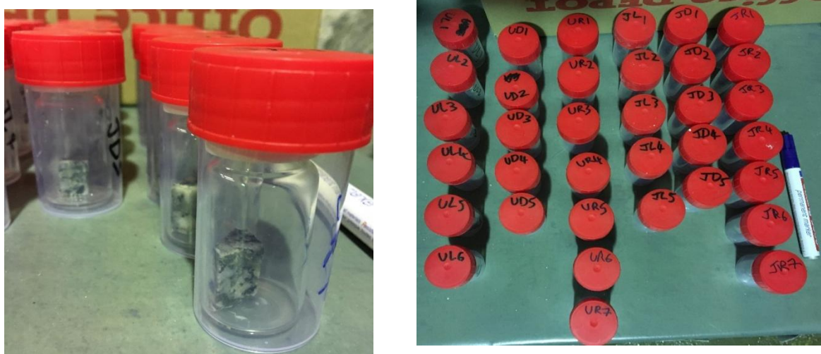
Obr. 31 Příklady odběru vzorků z vrtného jádra 17.004 pro HYRL
