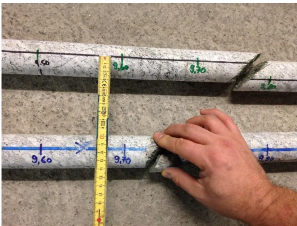
Obr. 4 Porovnání polohy puklin v jádrech z vrtu 10.001 a 12.001 s cílem zpřesnit informaci o vzdálenosti obou vrtů (Lanyon, 2015)
