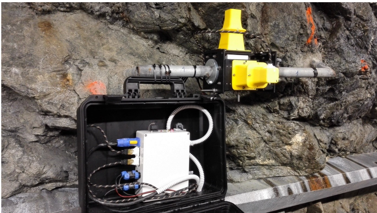
Obr. 1 Extenzometr 296GWB0001 v PVP Bukov osazený záznamníkem dat.
