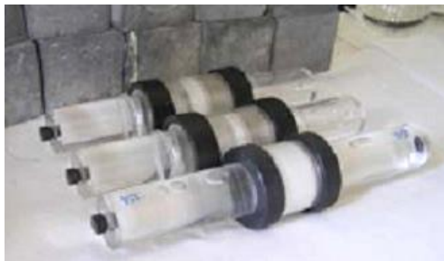
Obr. 158: Difúzní cely pro průnikové difúzní experimenty: vlevo původní design (2006), vpravo upravený design (ÚJV Řež, a. s. 2009)
