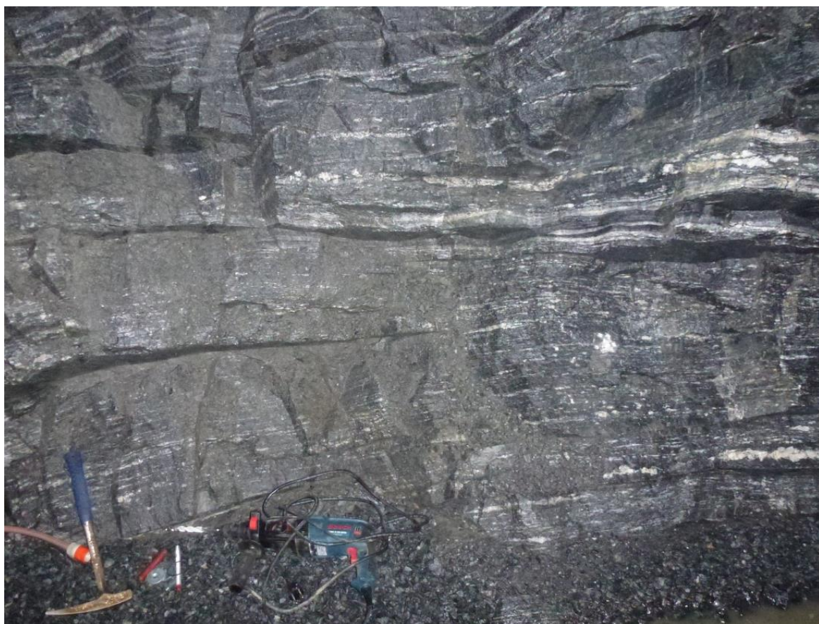
Obr. 43 Naložená subhorizontální metamorfní foliace v ZK-1, jižní stěna
