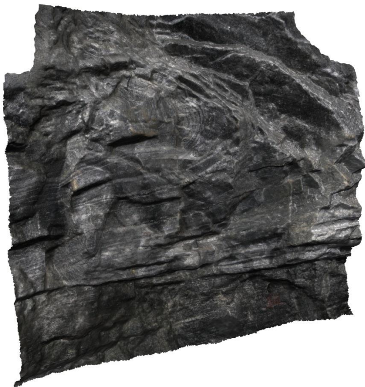
Obr. 46 3D vizualizace vrásové struktury v ZK-1, jižní stěna (spodní hrana cca 1,5 m)
