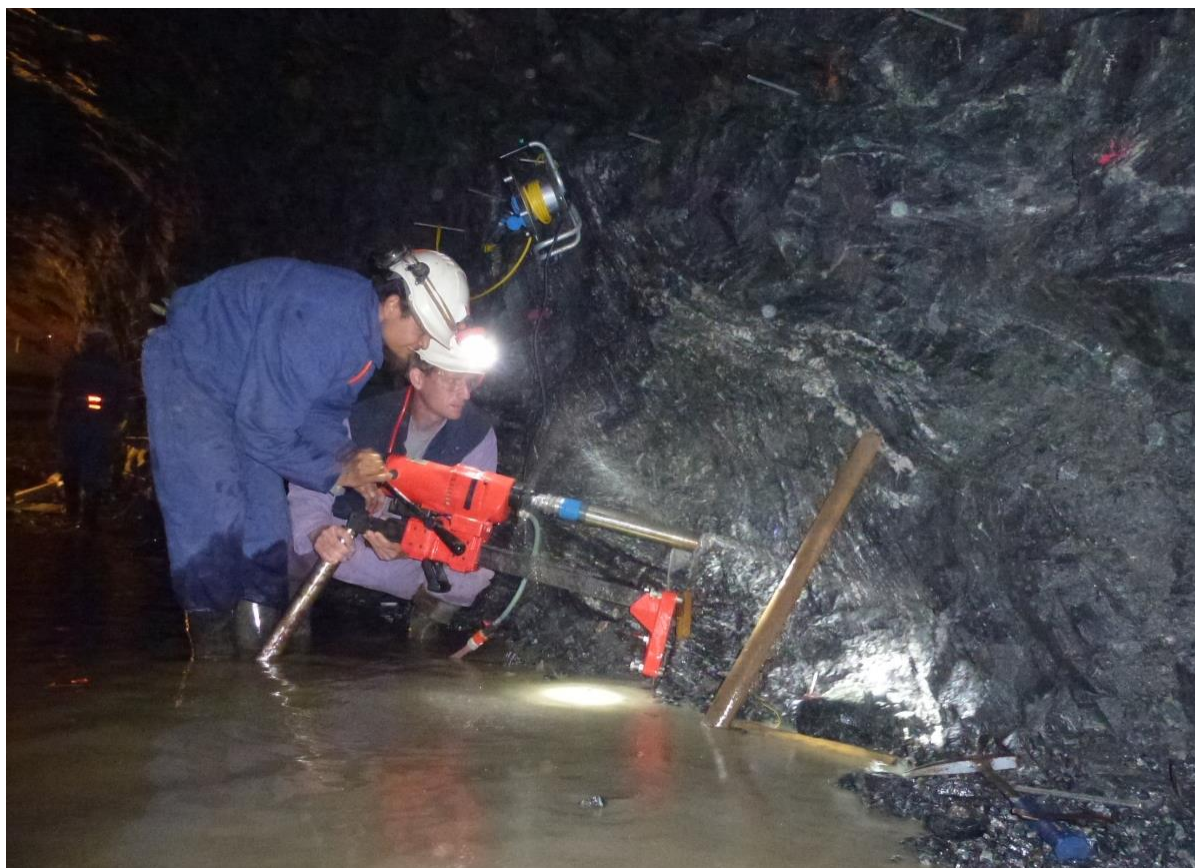
Obr. 57 Odběr jádra na analýzu AMS pomocí elektrické vrtačky v rozrážce ZK-1 (jižní stěna)
