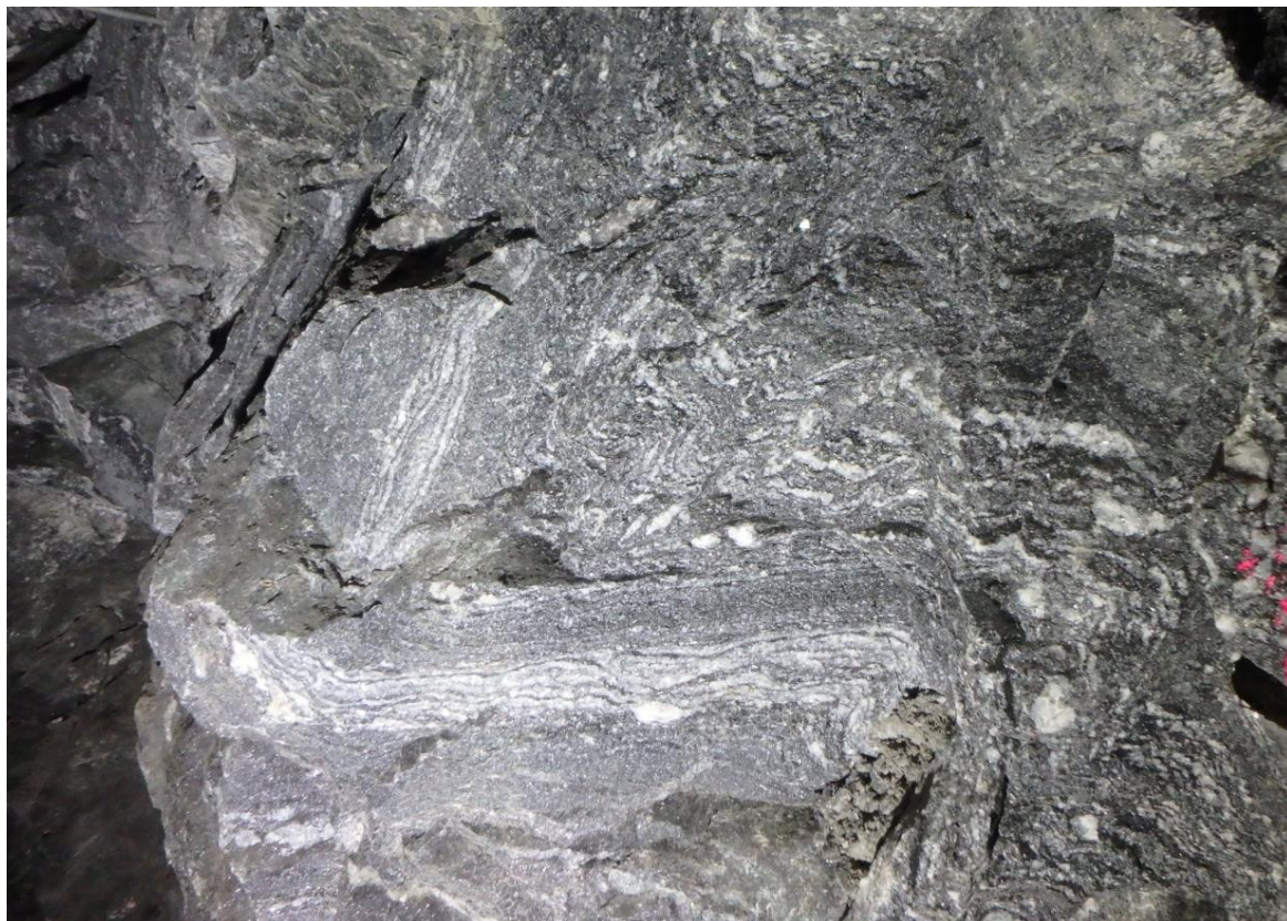
Obr. 45 Vrásavá struktura (ZK-1, severní stěna, spodní hrana fotky cca 20 cm)
