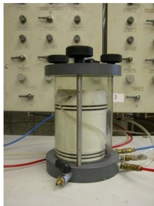
Obr. 168 Měřicí komora s udržováním plášťového tlaku (0–0,6 MPa)
