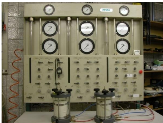
Obr. 167 Měření koeficientu hydraulické vodivosti vzorků po AMS (propustoměr firmy Infratest)
