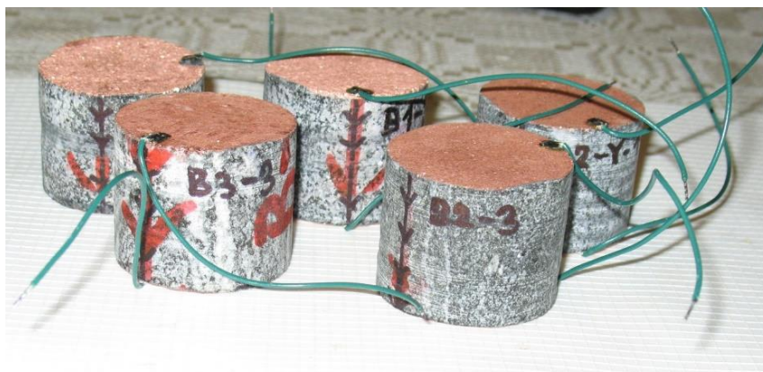
Obr. 65 Vzorky na měření rezistivity (elektrické konduktivity) s plazmaticky (Cu) upravenými čely jader
