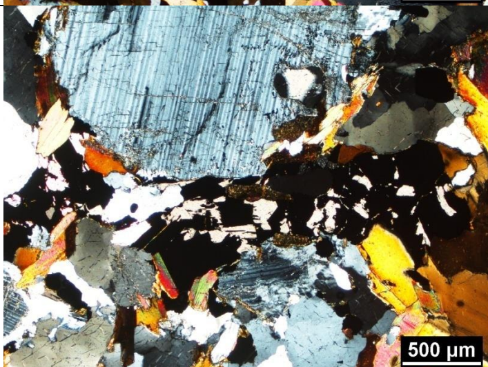
Zrna sulfidů srůstající s karbonátem na kontaktu s plagioklasem
