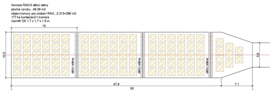
Obr. 14 Komora RAO s dělicí stěnou
